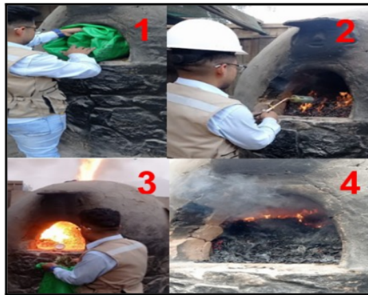
Figura 7. Proceso de calcinación de las hojas de coca Fuente: Propia
