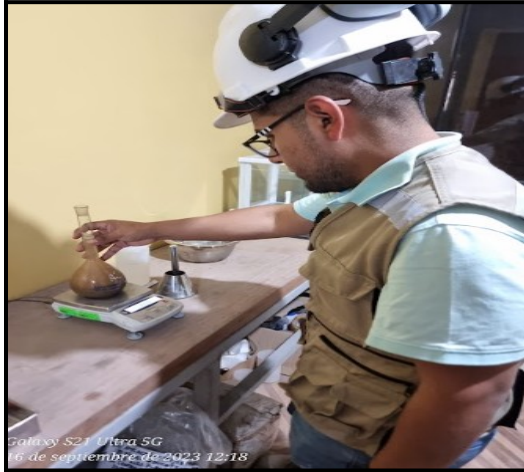
Fotografía 7. Gravedad específica y absorción del agregado fino
