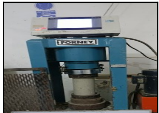
Fotografía 12. Ensayo de compresión concreto (7 días)
