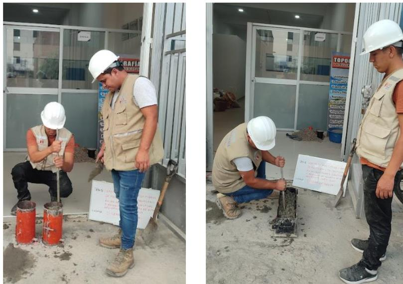
Figura 14. Fabricación de probetas cilíndricas y prismáticas
