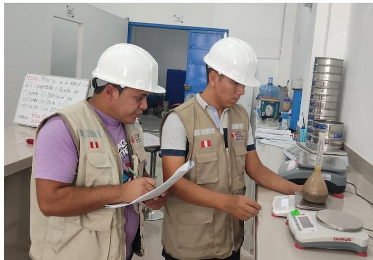
Figura 10. Ensayo de peso específico del agregado fino: Pesado del picnómetro con muestra y agua
