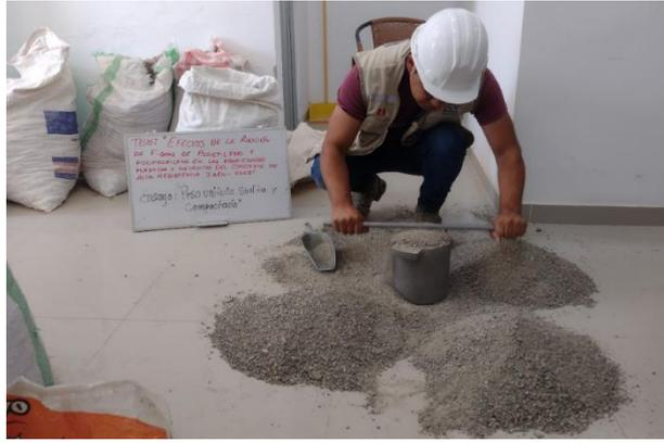
Figura 06. Ensayo de peso unitario suelto
