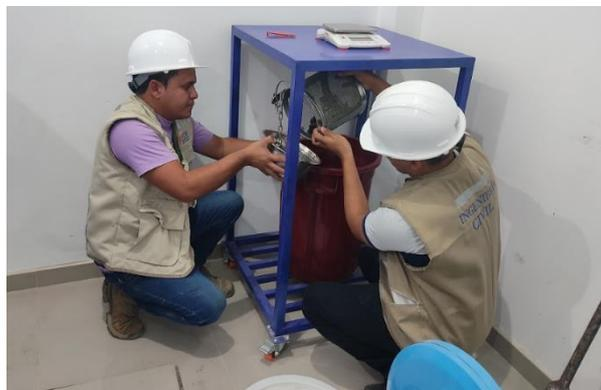
*Figura 08.* Ensayo de peso específico del agregado grueso
