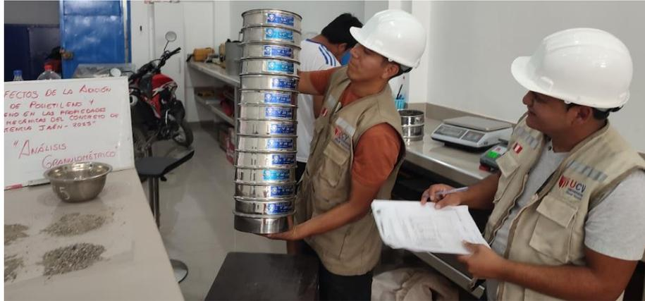
Figura 05. Ensayo de granulometría
