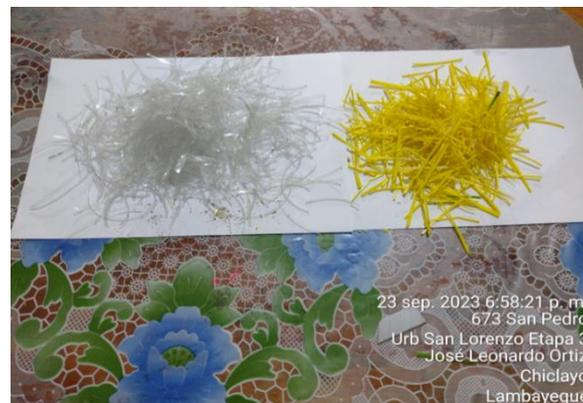
*Figura 03.* Fibras de polietileno (PET) y polipropileno
