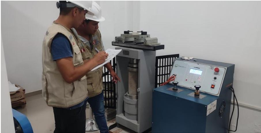
*Figura 18.* Ensayo de resistencia a la compresión axial
