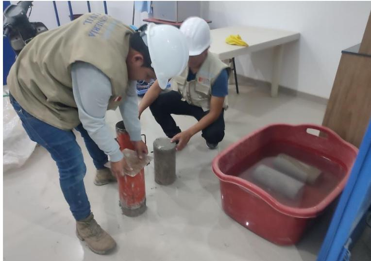
*Figura 15. Curado de probetas de concreto*
