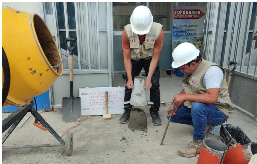
Figura 16. Ensayo de asentamiento con el cono de Abrams
