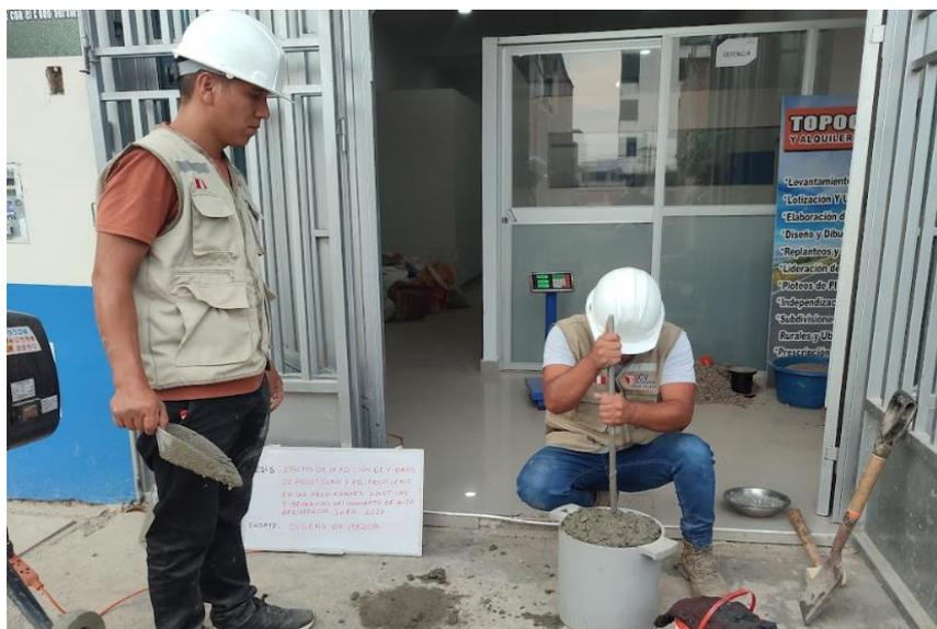
Figura 17. Ensayo de peso unitario del concreto fresco
