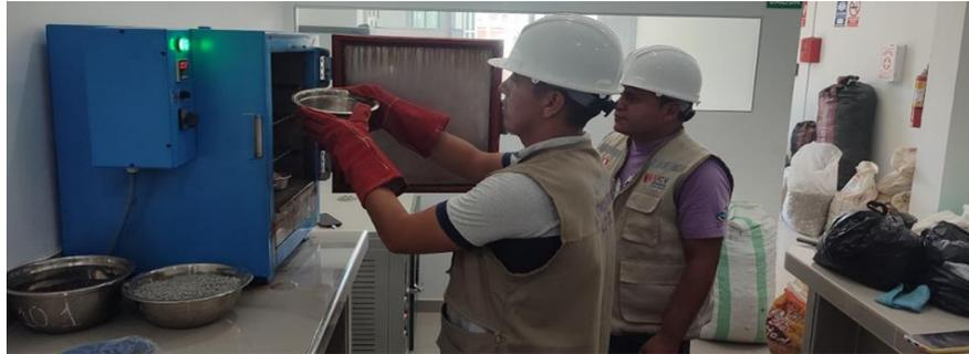
Figura 04. Ensayo de contenido de humedad
