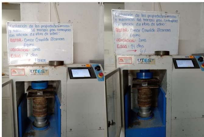
Figura 10. Prueba de resistencia a la compresión de 7 y 14 días. P y M3
