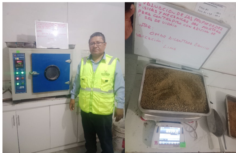
Figura 4. Izquierda: Secado al horno. Derecho: Peso del agregado fino
