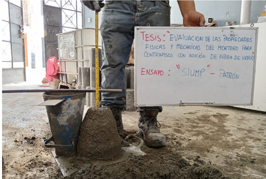
Figura 8. Prueba de asentamiento en P
