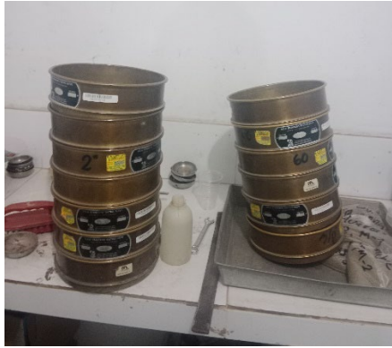
Figura 3. Tamices usados en el análisis granulométrico
