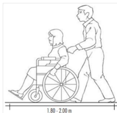
**Figura 08** Medidas para el desplazamiento de una silla de ruedas.
