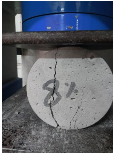
Ensayo de tracción de probetas con adición de 8% de bacteria bacillus subtilis.
