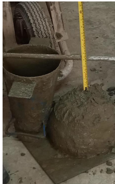
Se realizo el slump del concreto patrón f'c= 210\text{kg/cm}^2 con adición 8% de Bacteria Bacillus Subtilis
