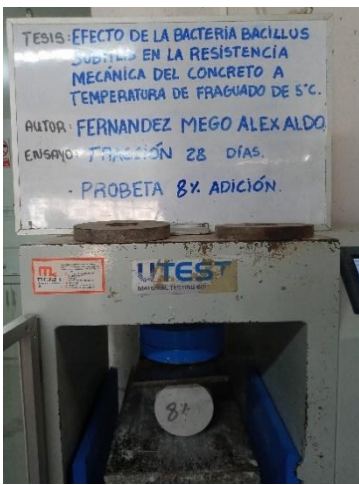
Ensayo de tracción de probetas con adición de 8% de bacteria bacillus subtilis.
