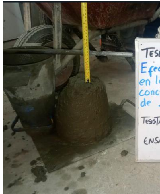
Se realizo el slump del concreto patrón f'c= 210\text{kg/cm}^2
