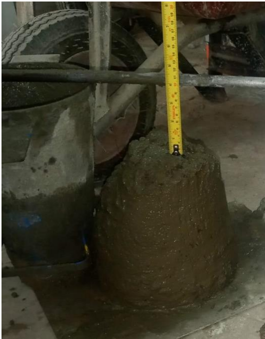
Se realizo el slump del concreto patrón f'c= 210\text{kg/cm}^2
