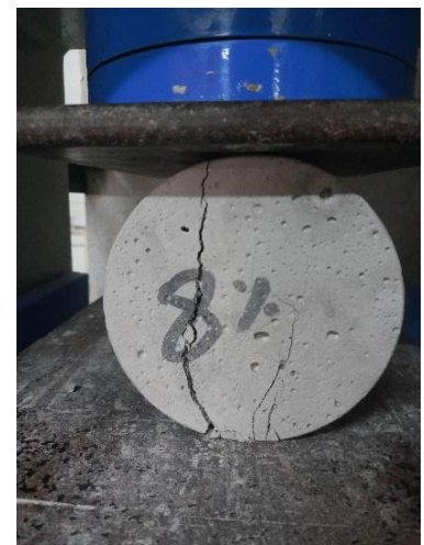
Ensayo de tracción de probetas con adición de 8% de bacteria bacillus subtilis.
