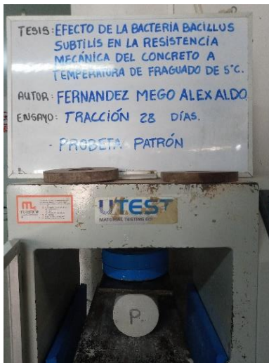
Ensayo de tracción de probetas patrón 28 días
