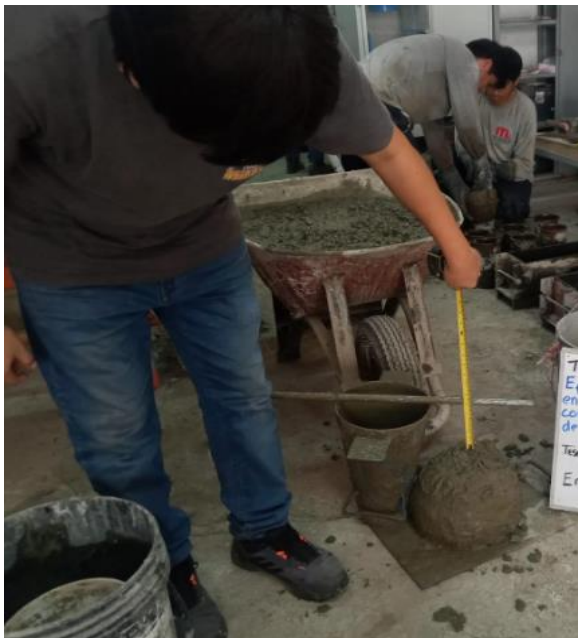
Se realizo el slump del concreto patrón f'c= 210\text{kg/cm}^2 con adición 8% de Bacteria Bacillus Subtilis
