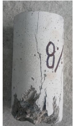
Ensayo de compresión probetas con adición de 8% de bacteria bacillus subtilis.
