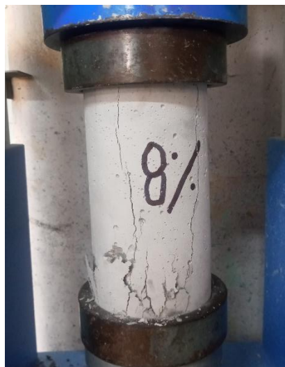
Ensayo de compresión probetas con adición de 8% de bacteria bacillus subtilis.
