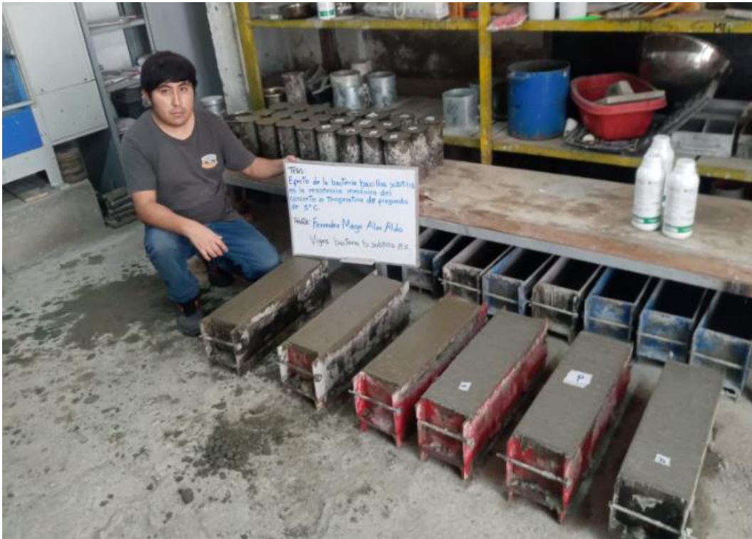
Se realizó la elaboración de vigas de concreto de diseño patrón f'c= 210\text{kg/cm}^2 con adición 8% de Bacteria Bacillus Subtilis – para el ensayo de flexión
