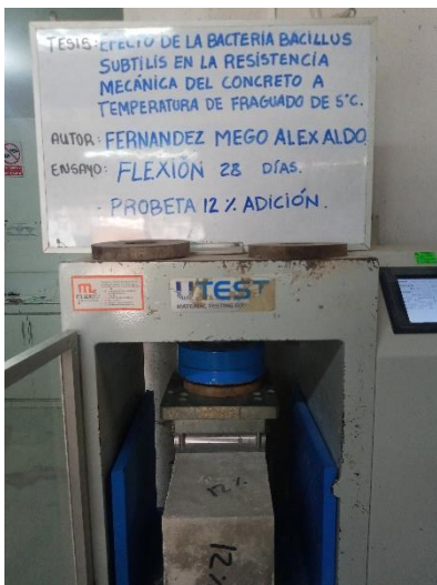
Ensayo de flexión de vigas patrón y de vigas con adición de bacterias (8% y 12%) a los 28 días.
