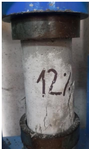
Ensayo de compresión de probetas con 12% de edición de bacteria bacillus subtilis.
