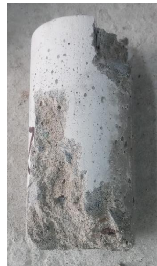
Ensayo de compresión de probetas con 12% de edición de bacteria bacillus subtilis.
