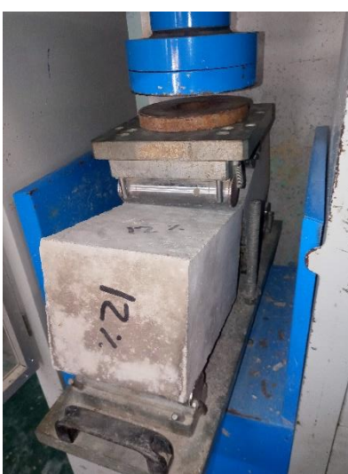
Ensayo de flexión de vigas patrón y de vigas con adición de bacterias (8% y 12%) a los 28 días.
