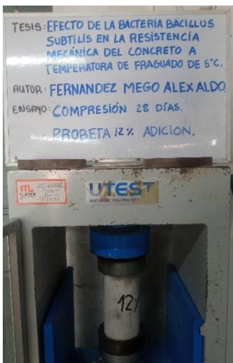
Ensayo de compresión de probetas con 12% de edición de bacteria bacillus subtilis.
