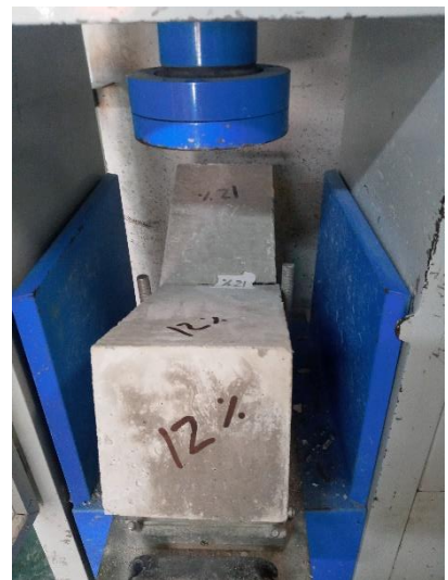
Ensayo de flexión de vigas patrón y de vigas con adición de bacterias (8% y 12%) a los 28 días.
