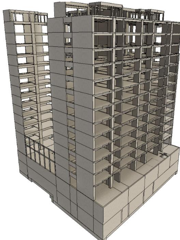
Figura 16. Modelado BIM 3D de estructuras.
