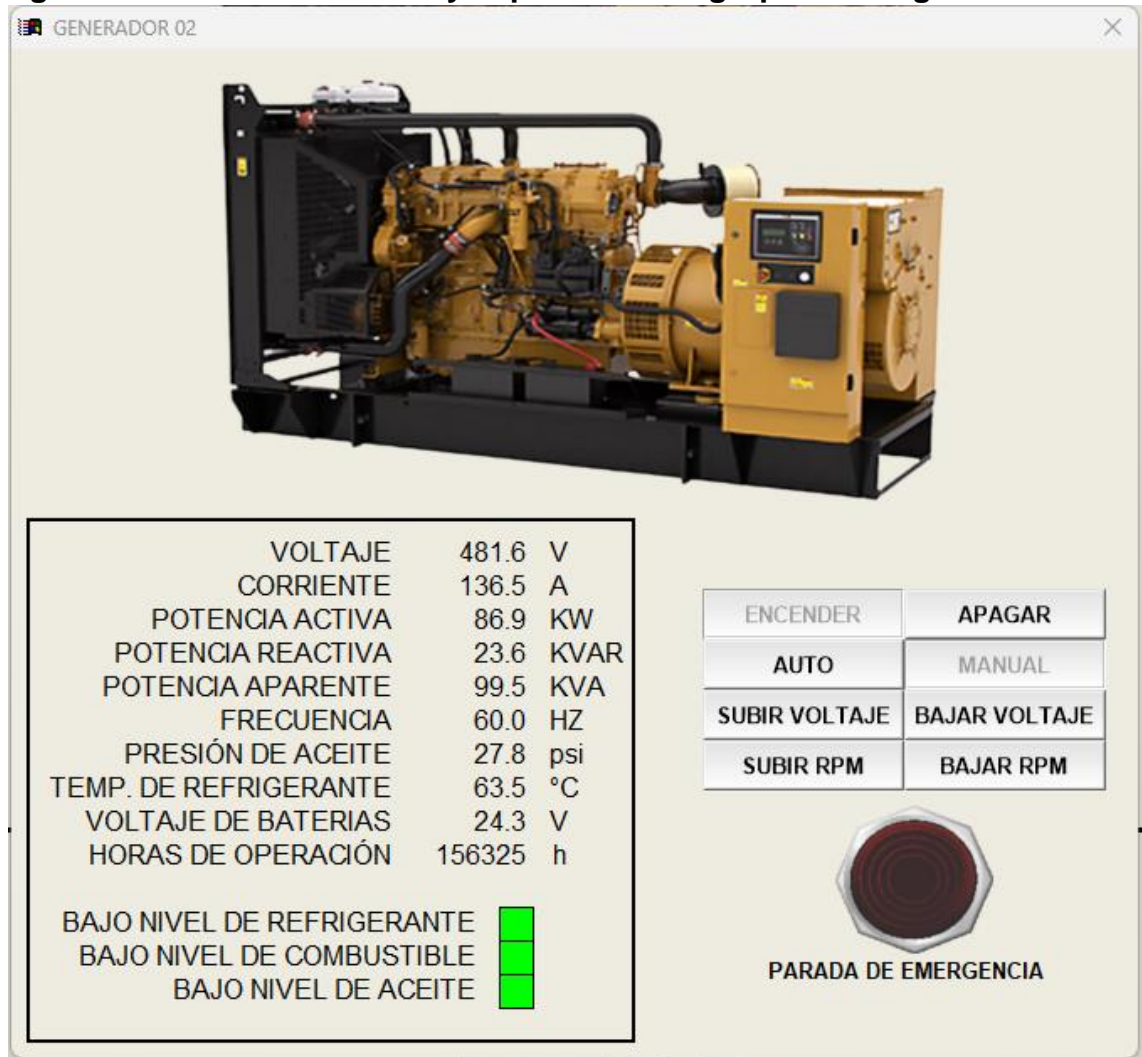
Figura 17. Interfaz de control y supervisión de grupo electrógeno 2
