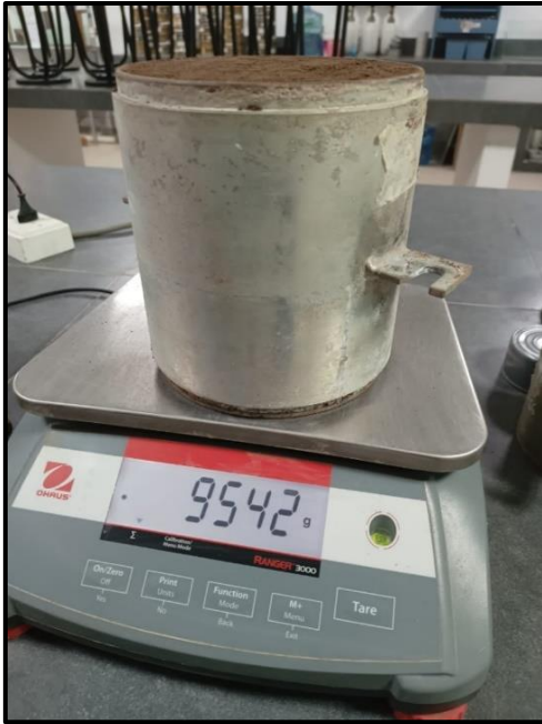
Panel fotográfico N°16: Peso de la muestra del suelo para la prueba CBR.
