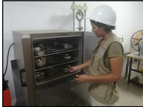
Panel fotográfico N°13: Ensayo de contenido de humedad.
