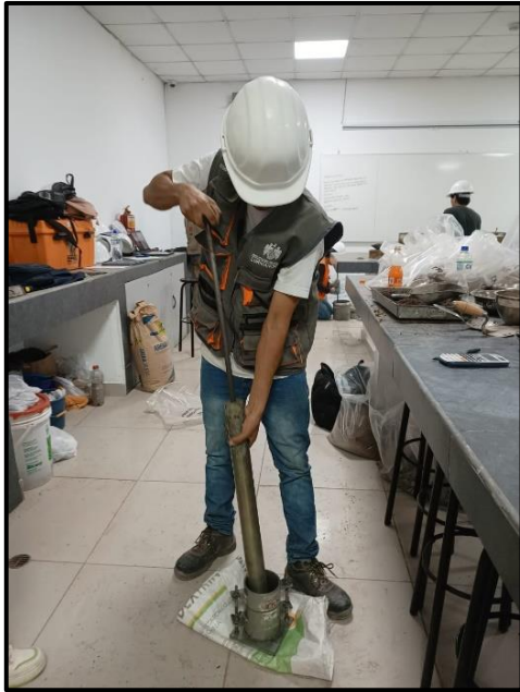
Panel fotográfico N°12: Ensayo de Proctor modificado del suelo natural
