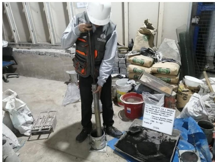
Figura 53. Ensayo de CBR (Dosificación 6)
