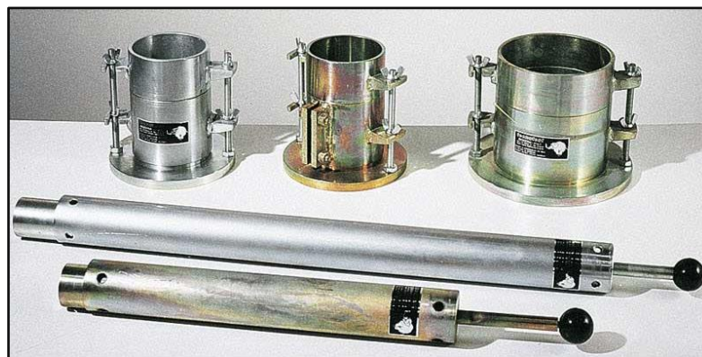
Figura 5. Equipos del ensayo de compactación.
