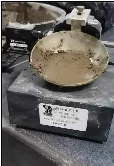
Panel fotográfico N°10: Ensayo de límites de atterberg
