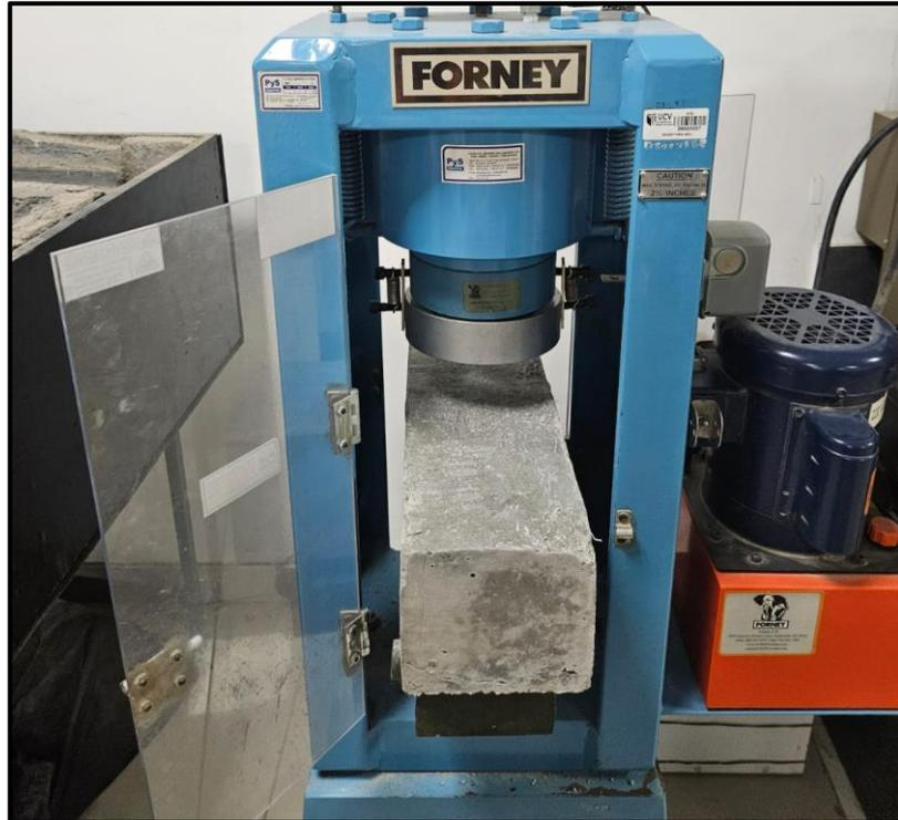
Foto 13: ensayo de resistencia a la flexión
