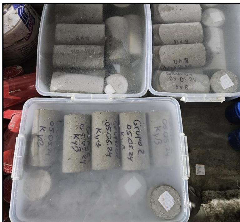
Foto 8: Curado de probetas 7, 14 y 28 días
