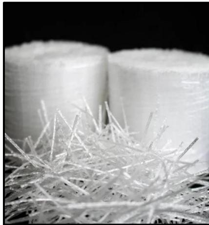
Figura 2. Fibras de Polipropileno, obtenido de Fibras Cortadas y Monofilamentos SAC. Tomado por “Joel Baldoxeda”.
