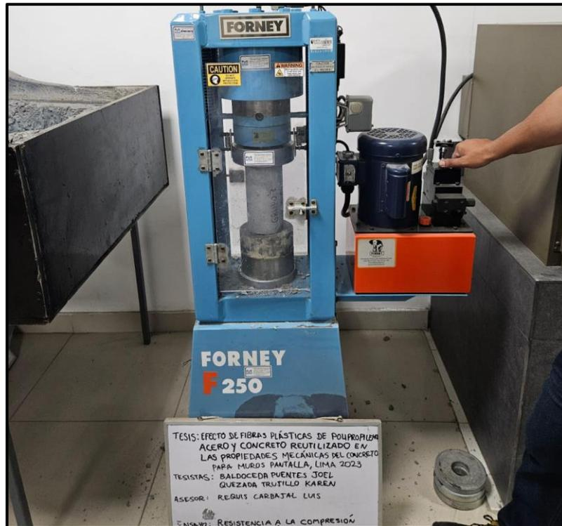
Foto 9: ensayo de resistencia a la compresión
