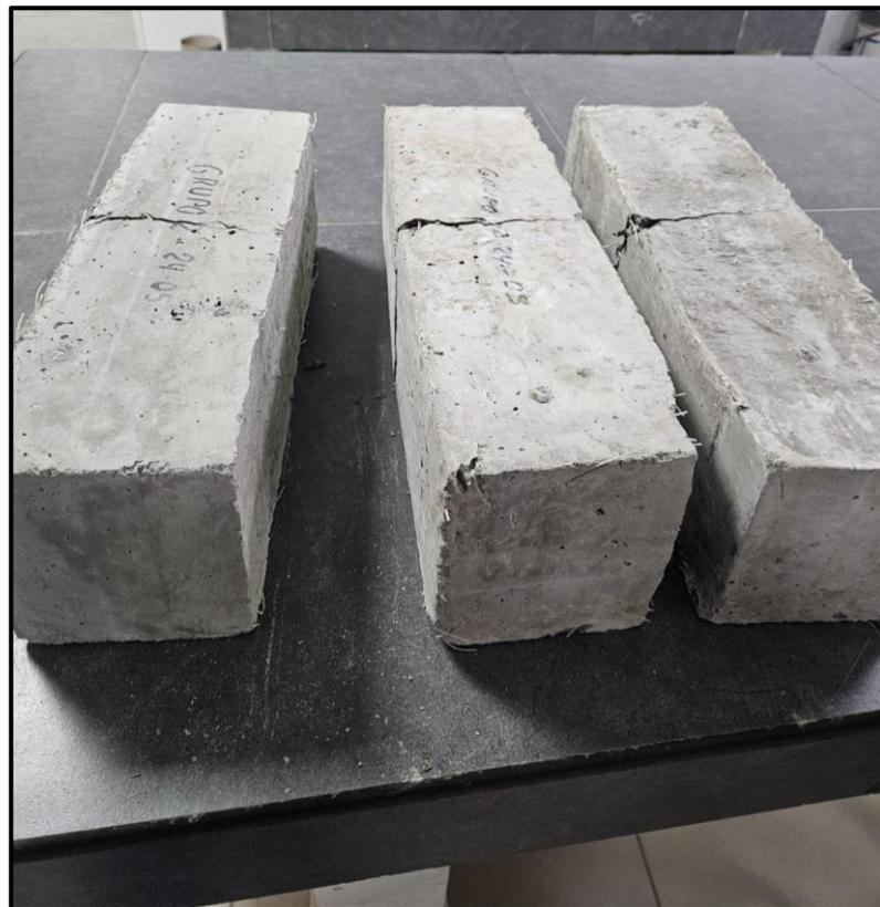
Foto 14: Vigas roturadas por flexión
