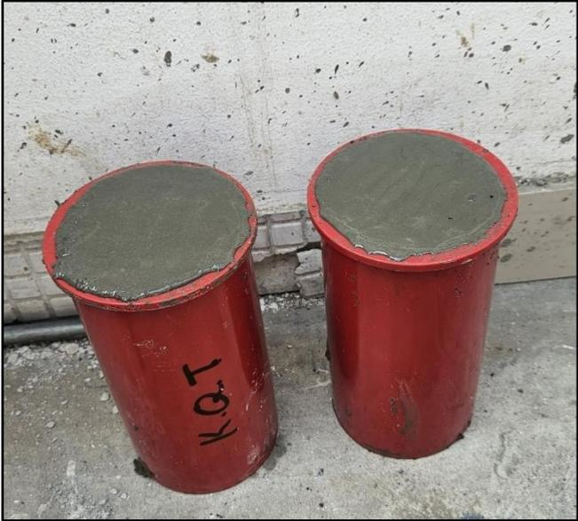
Figura 25. Probetas con concreto patrón
