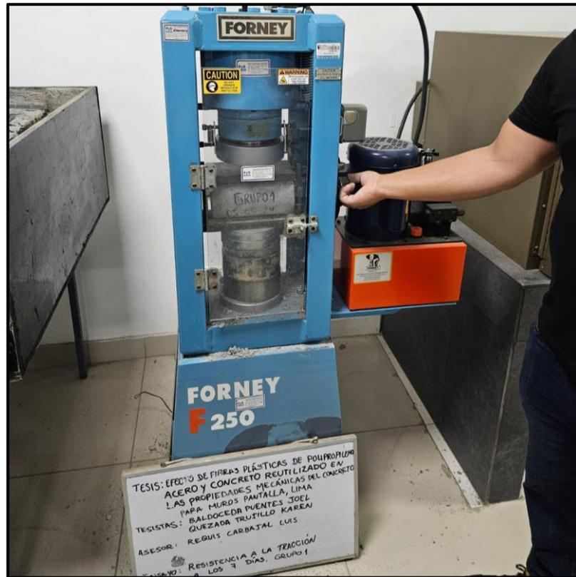
Foto 11: Ensayo de resistencia a la tracción
