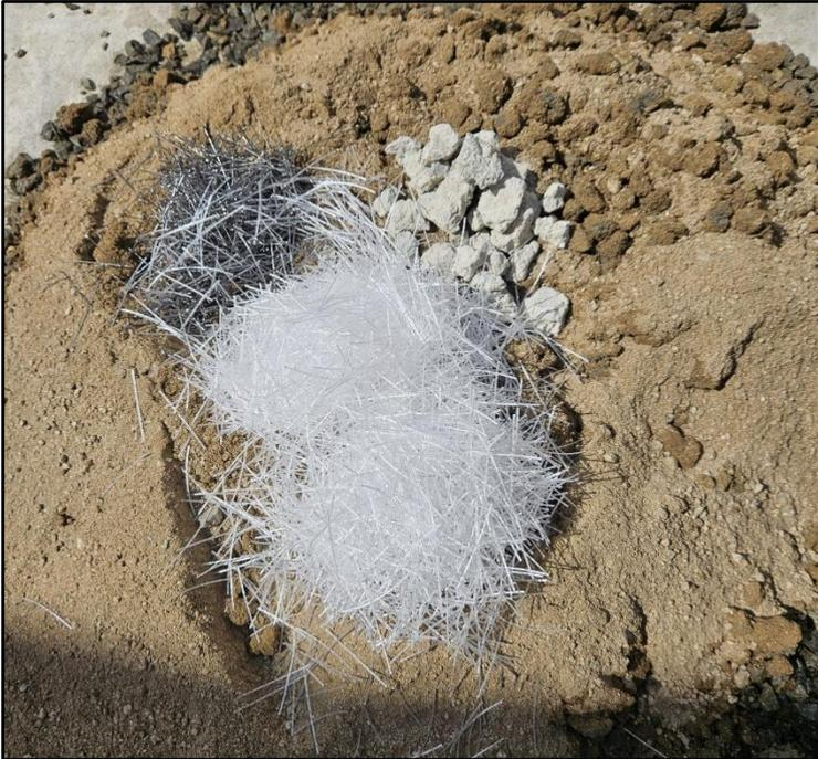
Figura 26. Materiales para mezcla del grupo experimental 1
