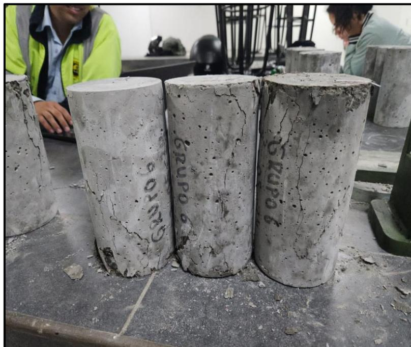
Foto 10: probetas roturadas por compresión
