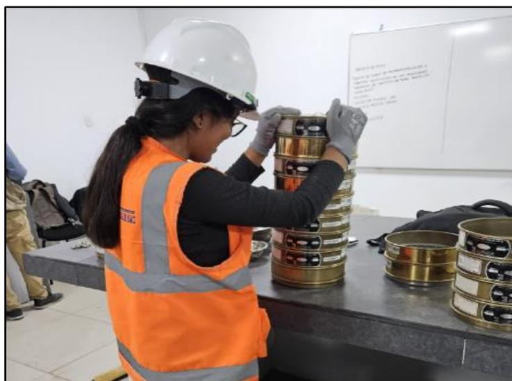
Figura 14. Tamizado de la muestra
