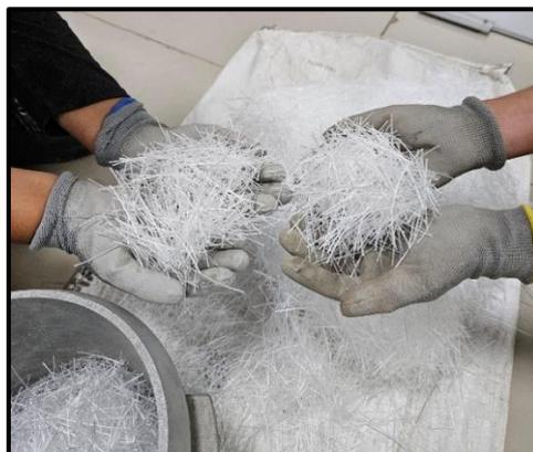
Figura 1. Fibras de Polipropileno, Tomada por “Karen Quezada”
