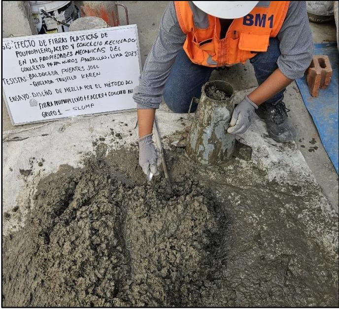
Figura 29. Ensayo de consistencia de grupo experimental 1
