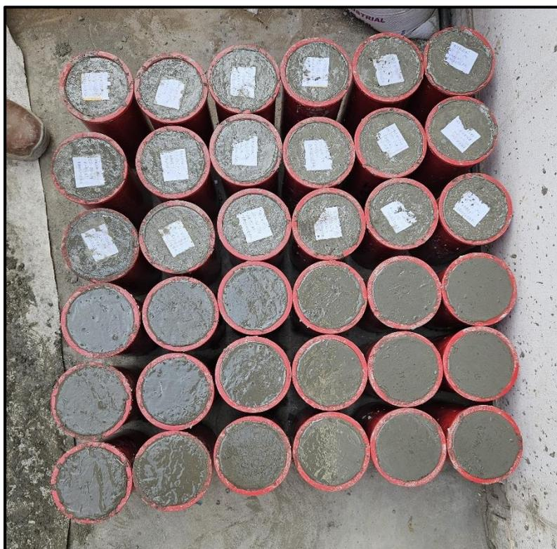
Foto 7: Probetas cilíndricas
