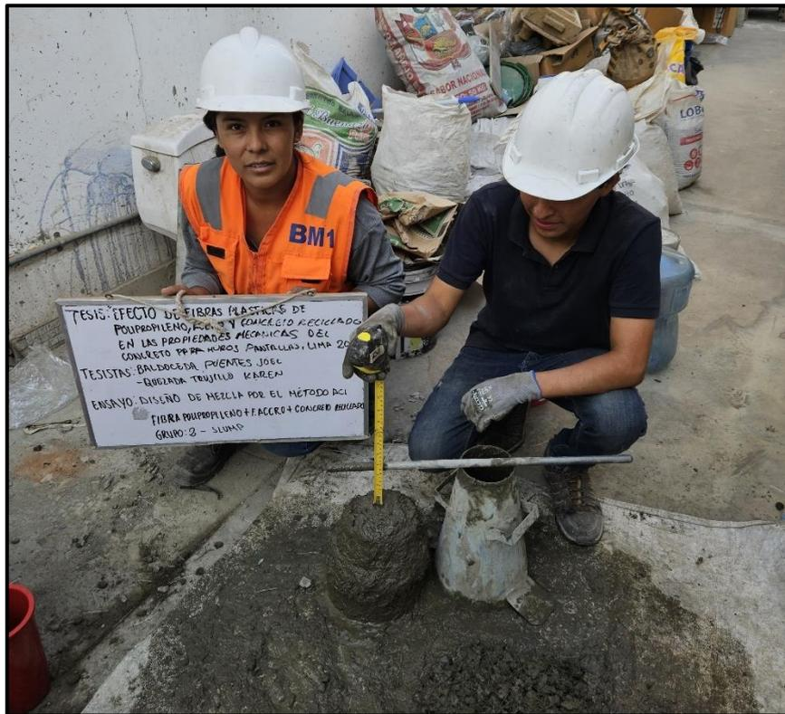
Foto 5: ensayo de Slump
