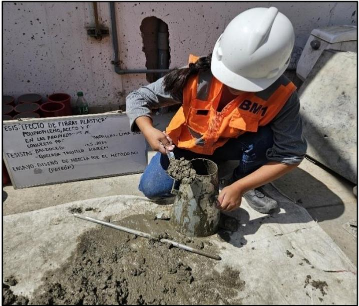
Figura 21. Ensayo de cono de Abrams del concreto patrón
