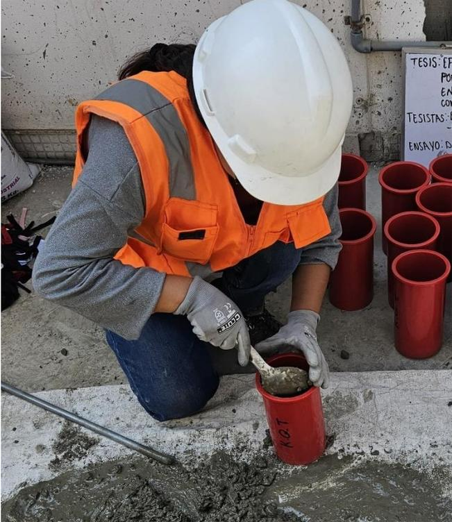
Figura 31. Vaciado de probetas grupo experimental 1
