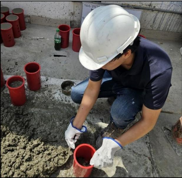
Figura 23. Vaciado de probetas
