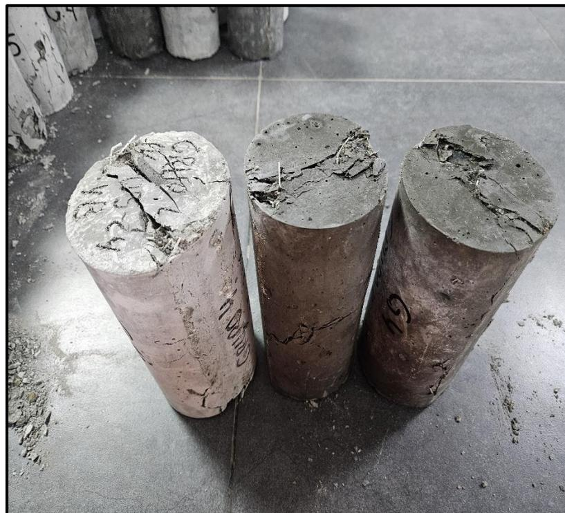
Foto 12: probetas roturadas por tracción
