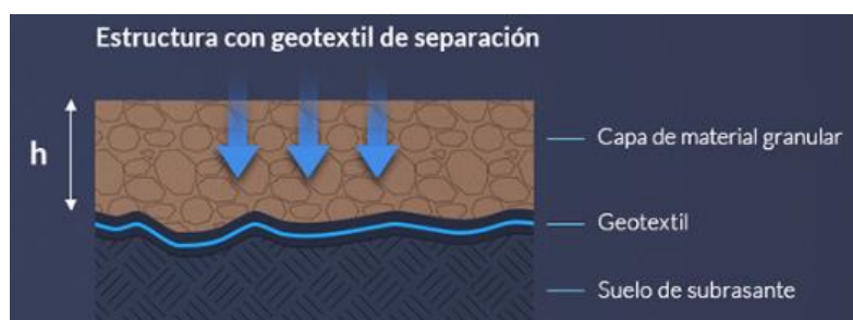
Figura 3. Estructura con geotextil de separación
