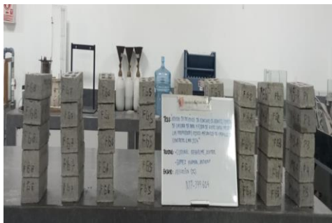
Fotografía 27. Ensayo de absorción de grupo patrón y grupos factoriales.
