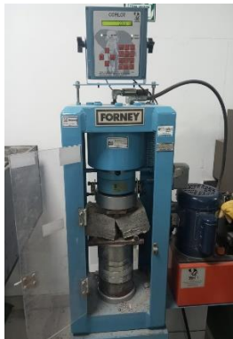
Fotografía 40. Rotura a flexión de grupo patrón.
