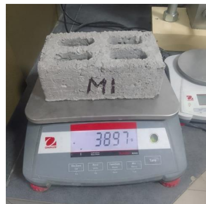
Fotografía 30. Peso de muestras para absorción.
