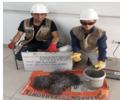
Fotografía 18. Peso unitario de fibras de acero.
