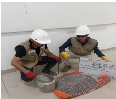
Fotografía 17. Peso unitario de Residuos de cochas de abanico.
