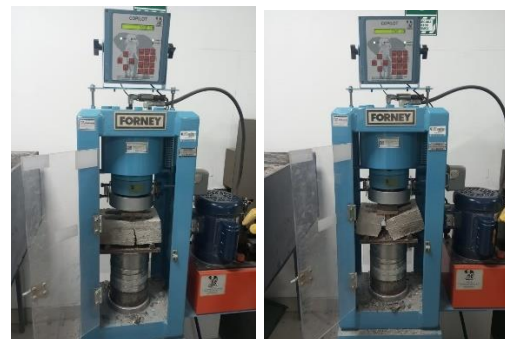
Fotografía 47. Rotura a flexión de grupo patrón y grupo factorial a los 28 días.
