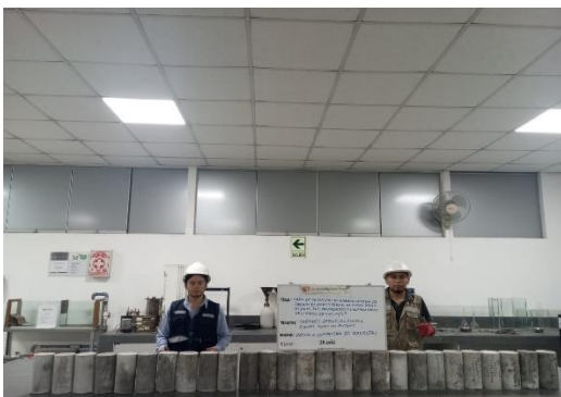
Fotografía 42. Muestras para rotura a compresión de probetas de grupo patrón y grupo factorial a los 28 días.
