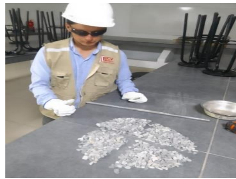
Fotografía 8. Cuarteo de agregados.
