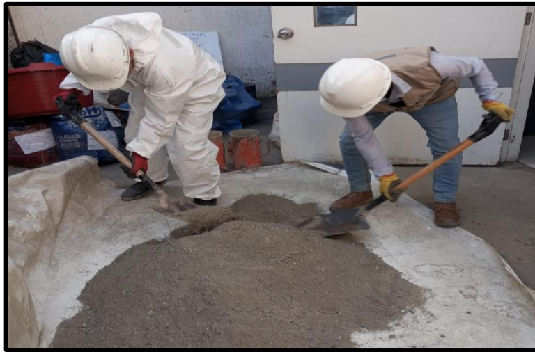
Figura 31. Proceso de elaboración de mezcla de concreto patrón
