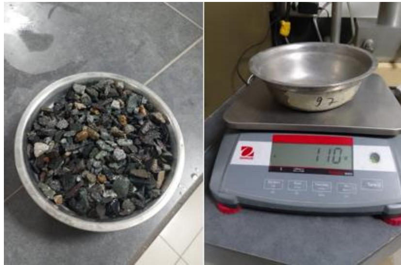
Figura 17. Pesado de muestras para granulometría
