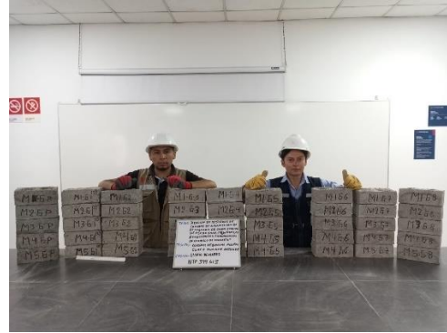
Fotografía 32. Muestras para ensayo de Alabeo
