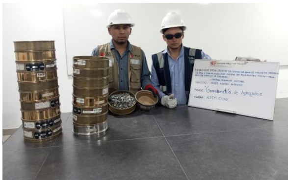
Fotografía 7. Granulometría Agregado grueso y fino.
