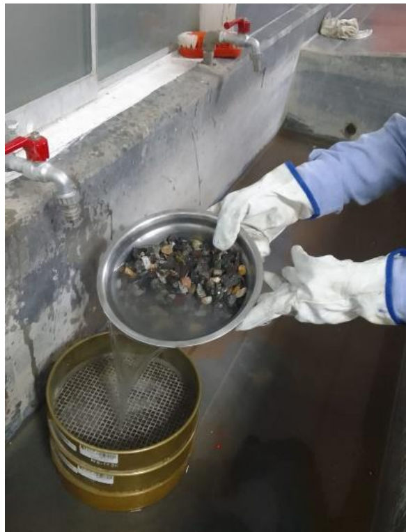
Figura 16. Lavado de agregado grueso. Fuente propia
