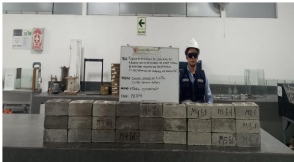
Fotografía 44. Muestras para rotura a compresión de grupo patrón y grupo factorial a los 28 días.
