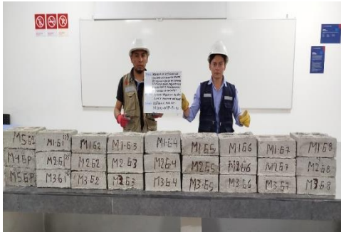
Fotografía 38. Muestras para rotura a flexión de Grupo patrón a los 14 días.
