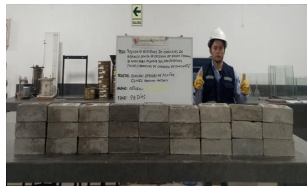
Fotografía 46. Muestras para rotura a flexión de grupo patrón y grupo factorial a los 28 días.
