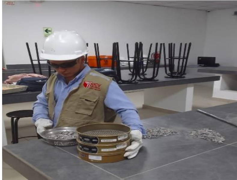
Figura 15. Toma de muestra de cuarteo Fuente propia
