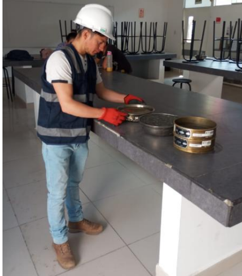
Figura 24. Lavado de agregado fino.
