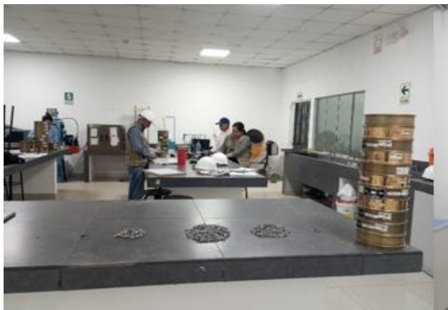
Figura 20. Muestras retenidas por tamices
