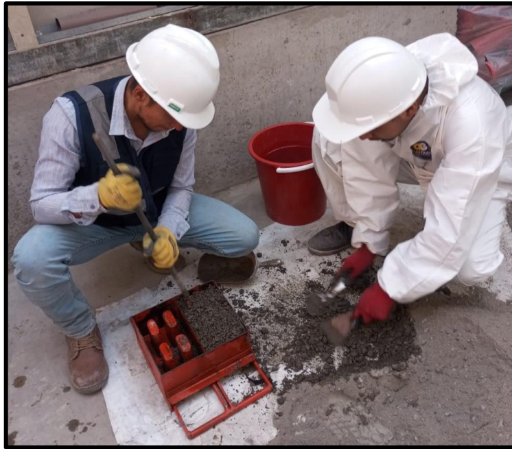
Figura 35. Vaciado de concreto en moldes de ladrillo
