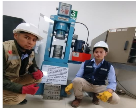
Fotografía 34. Rotura a compresión de Grupo factorial a los 14 días.
