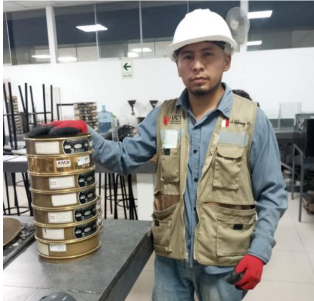
Figura 26. Toma de equipos para tamizado de fino
