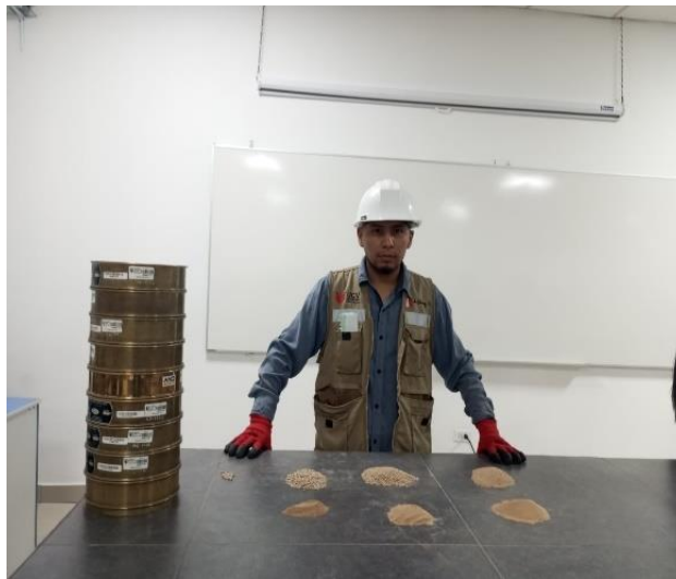
Figura 28. Muestras retenidas por tamices
