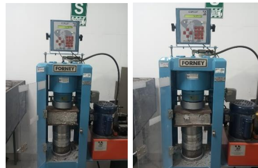
Fotografía 45. Rotura a compresión de grupo patrón y grupo factorial a los 28 días.
