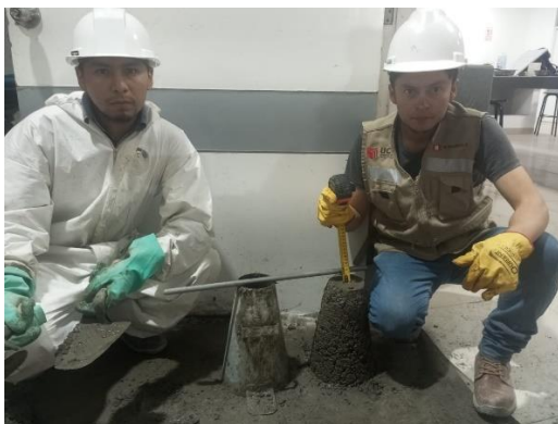
Fotografía 23. Se realizo en Slump en el concreto fresco al grupo patrón y grupos factoriales.
