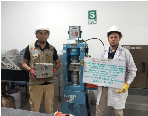
Fotografía 33. Rotura a compresión de Grupo patrón a los 14 días.
