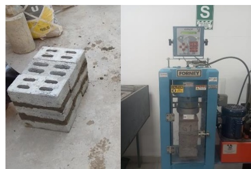
Fotografía 49. Rotura axial de pilas a compresión de grupo patrón y grupo factorial.
