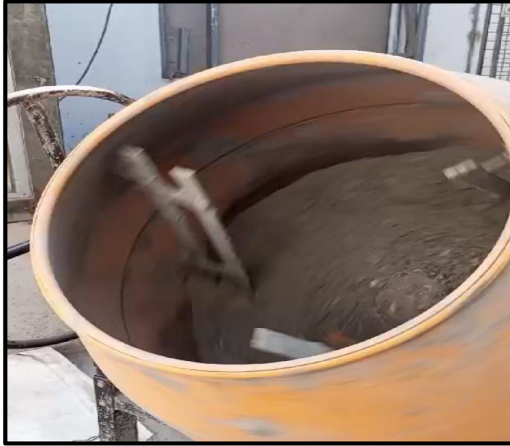
Figura 33. Batido de la mezcla patrón
