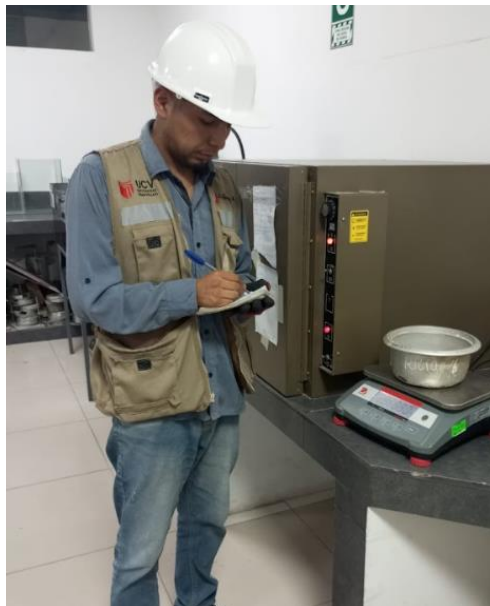
Figura 25. Pesado de muestras para granulometría de fino
