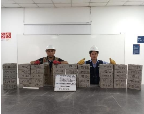
Fotografía 31. Muestras para ensayo de Alabeo para grupo patrón y grupos factoriales.
