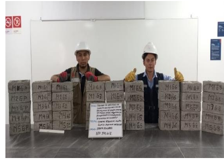
Fotografía 39. Muestras para rotura a flexión de Grupo factorial a los 14 días.
