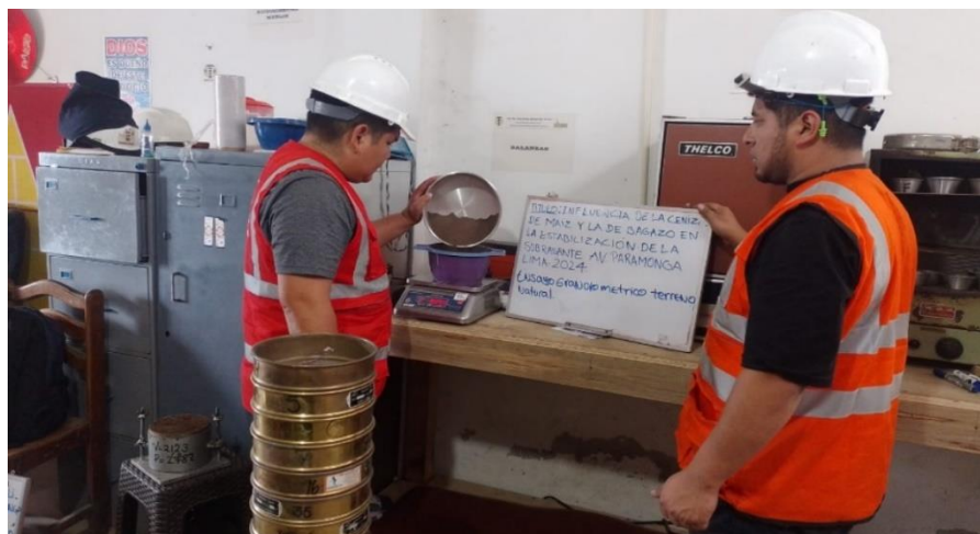
Figura 21. Ensayo de granulometría mediante tamizado.
