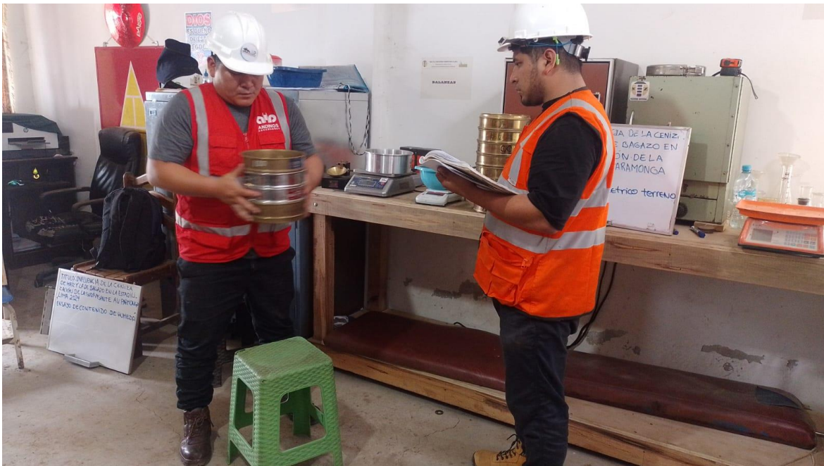
Figura 40. Zarandeo de las muestras en los tamices.
