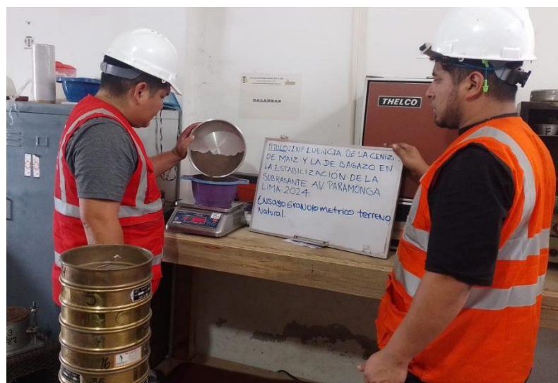
Figura 4. Equipos para el ensayo de granulometría.
