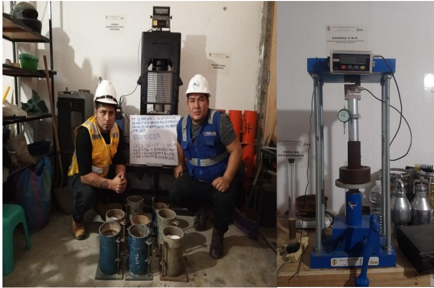
Figura 33. Ensayo de CBR a la muestra.
