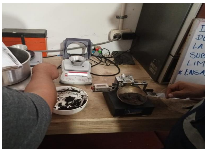
Figura 29. Procedimiento del ensayo de límites de consistencia.
