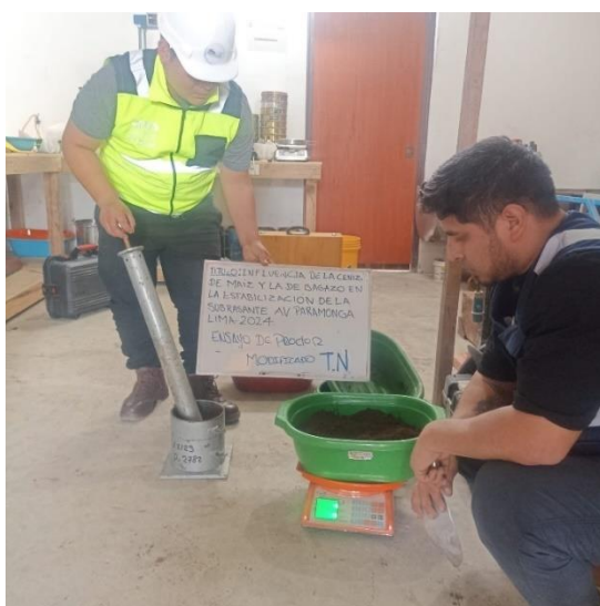
Figura 31. Proceso de Proctor compactación.
