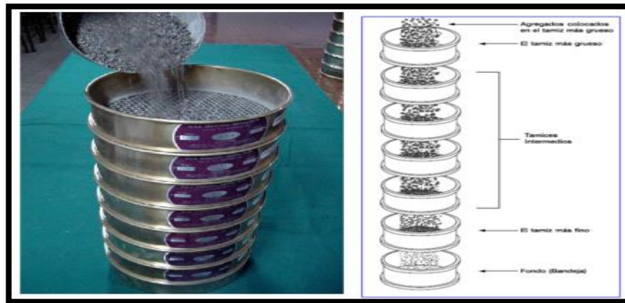
Figura 11. Tamizado de suelo en serie de mallas
