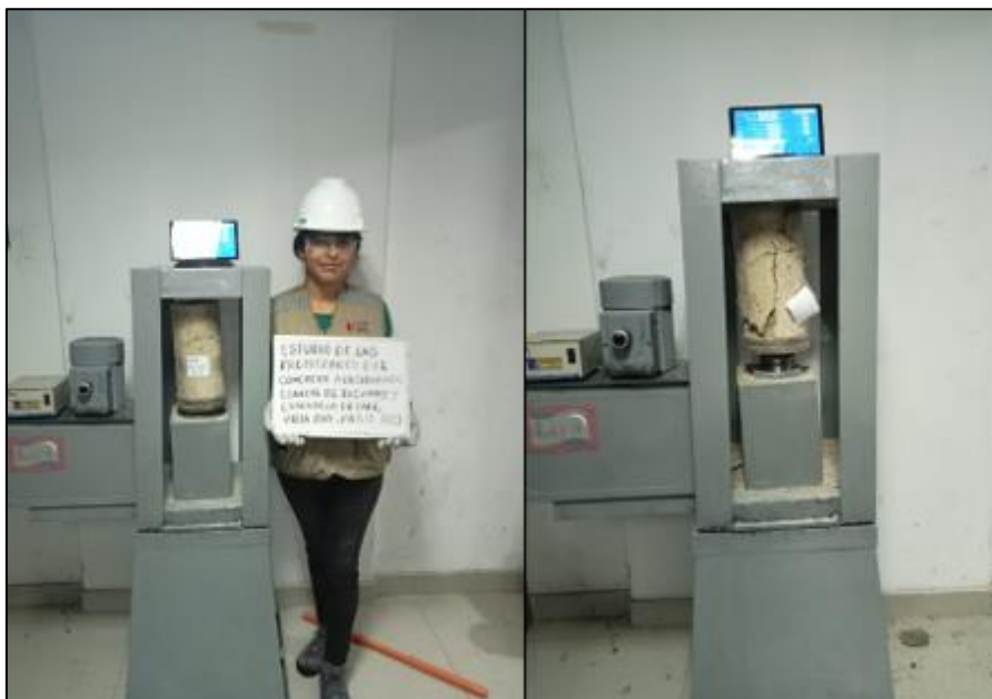
Figura 29. Rotura de la probeta para encontrar la resistencia a compresión.
