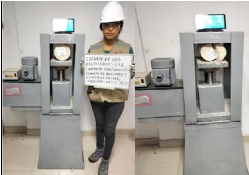
Figura 34. Rotura de la probeta para encontrar la resistencia a tracción.
