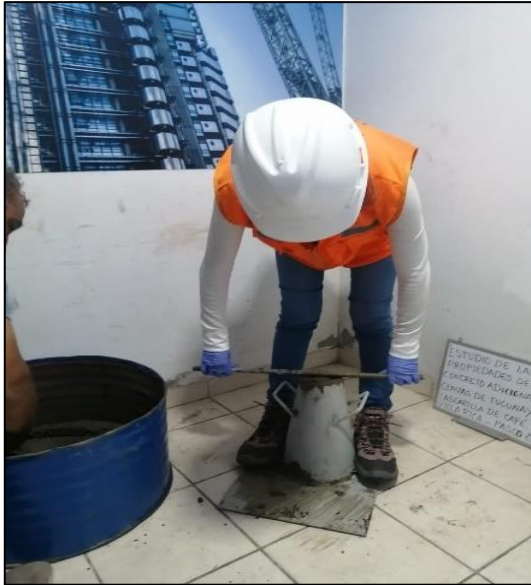
Figura 17. Medida de la trabajabilidad mediante el cono de Abrams.
