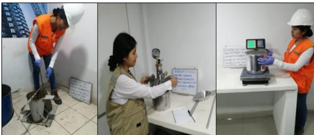
Figura 25. Elaboración del slump, contenido de aire y densidad.
