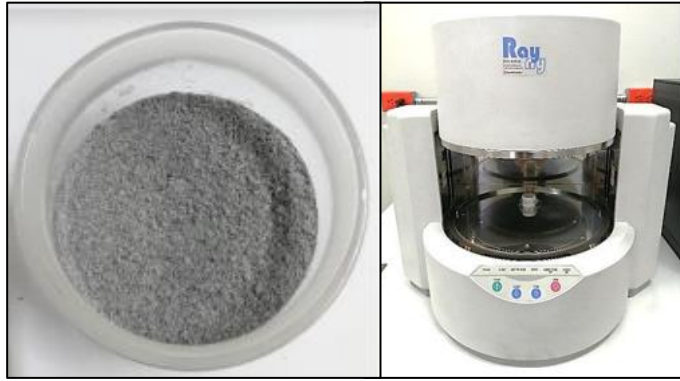
Figura 10. Muestra de ceniza de tucunay y espectrómetro de fluorescencia de rayos x de energía dispersiva.
