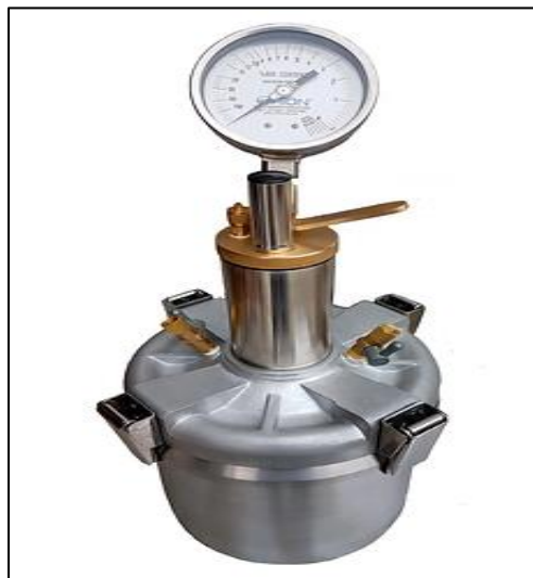
Figura 3. Olla Washington para medir el contenido de aire.
