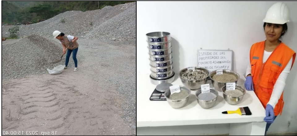
Figura 16. Extracción de los materiales de la Cantera Agremaqs y tamizado de los agregados en el laboratorio.
