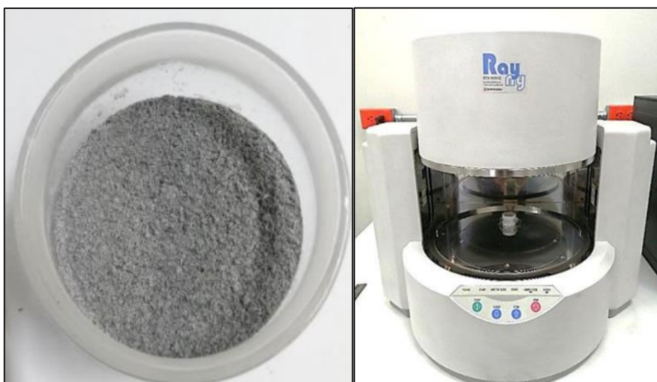
Figura 24. Muestra de la ceniza de tucunay y espectrometría de fluorescencia de rayos x de energía dispersiva (SHIMADZU, EDX-800HS).
