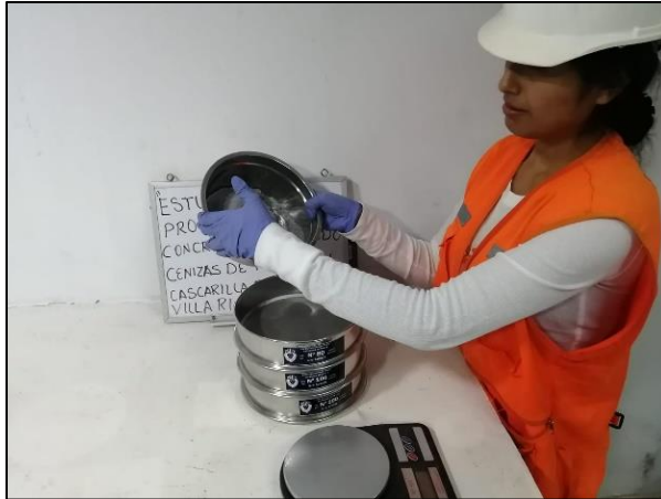
Figura 15. Granulometría de las cenizas de tucunay y cascarilla de café.
