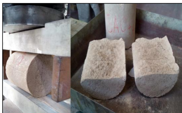
Figura 5. Rotura de una probeta por esfuerzo diametral para la resistencia a tracción.
