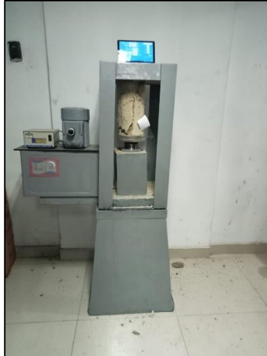
Figura 19. Rotura de probeta para encontrar el f'c .
