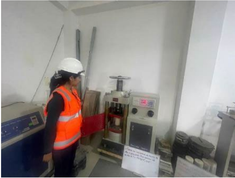
Figura 12. Ensayos de rotura para determinar la compresión del concreto
