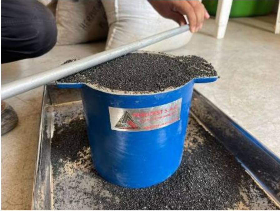
Figura 08. Ensayos de peso unitario a la escoria de cobre
