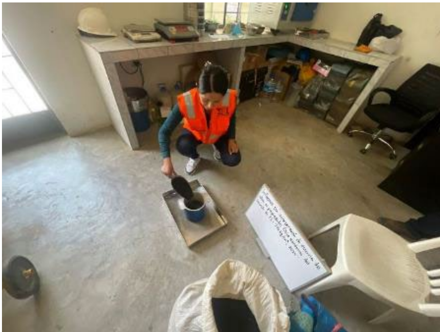
Figura 09. Ensayos de peso unitario a la escoria de cobre
