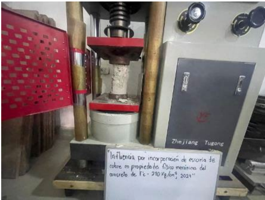
Figura 12. Ensayos de rotura para determinar la compresión del concreto
