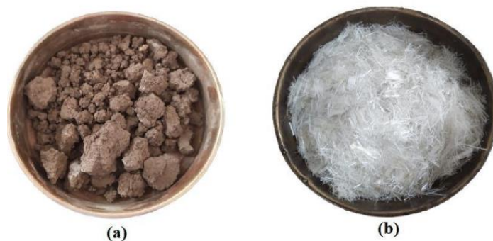
Figura 3: Materiales usados (a) Suelo de algodón negro (BC); (b) Fibra de vidrio.
