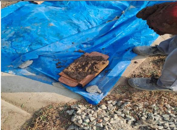
**Fotografía 15.** Vertido de la mezcla en el molde
