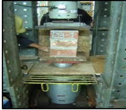
*Figura 8.* Ensayo de compresión axial en pilas
