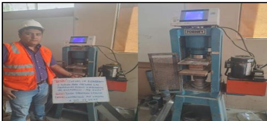
Figura 26. Proceso del ensayo a compresión del ladrillo
