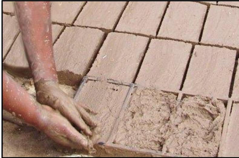
*Figura 5.* Maleabilidad del material en la producción de ladrillos
