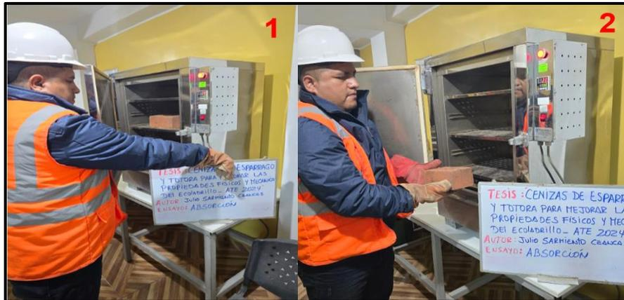
Figura 20. Ensayo de la absorción del ladrillo
