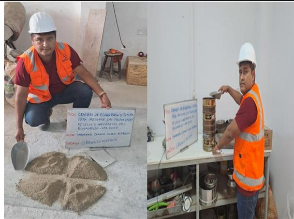
**Fotografía 7.** Cuarteo del material y análisis granulométrico
