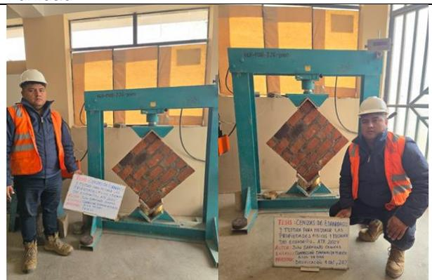
Fotografía 19. Resistencia a compresión en muretes
