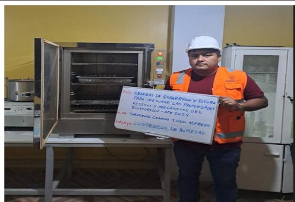
**Fotografía 11.** Contenido de humedad del material
