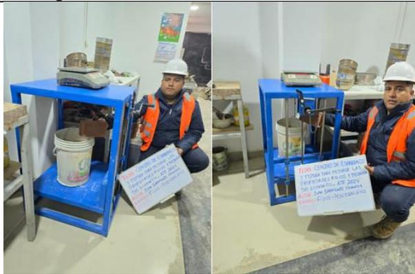
Fotografía 16. Peso específico del ladrillo
