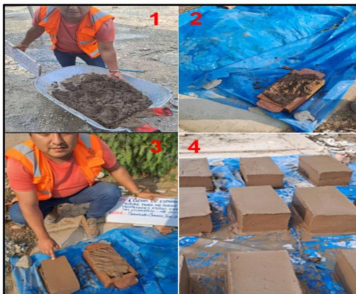
**Figura 18. Procedimiento de elaboración de ladrillos**
