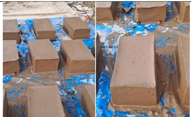
**Fotografía 18.** Proceso de secado del ladrillo
