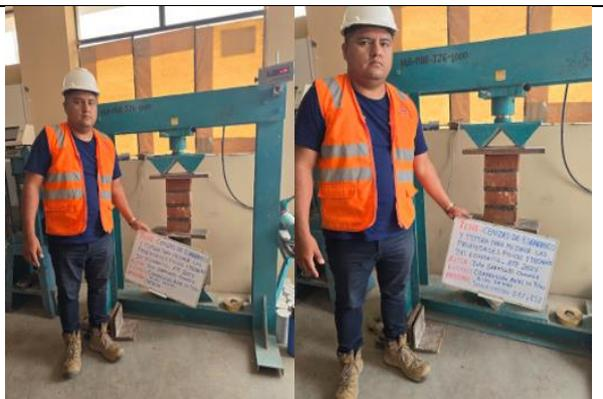
Fotografía 18. Resistencia a compresión en pilas
