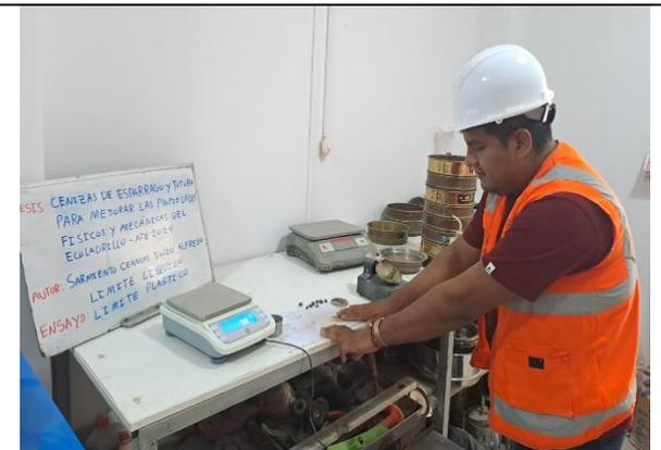
**Fotografía 10.** Elaboración de cilindros de la muestra
