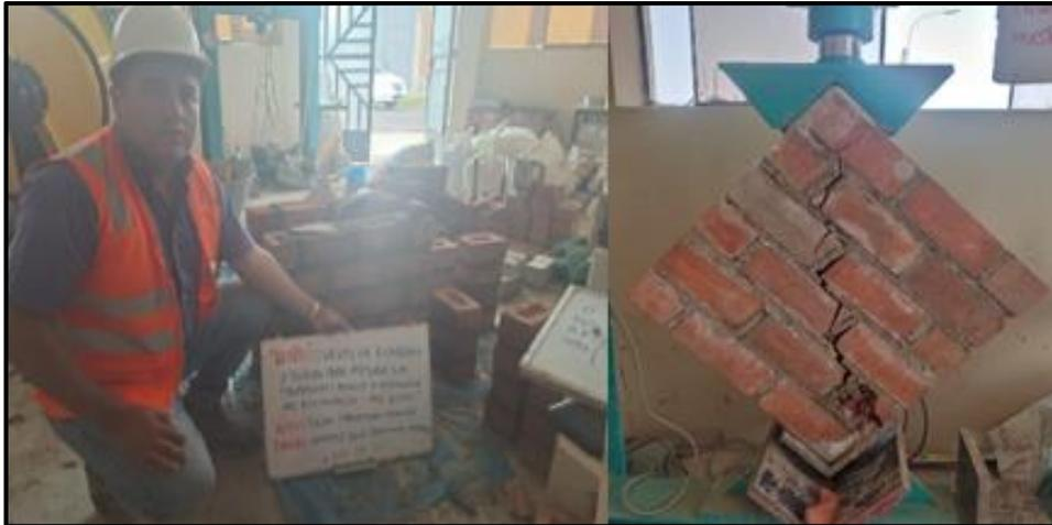
Figura 34. Procedimiento del esfuerzo a compresión diagonal en muretes
