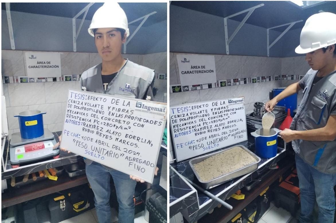
**Figura 53. Ensayo de peso unitario compacto del agregado fino**
