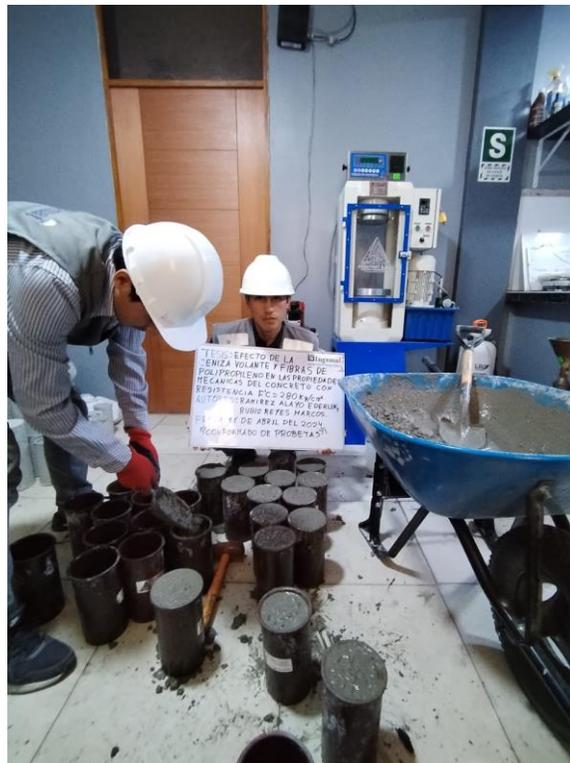
**Figura 65. Desmoldeo de las probetas de concreto**
