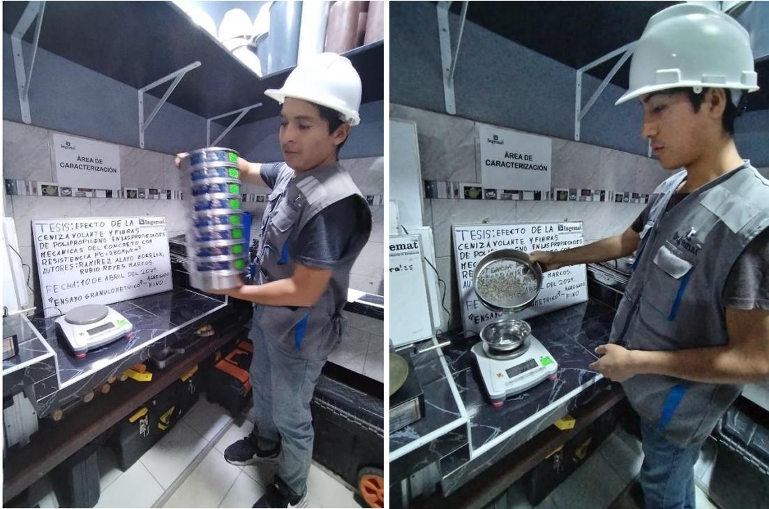
Figura 48. Peso inicial de muestra para el ensayo
