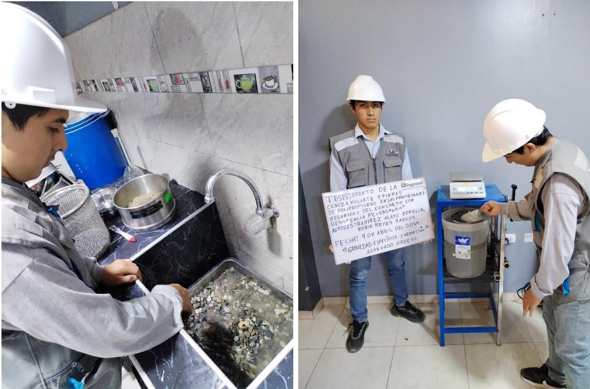
Figura 58. Ensayo de peso unitario suelto del agregado grueso
