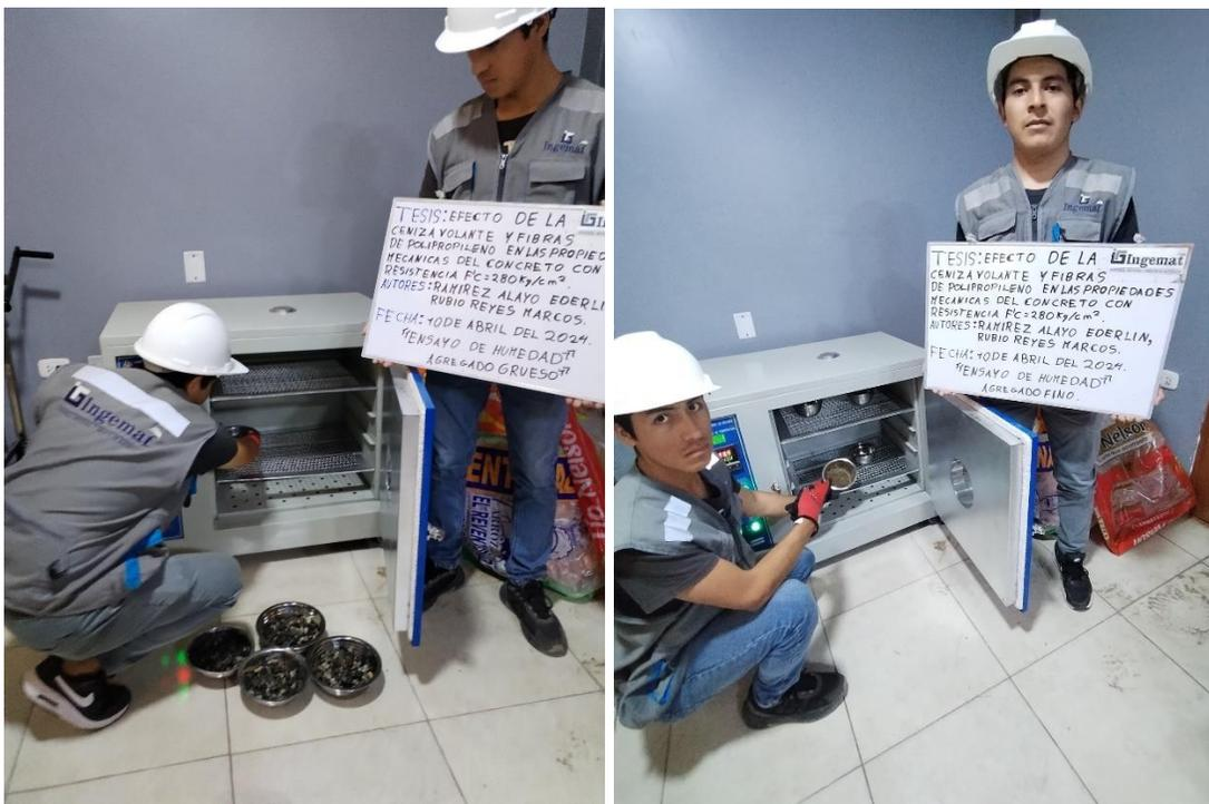
Figura 57. Ensayo de gravedad específica y absorción del agregado grueso
