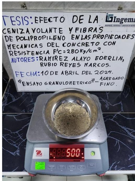
Figura 49. Ensayo de contenido de humedad del agregado fino
