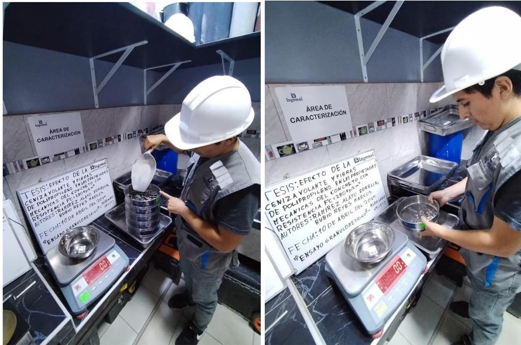
Figura 56. Ensayo de contenido de humedad del agregado grueso
