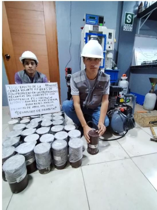
**Figura 66. Probetas de concreto desmoldeadas**
