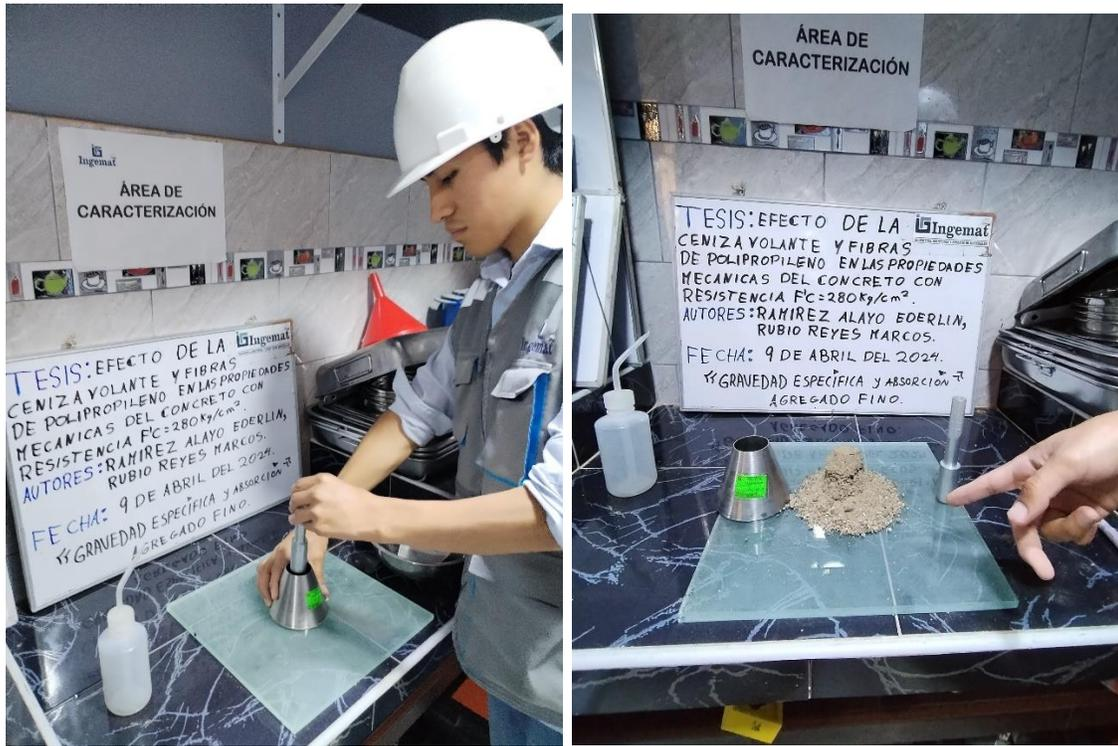
Figura 52. Ensayo de peso unitario suelto del agregado fino
