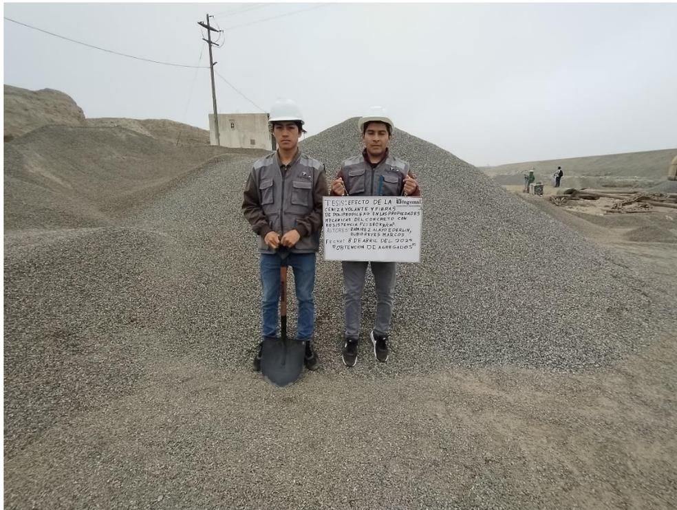
**Figura 44. Muestreo de agregado grueso**
