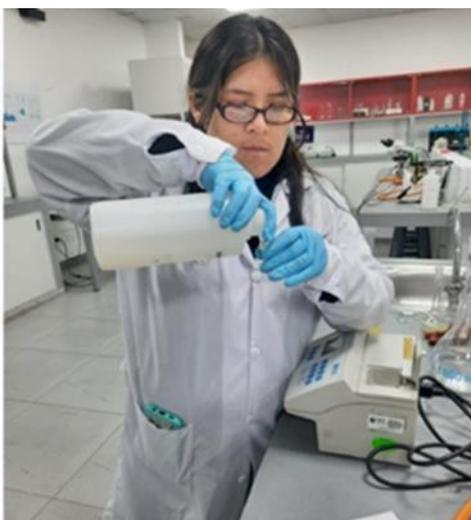
**Figura 43.** Introducción de la muestra al vial de vidrio
