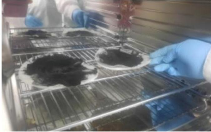
**Figura 14.** Secado de carbón activado
