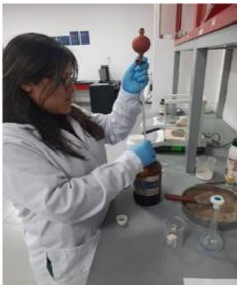
**Figura 39.** Preparación de solución de ácido sulfúrico
