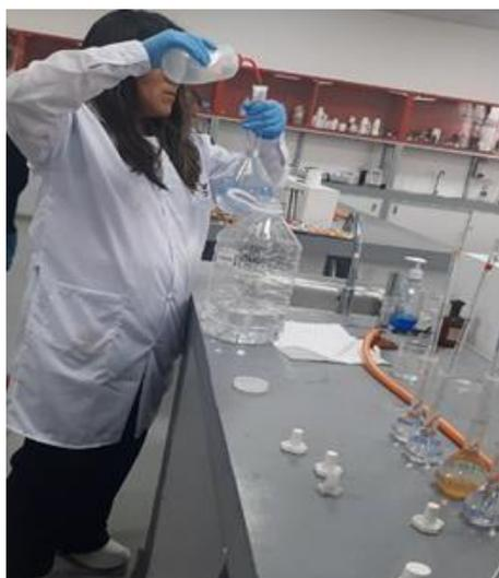
**Figura 36.** Aforamiento con agua destilada
