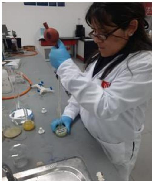
**Figura 38.** Preparación de solución de digestión
