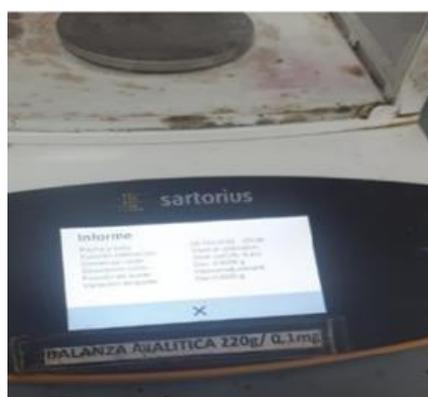
**Figura 28.** Calibración de balanza digital.
