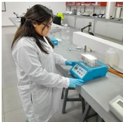
**Figura 41.** Colocación de ampollas al digestor de bloque
