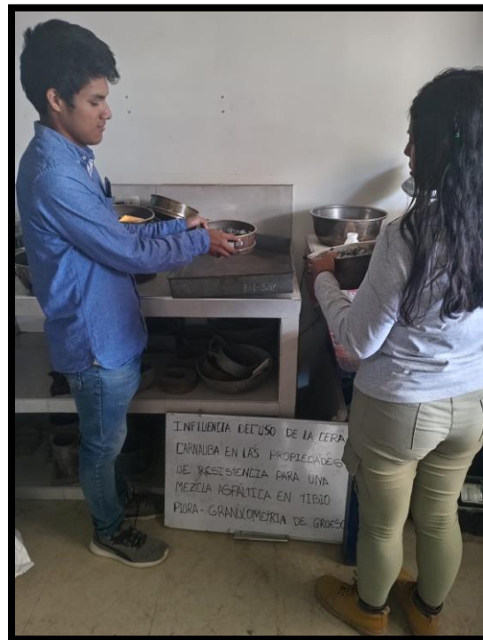
Imagen N° 06: Ensayo de granulometría de gruesos.
