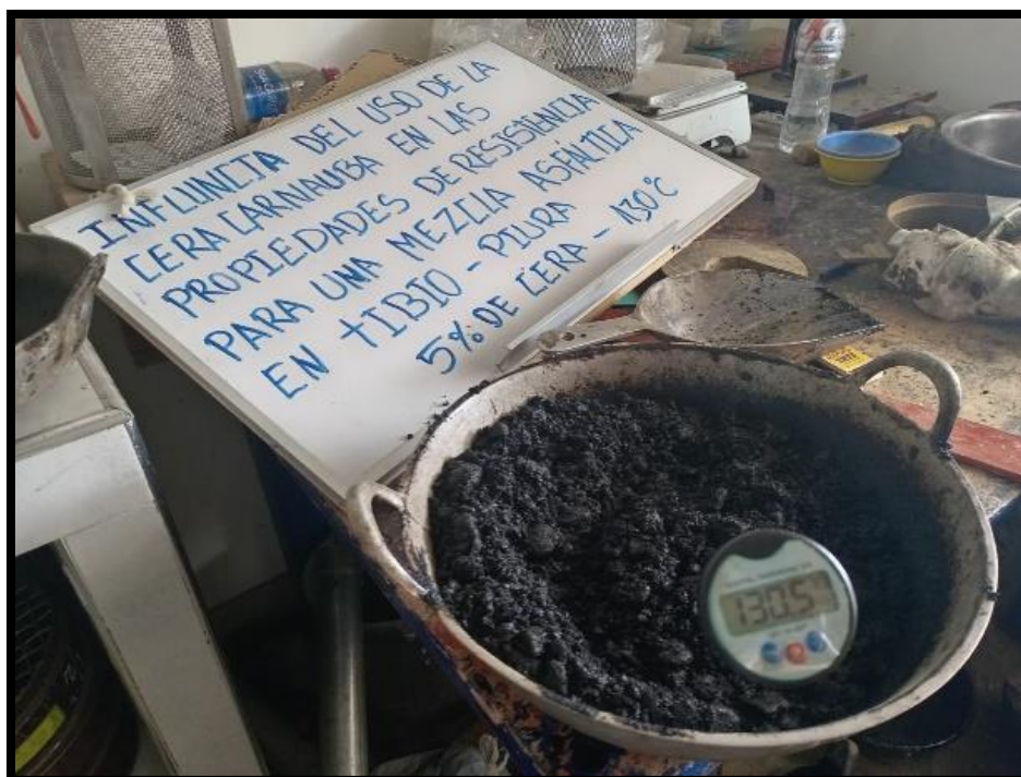
Imagen N° 18: Muestra del 5% de cera carnauba con temperatura de 130°.
