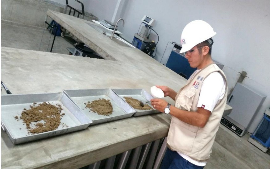
Foto N° 1: Separación de muestras para el secado.
