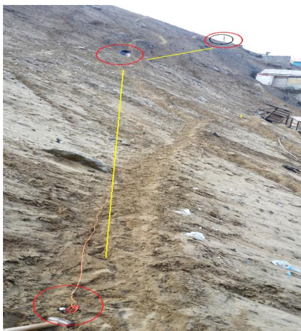
Tendido de cables para el ensayo SEV N°1
