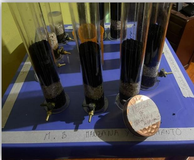
**Figura 31.** Biofiltros con Biocarbón de manzana y aguaymanto.
