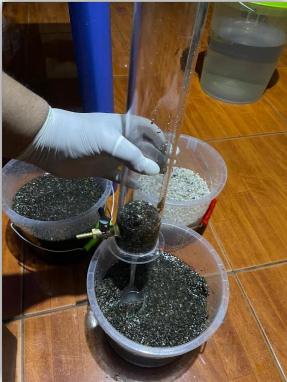
**Figura 27.** Armado del biofiltro con el piedrín.
