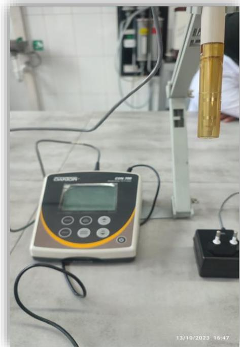
**Figura 12.** Medición de la conductividad eléctrica.
