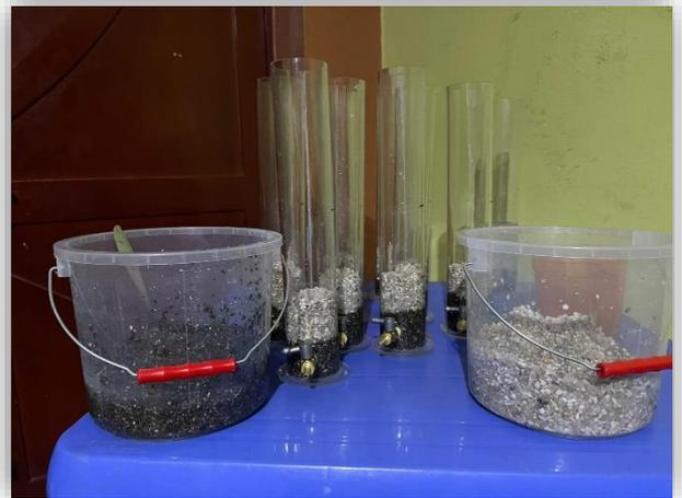
**Figura 28.** Armado del biofiltro con la arena silica.
