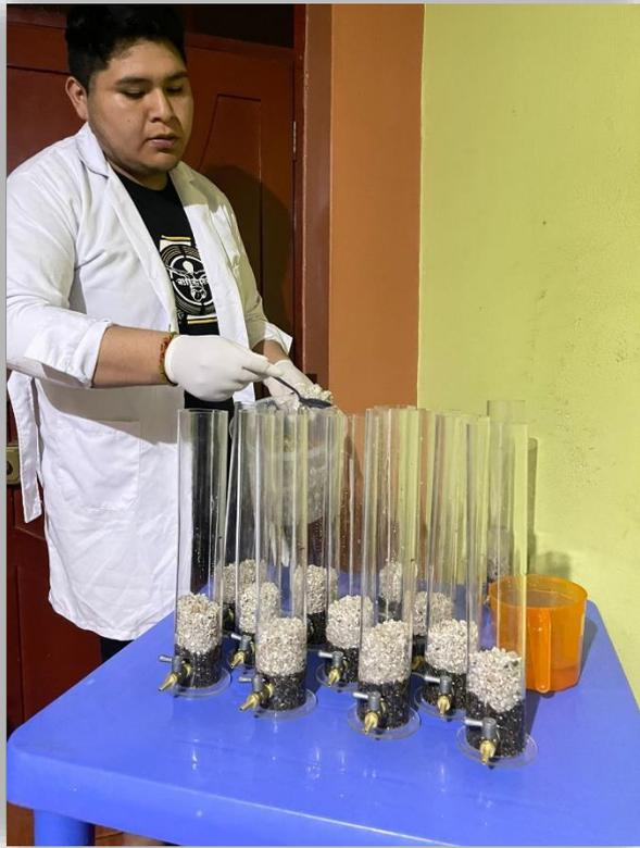
**Figura 29.** Colocación del material de biocarbón.
