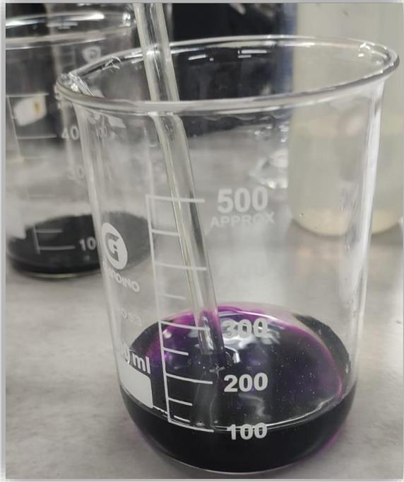
**Figura 19.** 1gr de  $KMnO_4$  en 100 ml de agua destilada.
