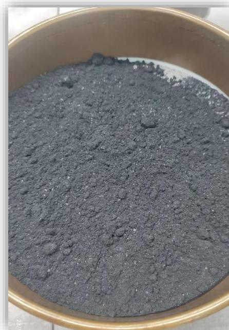
**Figura 8.** *Tamizado del biocarbón.*
