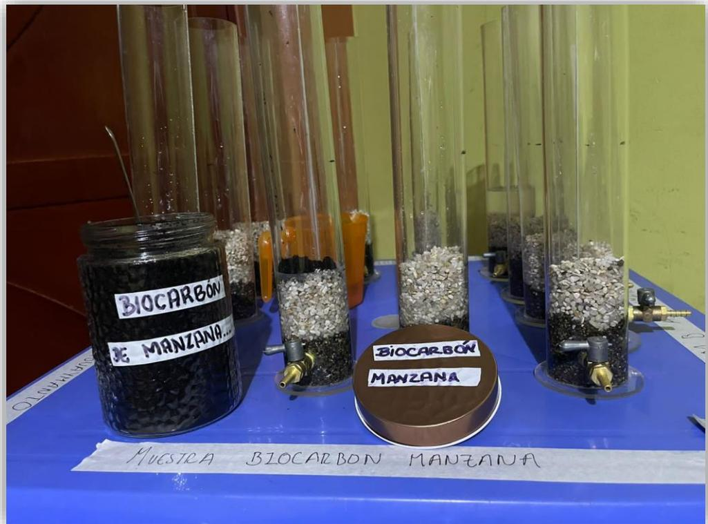
**Figura 33.** Biofiltros con Biocarbón de manzana.
