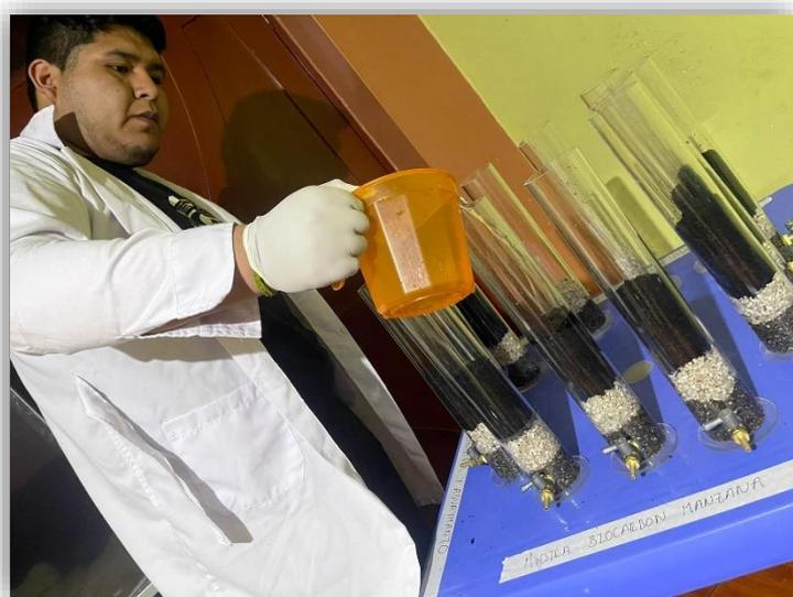
Figura 35. Se colocó una muestra de 1 L por biofiltro.
