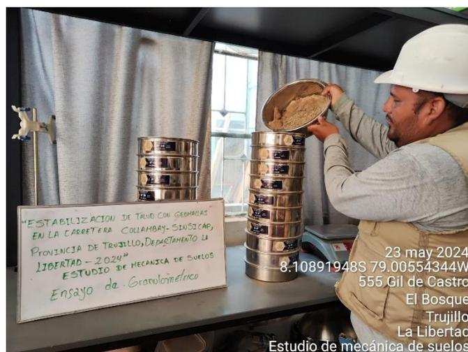
Imagen 6: fuente propia ensayo de laboratorio
