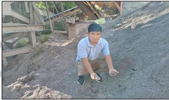
Ilustración 18. FOTOS DE VISITA IN-SITU. AGREGADO FINO PARA DISEÑO DE MEZCLA
