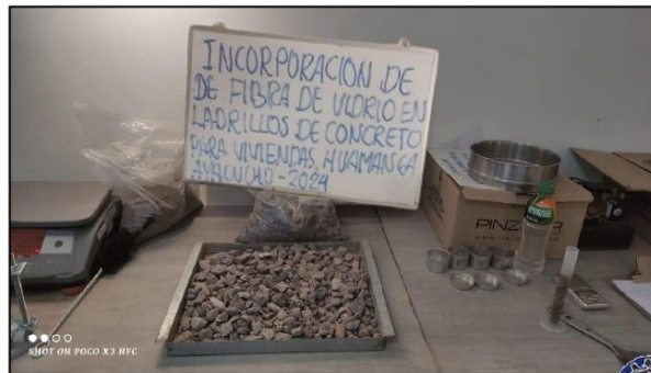
Ilustración 16. ENSAYO PARA DETERMINAR CONTENIDO DE HUMEDAD DE AGREGADO GRUESO
