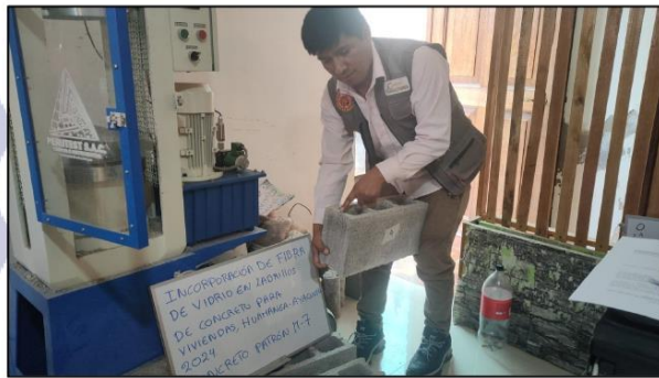
Ilustración 50. PREPARADO DE LOS BLOQUES DE CONCRETO PARA EL ENSAYO EN LA MAQUINA DE ROTURA
