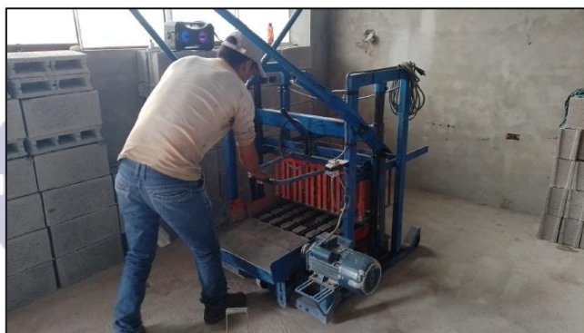
Ilustración 34. MOLDE PARA LA ELABORACIÓN DE BLOQUES DE CONCRETO
