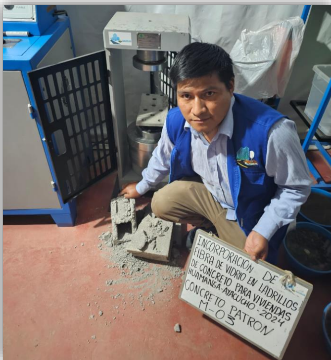
Ilustración 42. Finalmente se obtiene la rotura del bloque de ladrillo de concreto.
