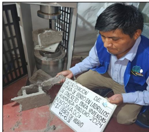
Ilustración 25. ENSAYO DE TESTIGO No 3 CON 1.0% DE FIBRA DE VIDRIO
