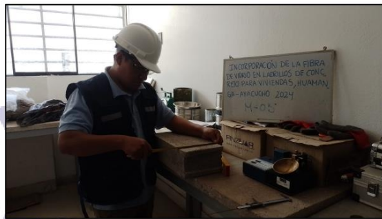
Ilustración 59. TESTIGO DE ENSAYO DE ALABEO DE LA MUESTRA 05
