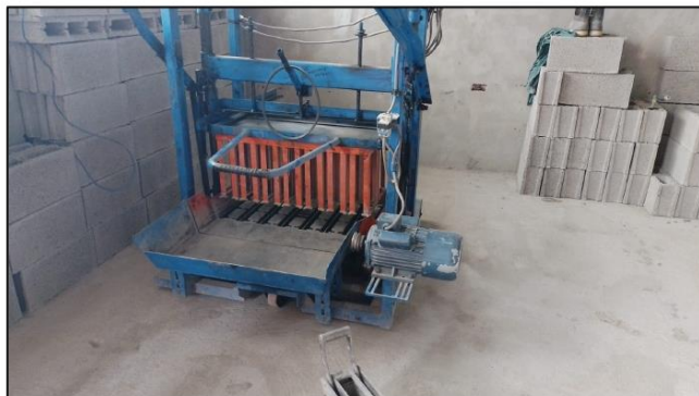
Ilustración 33. MOLDE PARA LA ELABORACIÓN DE BLOQUES DE CONCRETO
