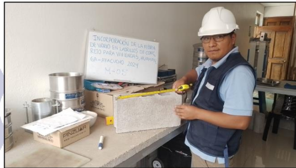
Ilustración 56. TESTIGO DE ENSAYO DE ALABEO DE LA MUESTRA 03
