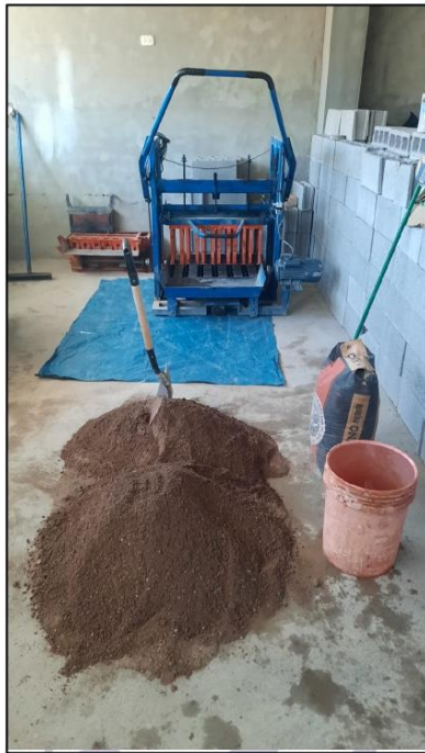
Ilustración 31. ELABORACIÓN DE BLOQUES DE CONCRETO INCORPORANDO 0.5% DE FIBRA DE VIDRIO
