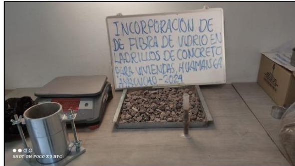
Ilustración 15. ENSAYO PARA DETERMINAR PESO ESPECÍFICO SSS.
