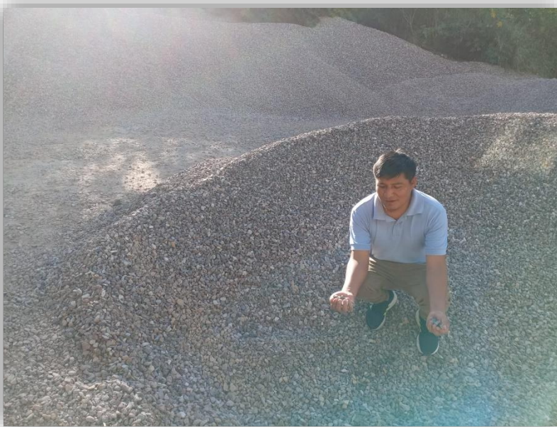
Ilustración 31. Material extraído de una cantera, específicamente agregado grueso conocido como "confitillo".
