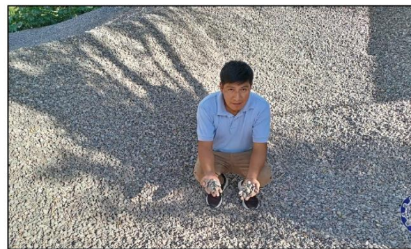
Ilustración 20. FOTOS DE VISITA IN-SITU, TOMA DE MUESTRAS DE AGREGADO GRUESO
