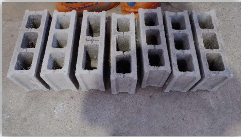
Ilustración 39. Bloques de ladrillo de concreto con adición de fibra de vidrio en laboratorio.
