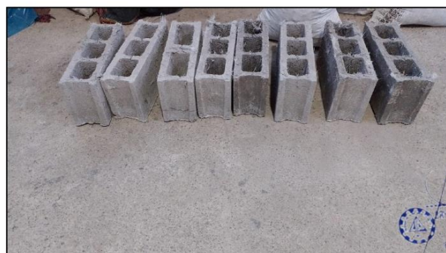
Ilustración 35. BLOQUES DE CONCRETO AÑADIDO FIBRA DE VIDRIO A LOS 7 días
