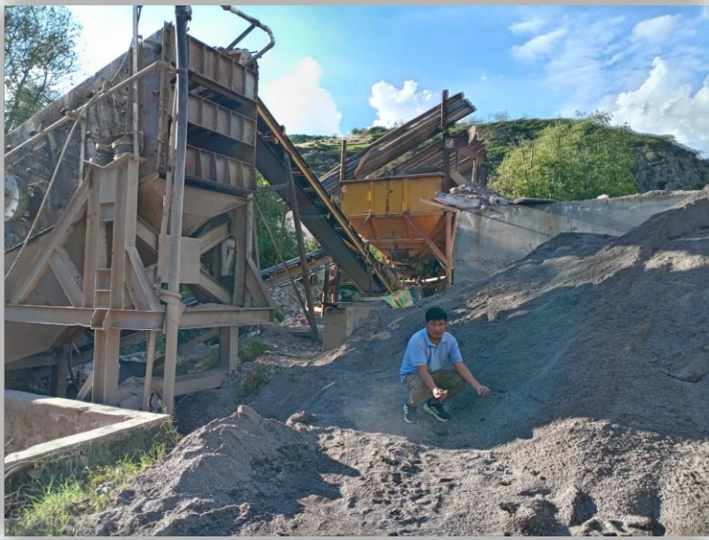
Ilustración 31. Material extraído de una cantera, específicamente agregado grueso conocido como "confitillo".
