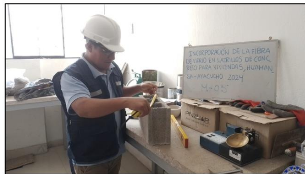
Ilustración 57. TESTIGO DE ENSAYO DE ALABEO DE LA MUESTRA 05
