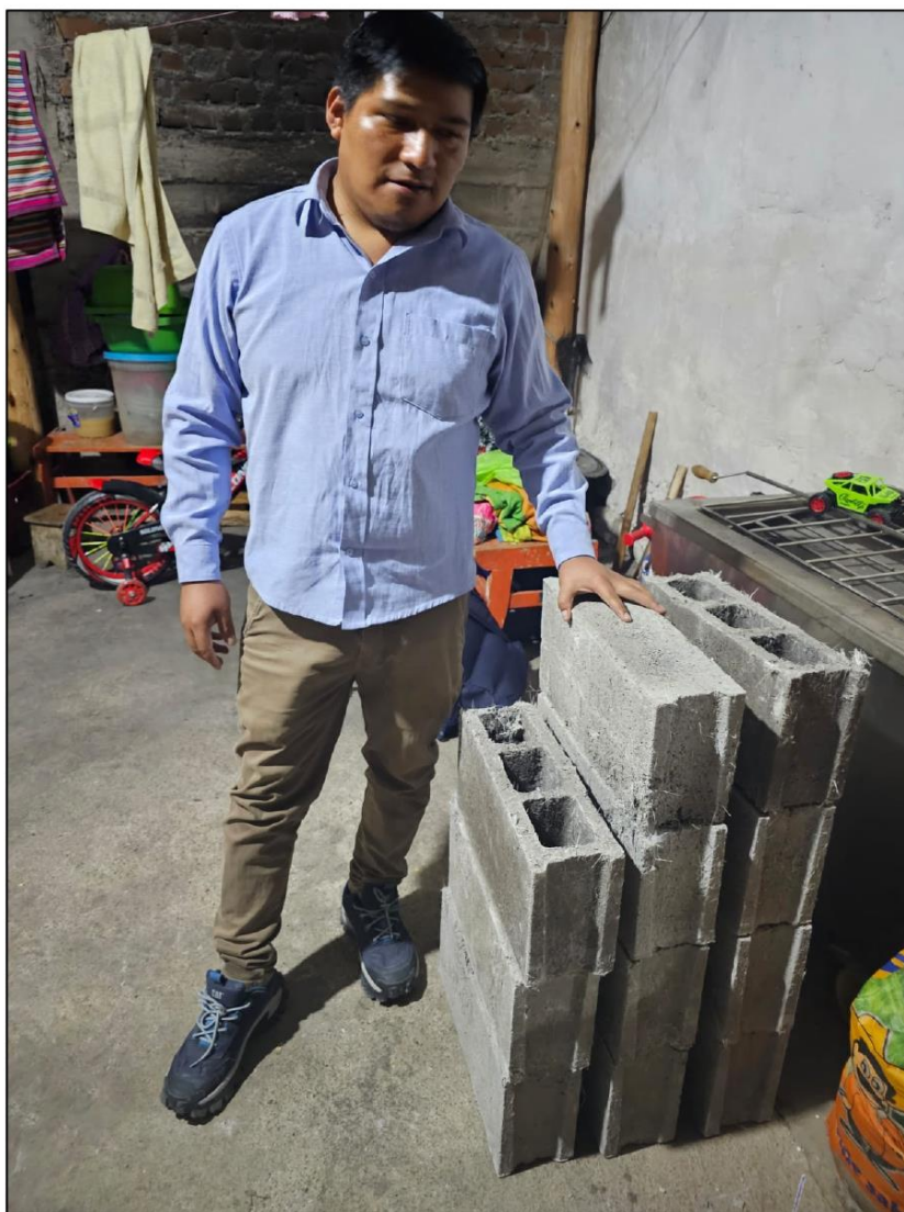
Ilustración 36. BLOQUES DE CONCRETO AÑADIDO FIBRA DE VIDRIO A LOS 14 días
