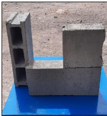
Ilustración 28. BLOQUES DE CONCRETO TESTIGO CON 0.0% DE FIBRA DE VIDRIO A LOS 7 DÍAS
