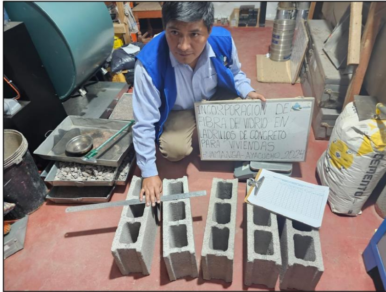
Ilustración 38. BLOQUES DE CONCRETO AÑADIDO FIBRA DE VIDRIO A LOS 28 días
