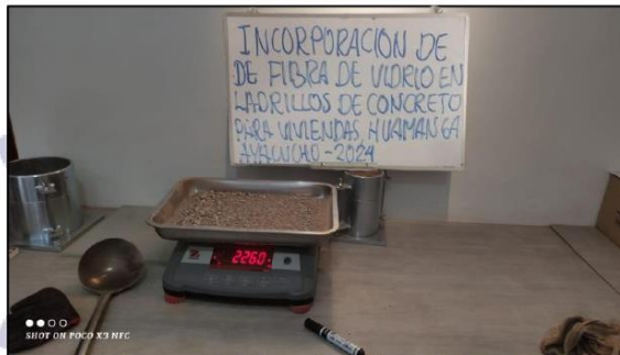
Ilustración 15. Ensayo contenido de humedad para agregado fino
