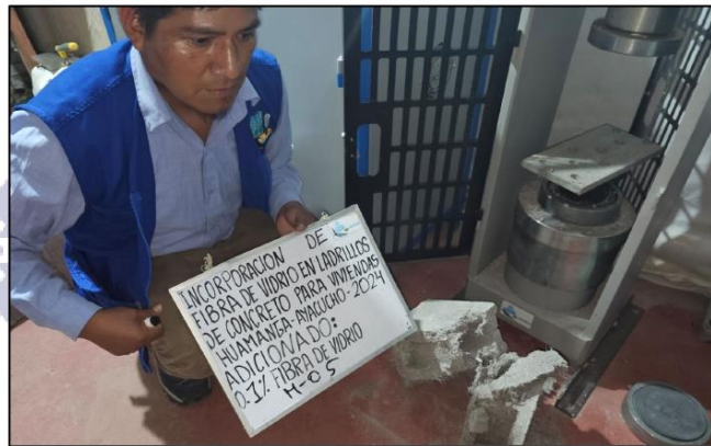
Ilustración 27. ENSAYO DE TESTIGO No 5 CON 1.0% DE FIBRA DE VIDRIO
