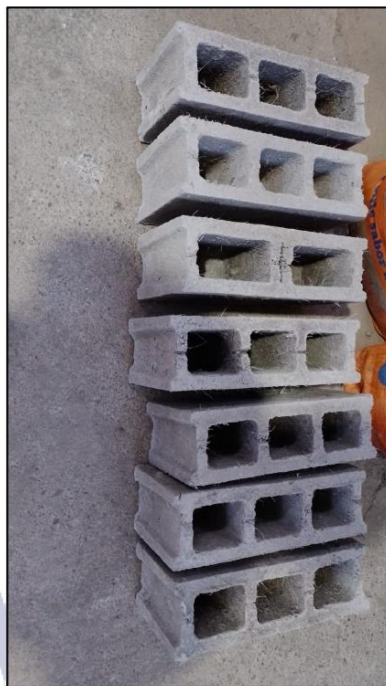
Ilustración 31. ELABORACIÓN DE BLOQUES DE CONCRETO INCORPORANDO 0.5% DE FIBRA DE VIDRIO
