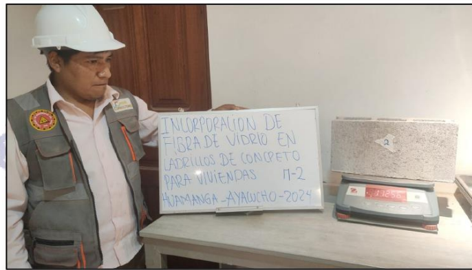
Ilustración 41. PESADO DE LOS BLOQUES DE CONCRETO MUESTRA 02 CON 0.0% DE FIBRA DE VIDRIO
