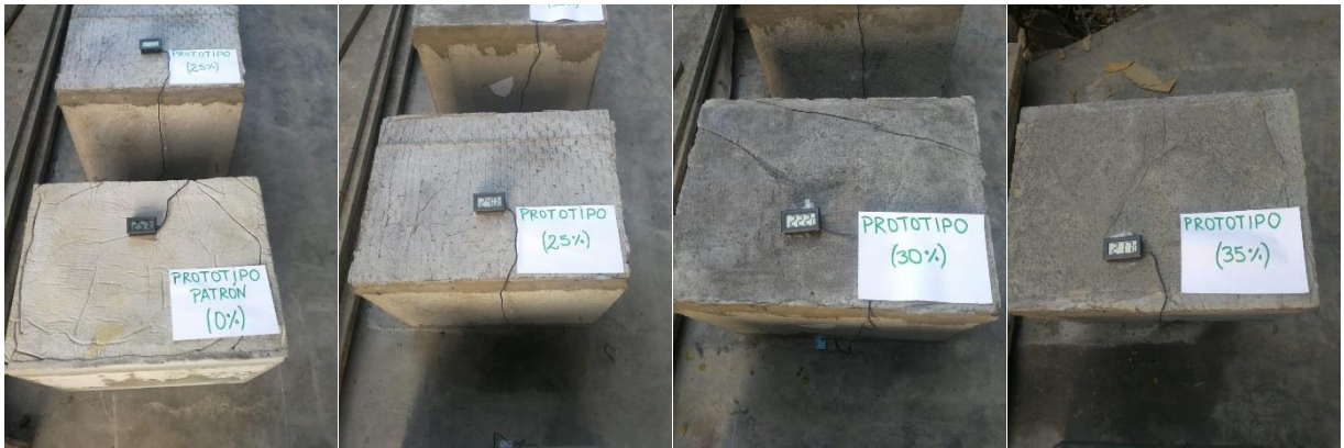
Foto 32. Ensayo de Aislamiento térmico a temperatura ambiente en los 4 prototipos.
