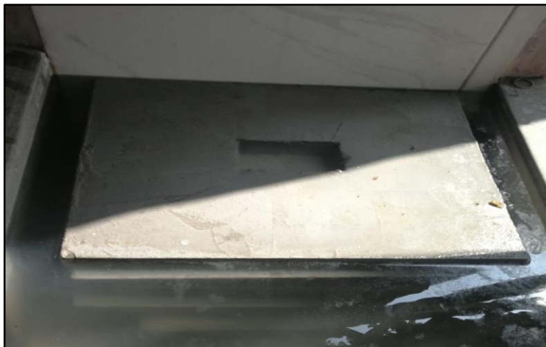
Figura 25. Curado de placas de mortero
