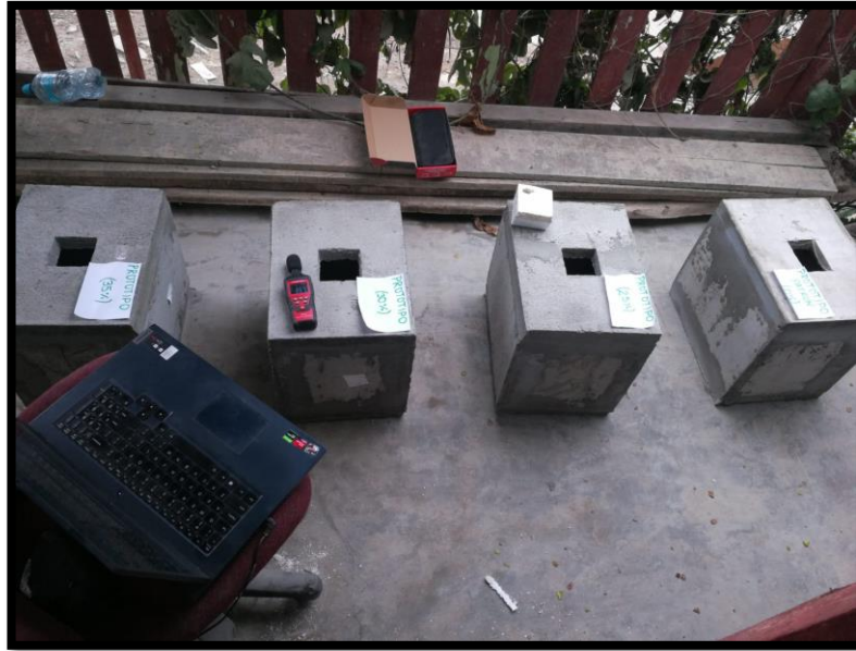
Foto 36. Ensayo acústico de ruido exterior.
