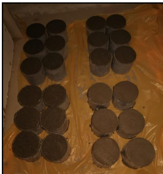
Figura 15. Vaciado de mortero en las probetas
