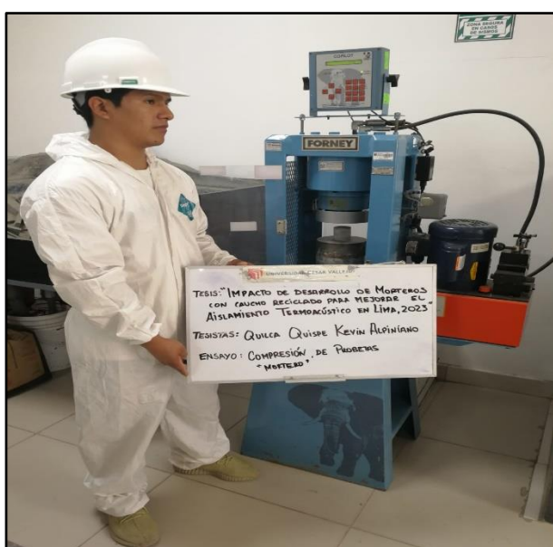
Figura 17. Rotura de probetas de mortero a los 14 días
