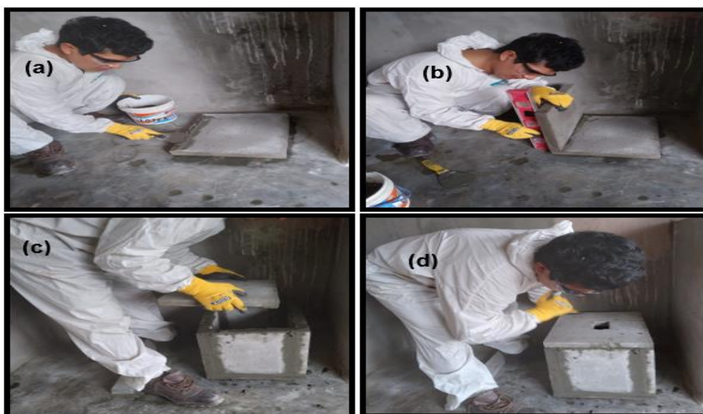
Figura 27. Preparación de maquetas (a) fraguado; (b) junta de placas; (c) ensamblado; (d) finalizado
