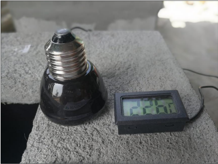
Figura 41. Generador de calor y termómetro
