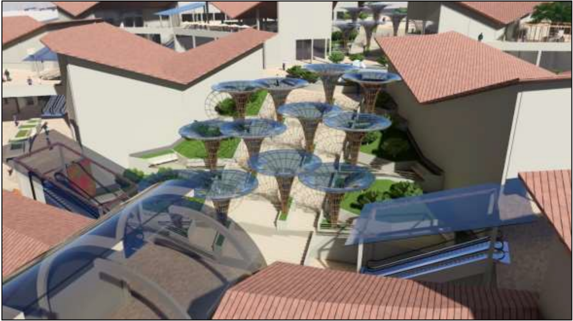
Figura 46. Imagen de las estructuras de bambu, las cuales brindan sombra en el área de escalera principal, así mismo éstas recolectan las precipitaciones pluviales.
