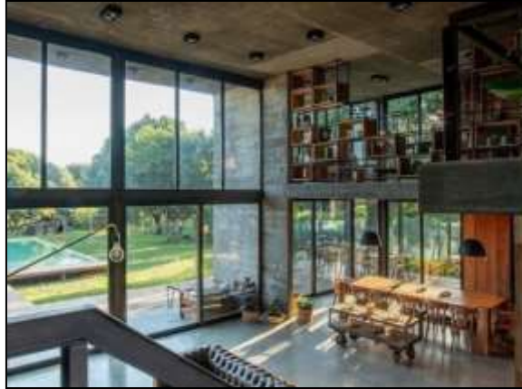
Figura 16. Iluminación y ventilación a travex de la doble altura
