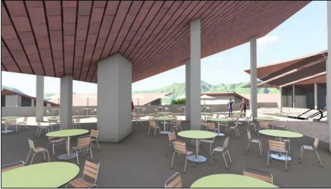
Figura 52. Se visualiza zona interna del patio de comidas, donde se puede apreciar la cobertura con pendiente de 20% dirigida hacia la zona de la sierra.
