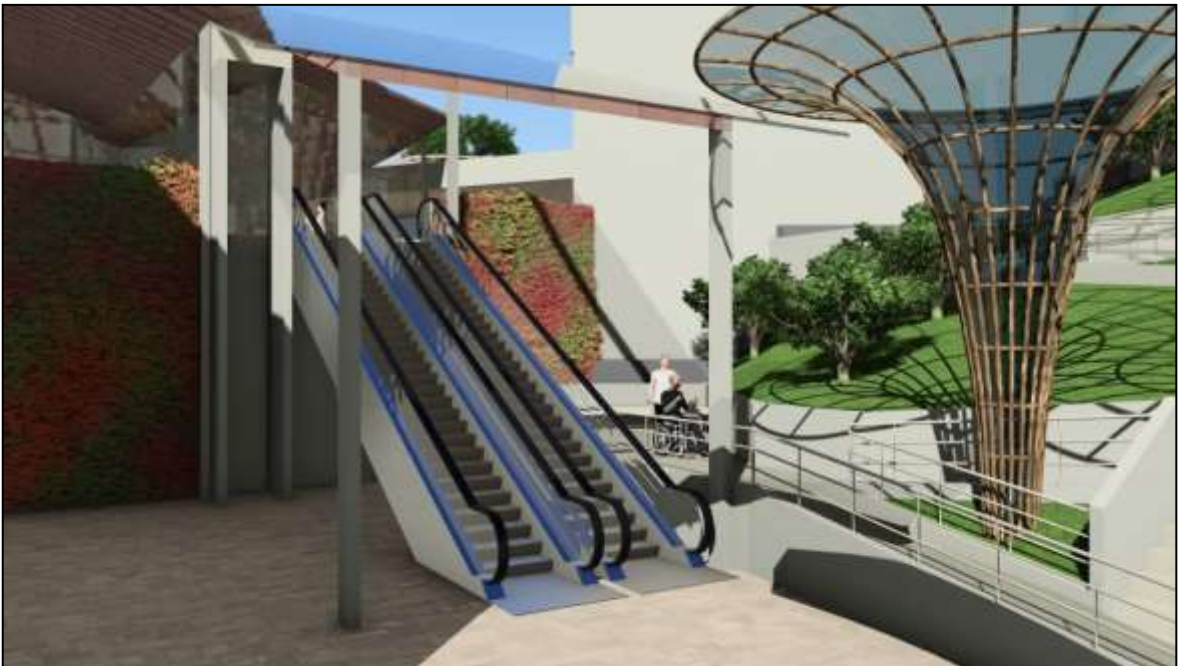
Figura 51. Vista desde el interior de la zona de acceso al segundo nivel, se visualiza, estructura de bambú, jardín vertical, rampa para discapacitados, ascensor para discapacitados y escalera mecánica con cobertura translúcida del material policarbonato.
