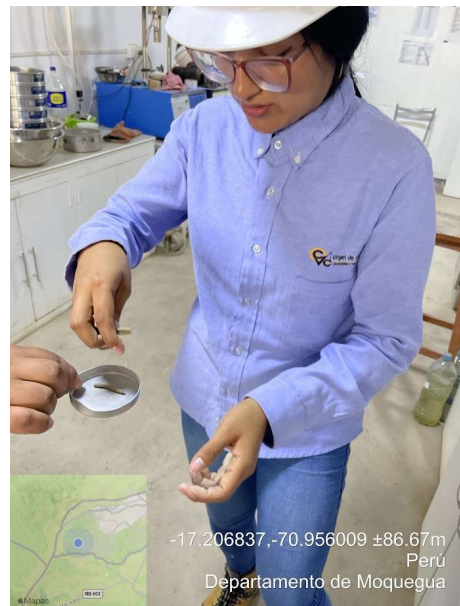
Foto N°18: Muestra de suelo húmeda lista para pesar
