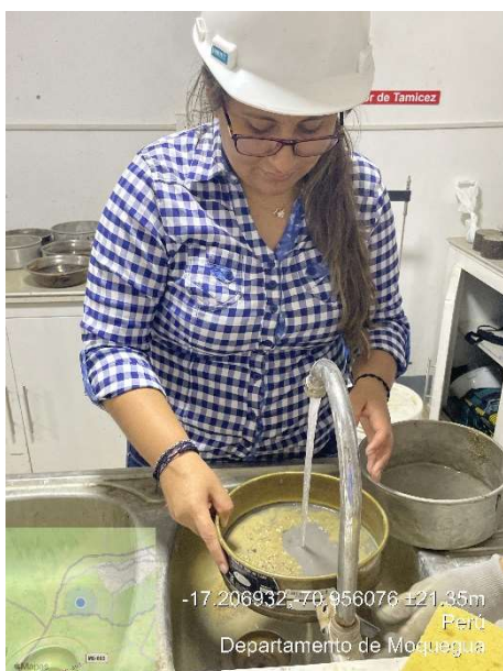
Foto N°21: Tamizado en húmedo de muestra de suelo arcilloso + RCD
