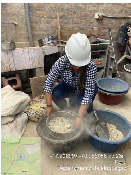
Foto N°19: Tamizado en seco de muestra de suelo arcilloso + RCD
