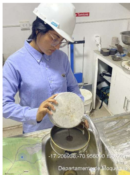
Foto N°22: Tamizado en húmedo de muestra de suelo arenoso + RCD
