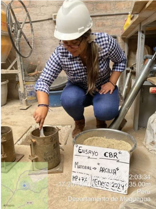
Foto N°27: Llenado de la primera capa de muestra arcillosa +RCD
