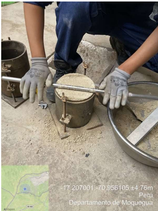
Foto N°29: Nivelando la capa final de la muestra arcillosa +RCD
