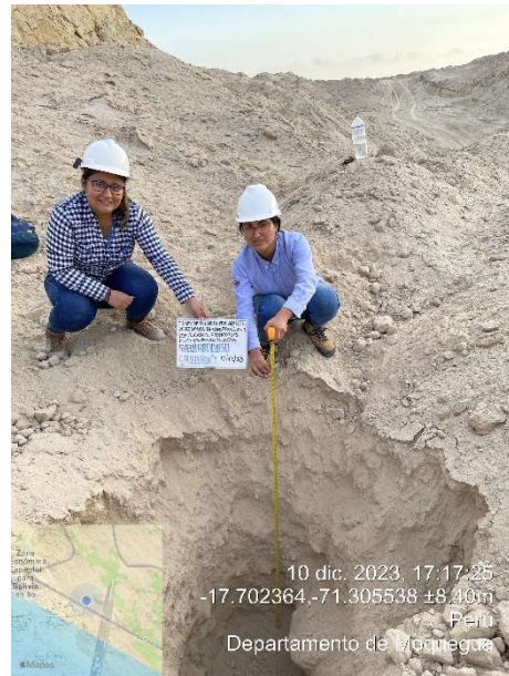
Foto N°02: Calicata N°1 - Suelo arcilloso
