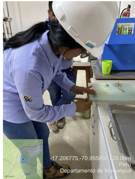
Foto N°16: Muestra amasada de suelo en cilindros de 3 mm de diámetro.
