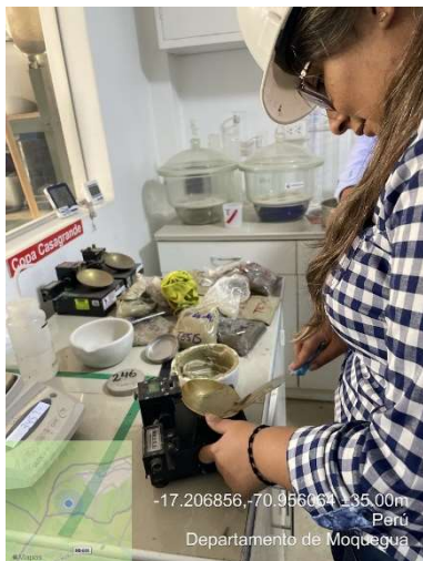
Foto N° 13: Colocación de la muestra húmeda en la copa de Casagrande
