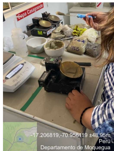
Foto N° 14: Surco abierto con un acanalador normalizado
