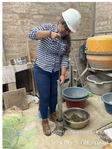
Foto N°26: Golpes de la primera capa de muestra arenosa +RCD
