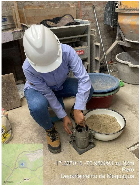
Foto N°23: Llenado de la quinta parte del molde de muestra de suelo arcilloso + RCD
