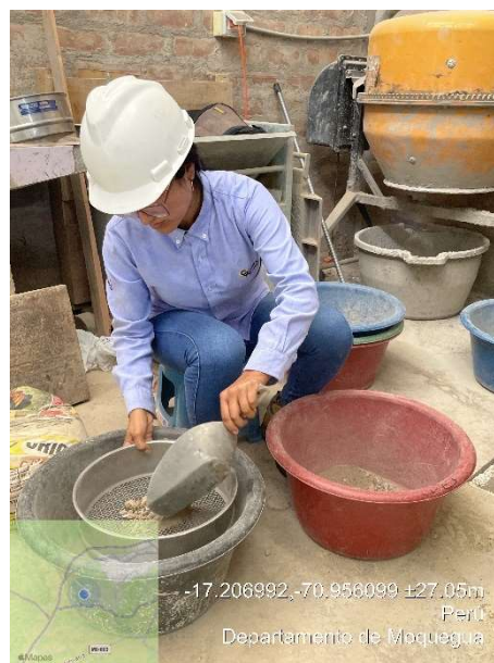
Foto N°20: Tamizado en seco de muestra de suelo arenoso + RCD
