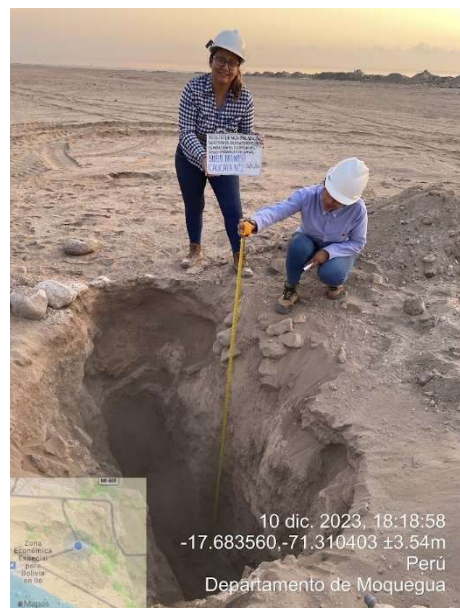
Foto N°04: Calicata N°2 - Suelo arenoso
