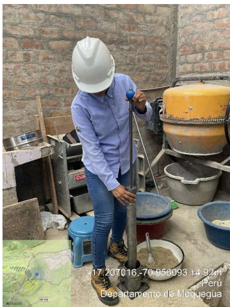
Foto N°25: Golpes de la primera capa de muestra arcillosa +RCD
