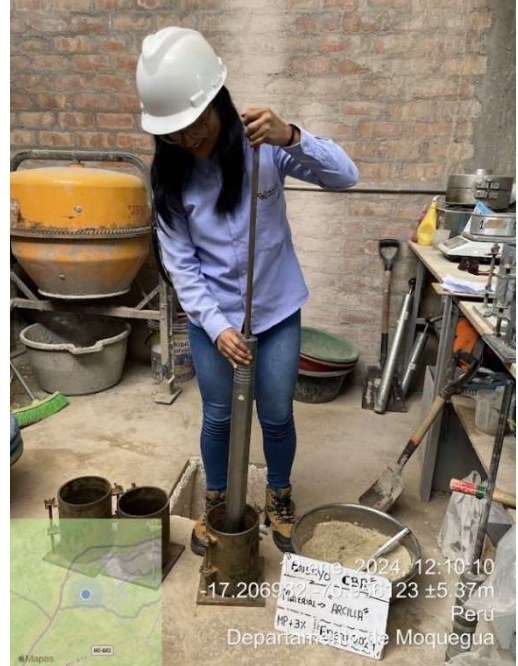
Foto N°28: Golpes de la primera capa de muestra arcillosa +RCD
