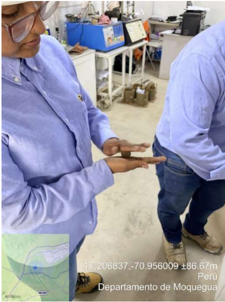
Foto N°15: Suelo que pasa por tamiz #40 mezclado con agua, amasable
