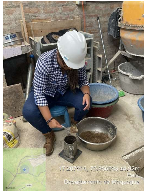
Foto N°24: Llenado de la quinta parte del molde de muestra de suelo arenoso + RCD
