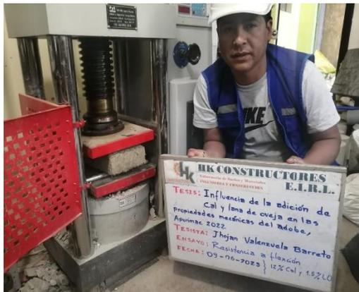
Figura 27. Ensayo a resistencia a flexión de adobe.
