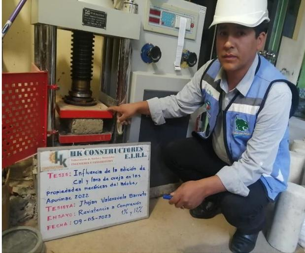
Foto N° 13. Ensayo de resistencia a compresión de adobe.
