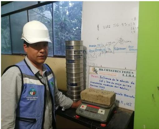
Figura 30. Peso de muestra de adobe en balanza digital.
