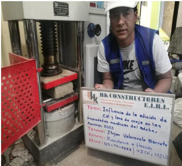
Foto N° 15. Ensayo a resistencia a compresión de adobe.
