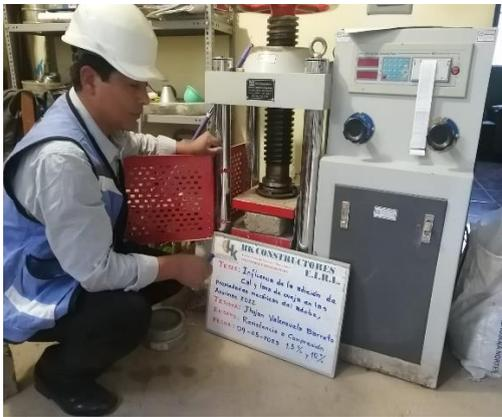
Figura 24. Ensayo a resistencia a compresión de adobe.
