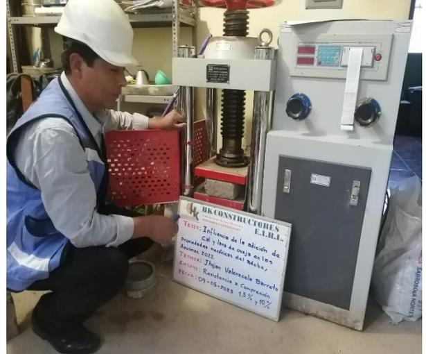
Foto N° 14. Muestra de adobe en la prensa mecánica.
