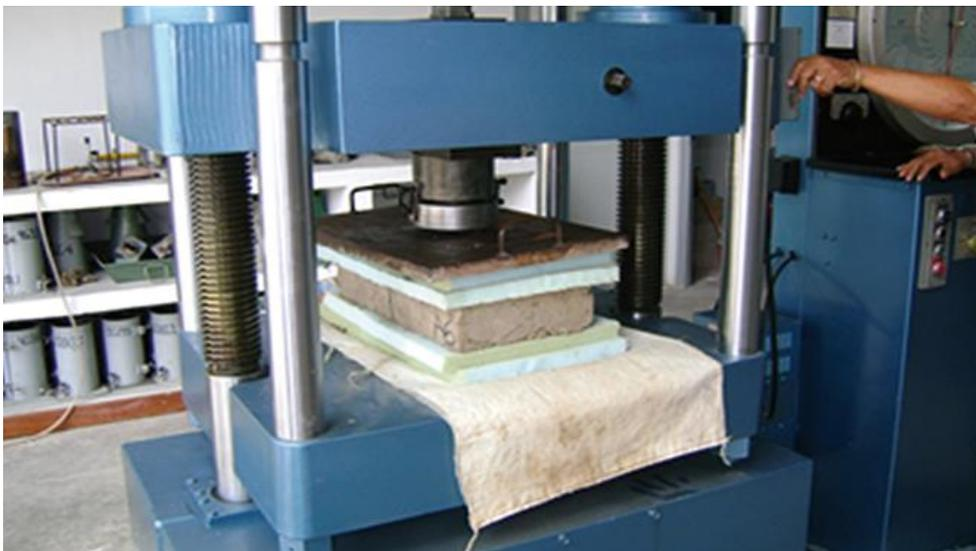
*Figura 6.* Se Observa el laboratorio, donde se realiza el ensayo de resistencia a compresión de unidad de adobe.
