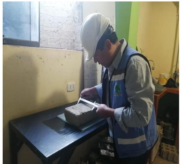
Foto N° 12. Medición de adobe con vernier para control del alabeo.
