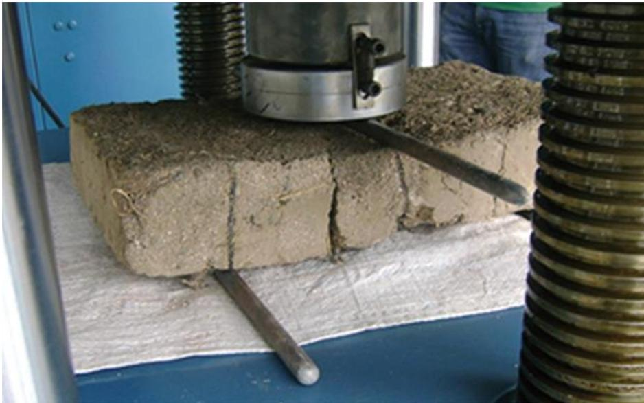
*Figura 7.* Se Observa el laboratorio, donde se realiza el ensayo de resistencia a flexión en unidad de adobe.
