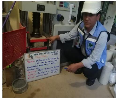
Figura 23. Muestra de adobe en la prensa mecánica.
