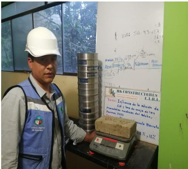
Foto N° 11. Pesaje de adobe en balanza electrónica.
