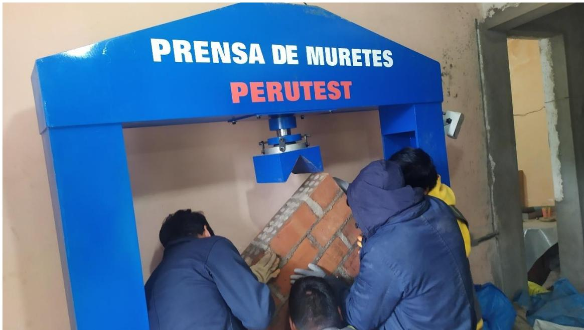
Figura 49.colocación de murete para el ensayo de corte diagonal
