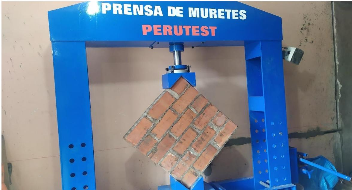
Figura 301. Prensa de muretes para el ensayo de corte diagonal.
