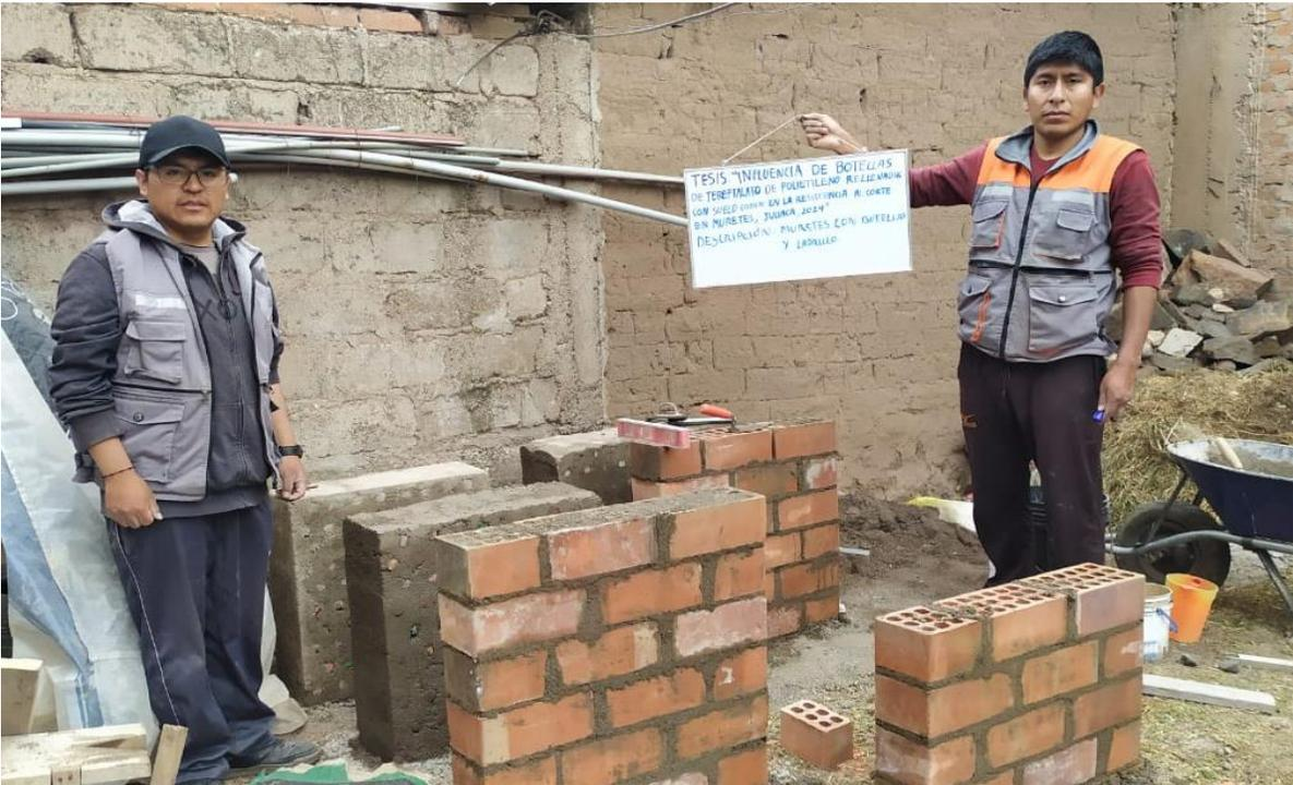
Figura 446. Asentado de muretes, tres especímenes de cada tipo.
