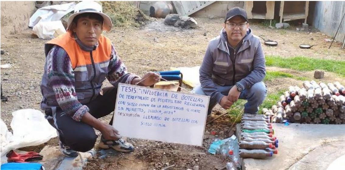
Figura 356. Unidades de botellas PET con suelo común y compactadas
