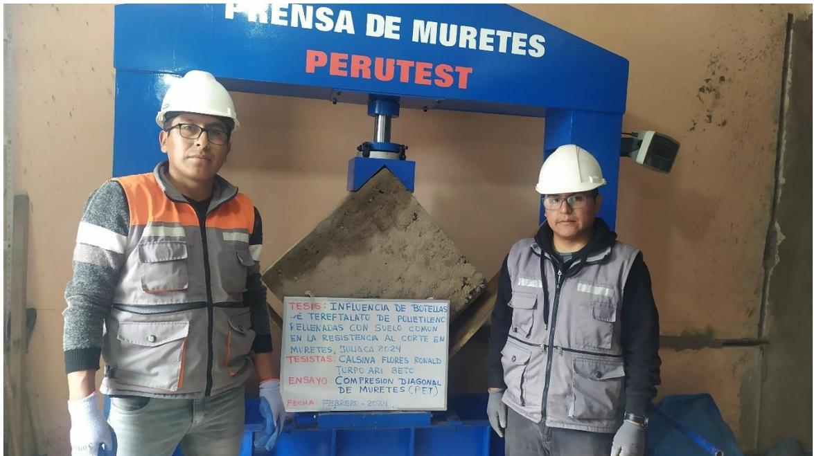
Figura 52. Murete de PET listo para ensayo de compresión diagonal.
