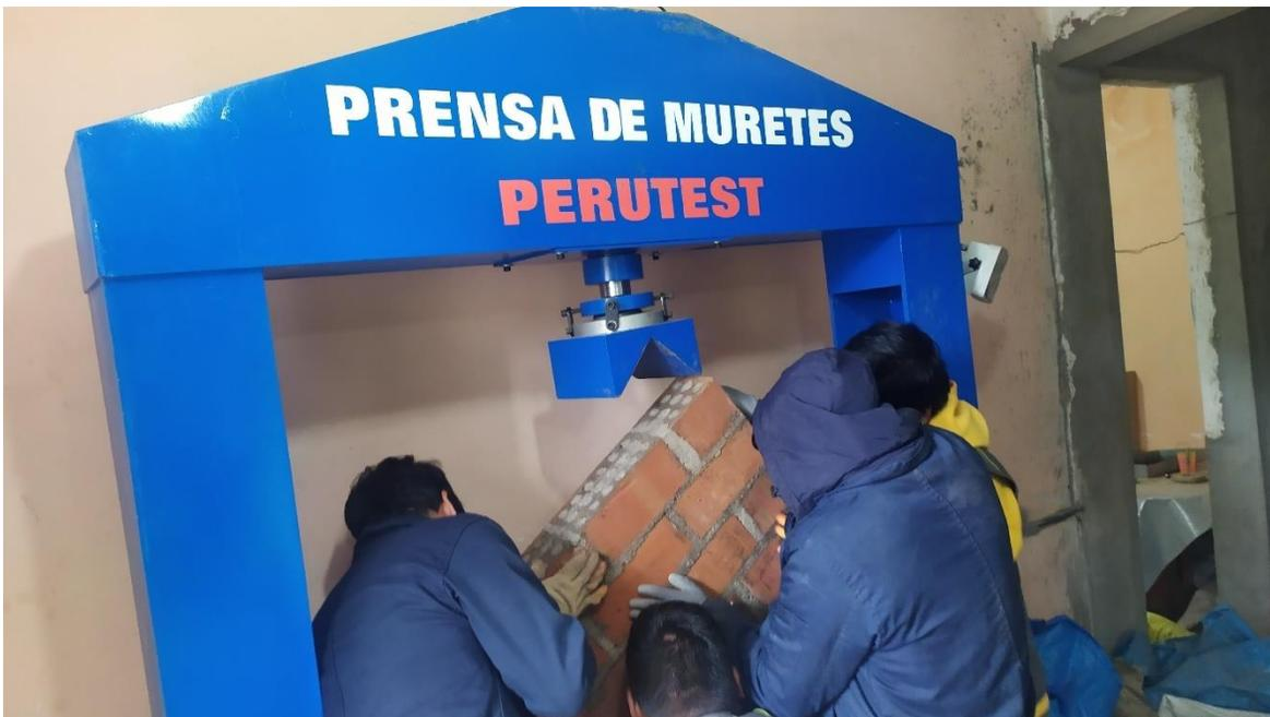
*Figura 48. colocación de murete para el ensayo de corte diagonal*
