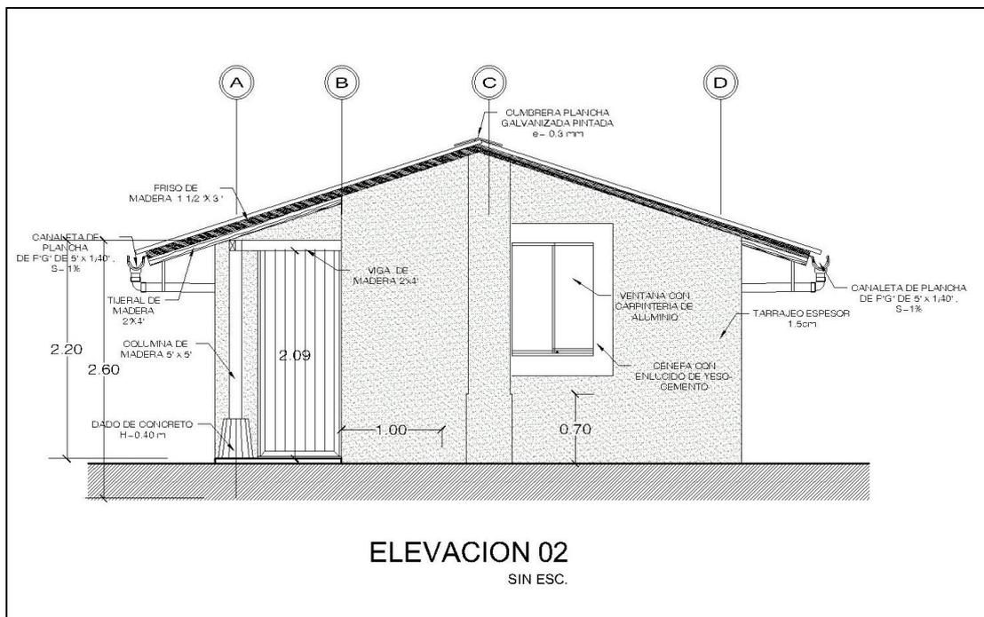
Figura 30. Diseño de vivienda con muros de botellas PET. Vista elevación 02
