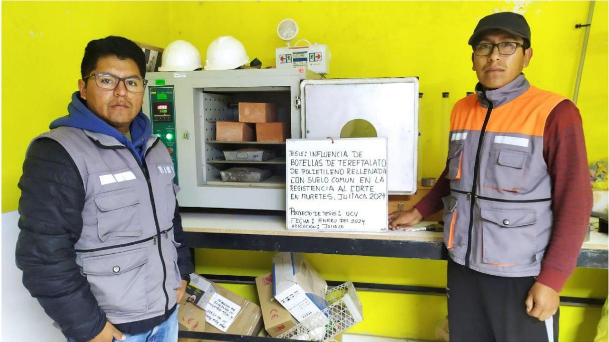
Figura 367. Muestras de suelo común, agregado fino y ladrillos en horno para los ensayos correspondientes
