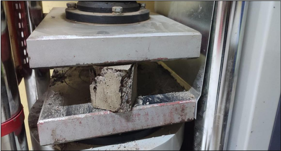
*Figura 457. Compresión de dados del mortero*
