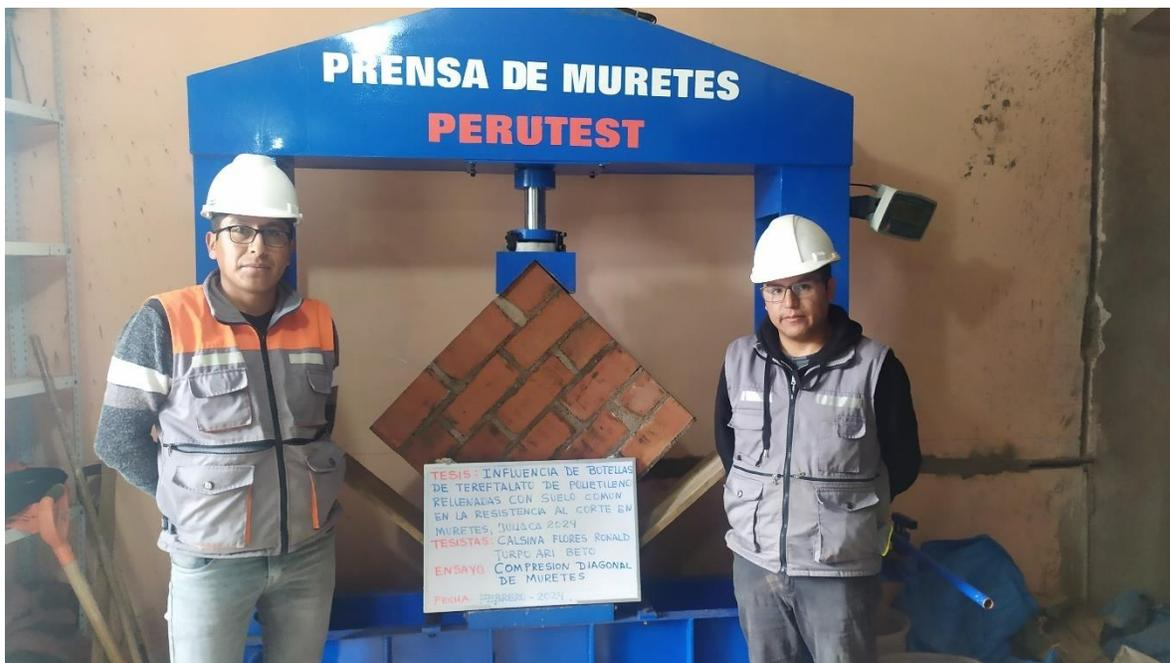
Figura 50. Murete preparado para el ensayo de corte diagonal
