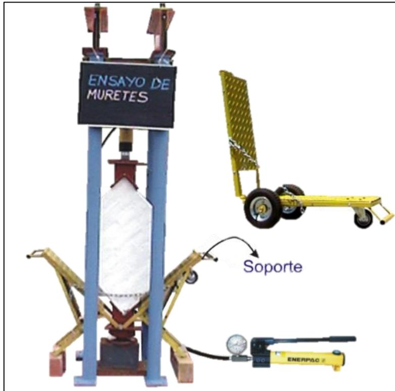
Figura 6. Equipo para realizar el ensayo de compresión diagonal
