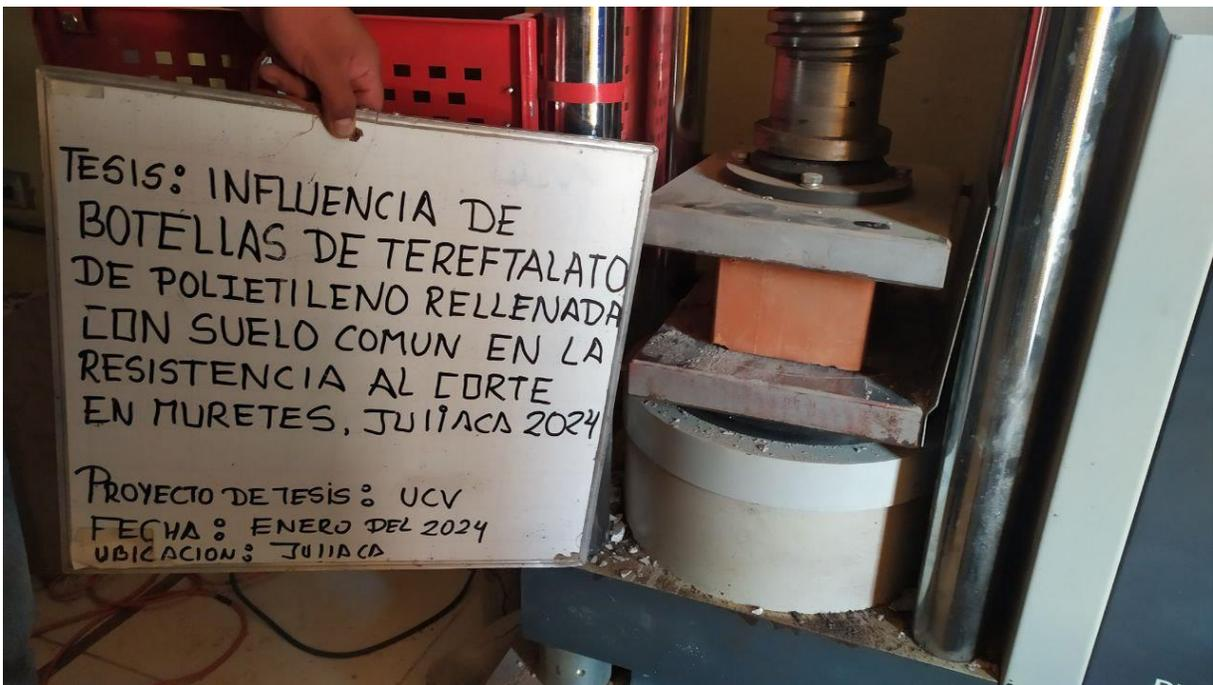
Figura 40. Unidades de ladrillo sometidos a resistencia de compresión
