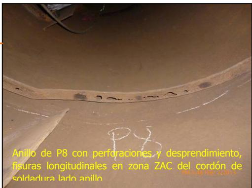
Anillo de P8 con perforaciones y desprendimiento, figuras longitudinales en zona ZAC del cordón de soldadura lado anillo.
