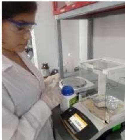
Figura 5. Pesado de Agar-Agar en balanza analítica
