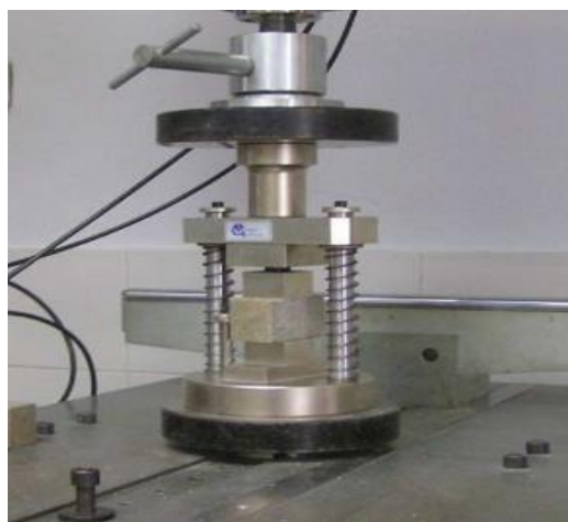
Figura 5. Dispositivo de ensayo a compresión
