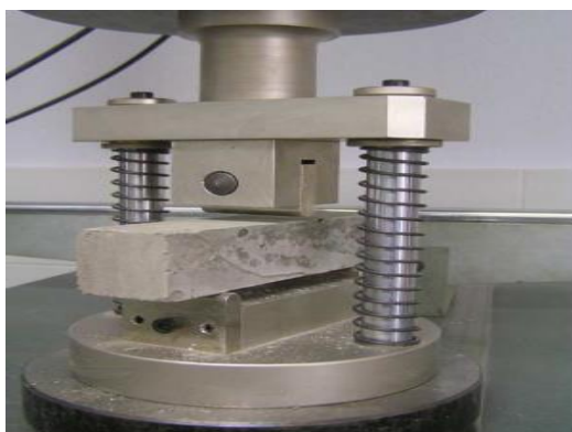
Figura 6. Dispositivo de ensayo a flexión
