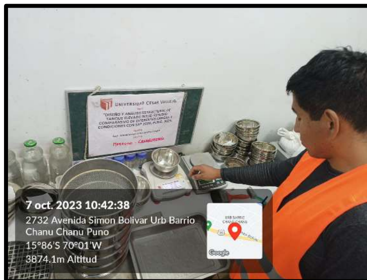
Figura 14 : Medición de la humedad y análisis de la granulometría
