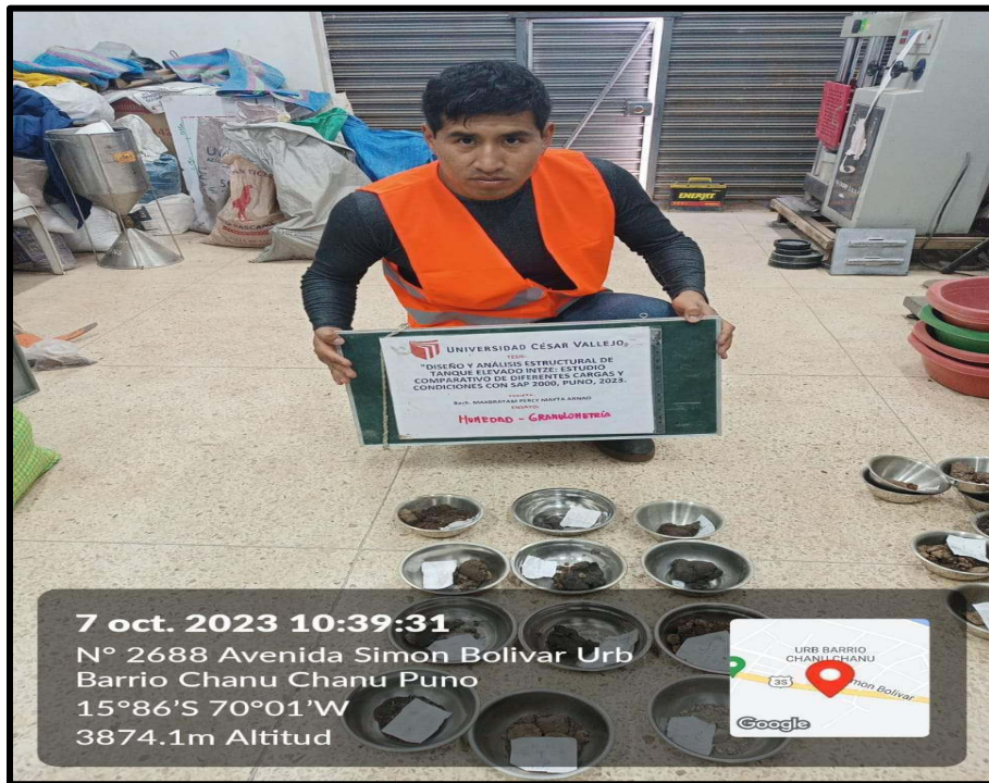
Fotografía N° 16: Separación en recipientes para determinación de límites aterbeg.
