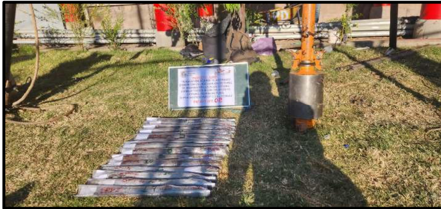
Fotografía N° 12: Muestra del ensayo SPT-3.
