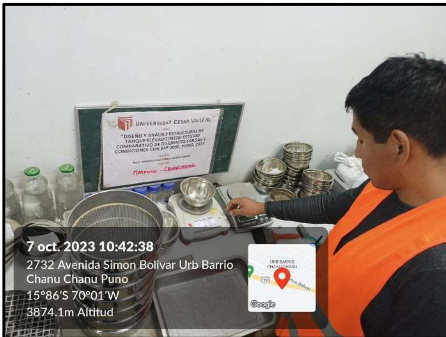
Fotografía N° 13: Realización del ensayo granulométrico pesaje de las muestras.
