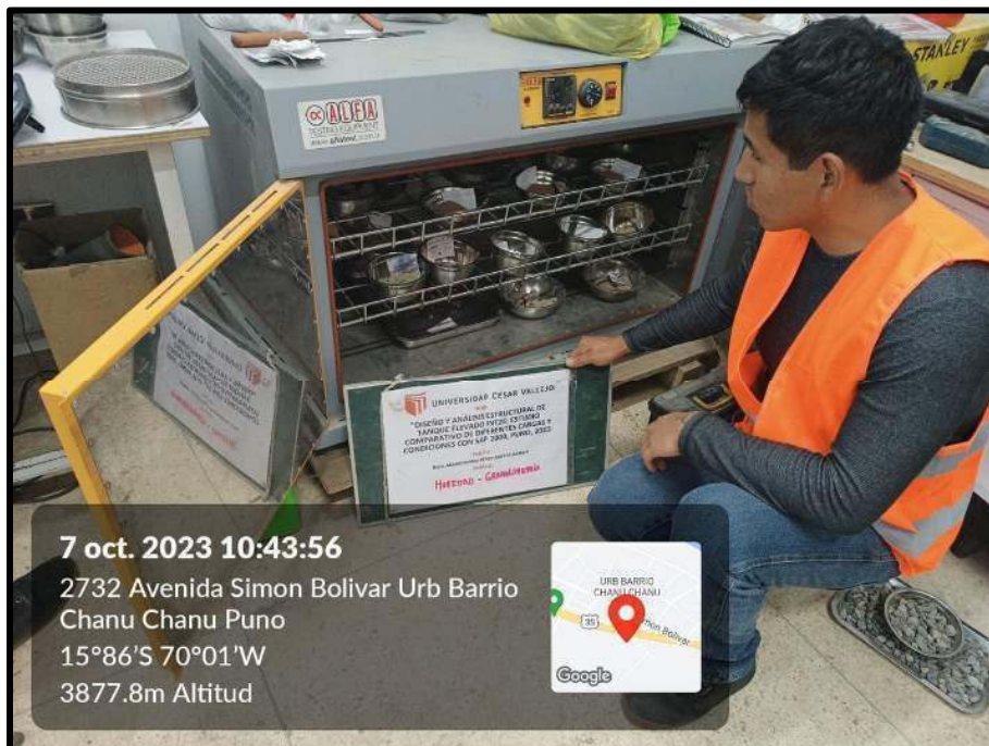
Fotografía N° 17: Colocación al horno para determinar el contenido de humedad.
