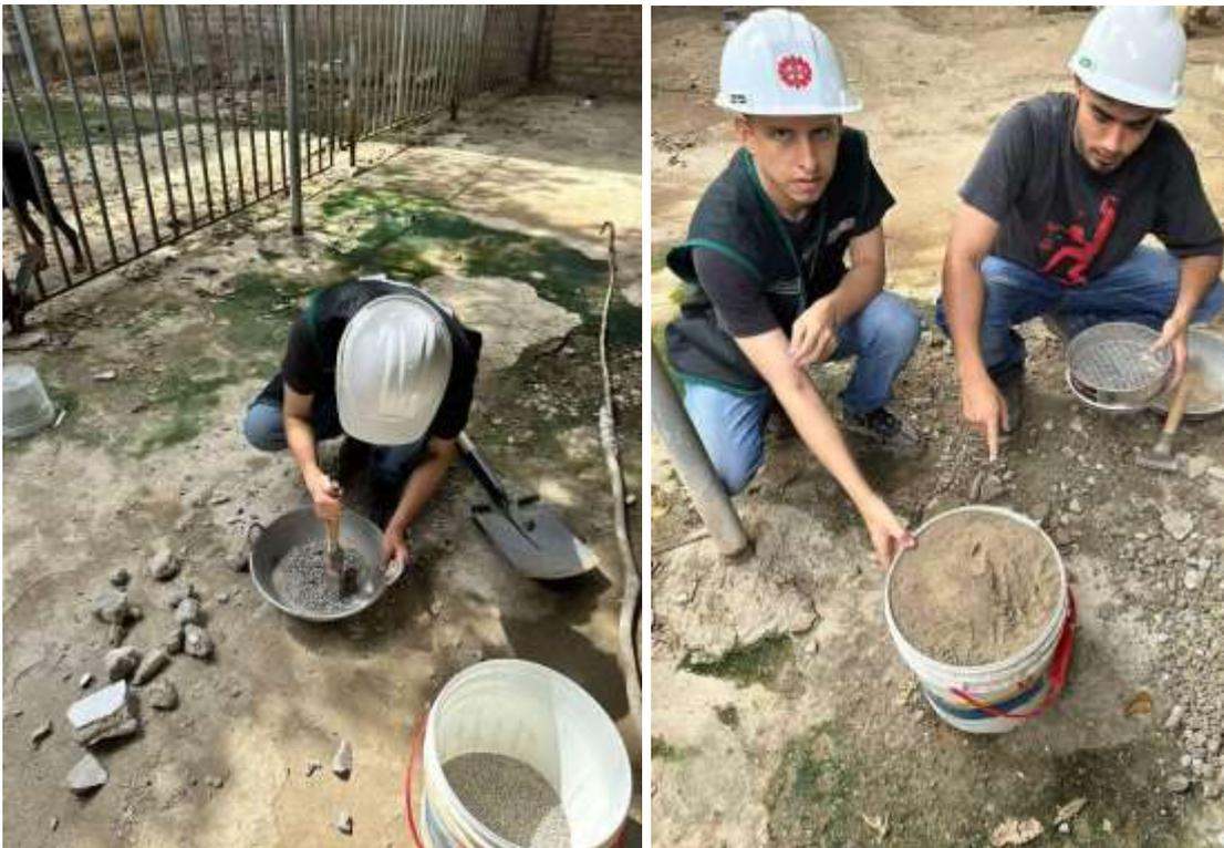
Figura 15. Molido y tamizado del material de construcción reciclado para ser aplicado al suelo natural.
