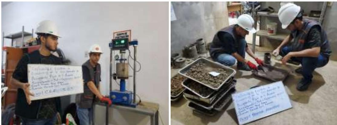
Figura 18. Ensayos de Proctor modificado y C.B.R. del suelo de sub rasante
