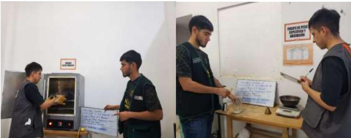
Figura 16. Ensayo de contenido de humedad y peso específico del suelo.
