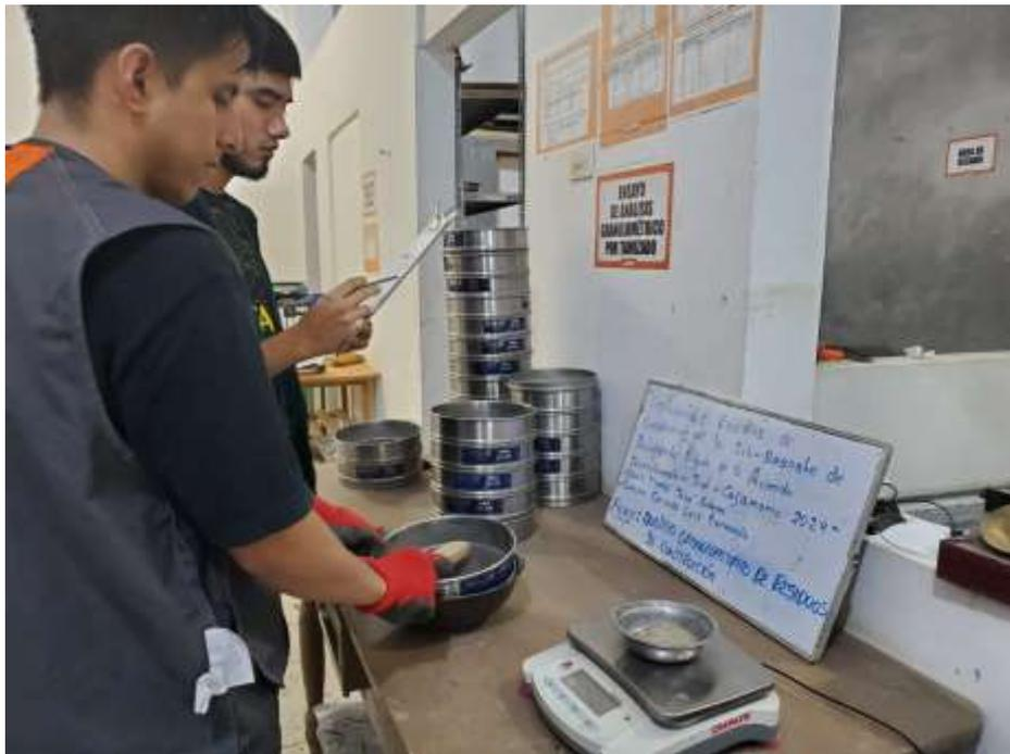
Figura 17. Análisis granulométrico del material de residuos de construcción.
