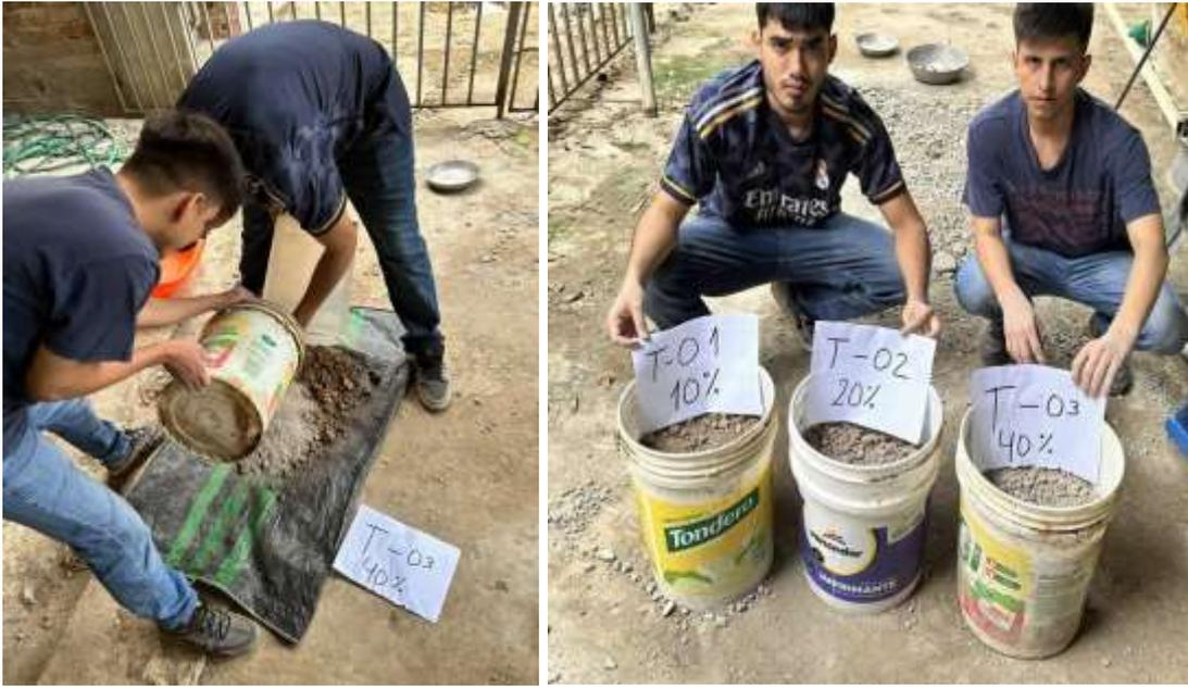
Figura 16. Mezcla del suelo natural con los residuos de construcción procesados según los tratamientos planteados, para ser llevados a laboratorio.
