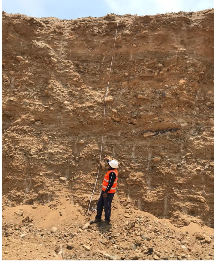
Figura 26. Medición de longitud del perfil estratigráfico en Cantera el Arenal
