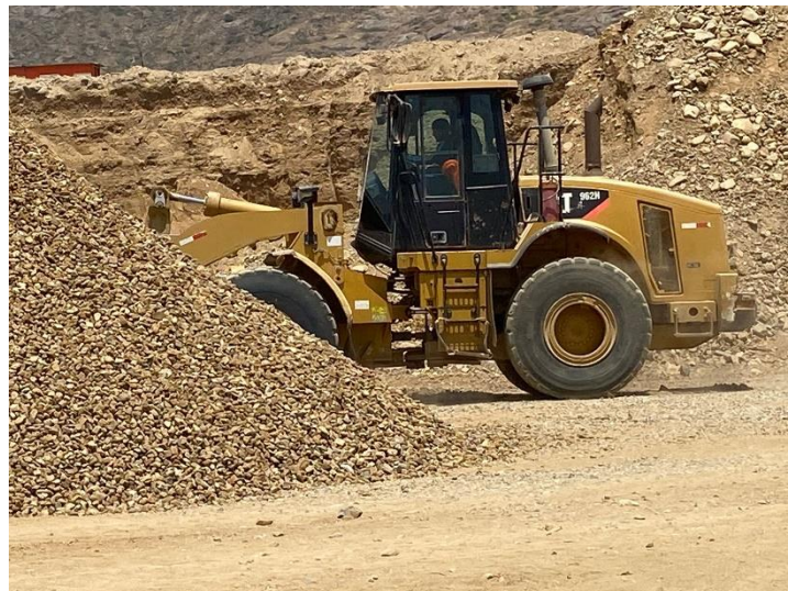
Figura 29. Cargador Frontal Modelo 962H en operaciones de las labores de la Cantera El Arenal
