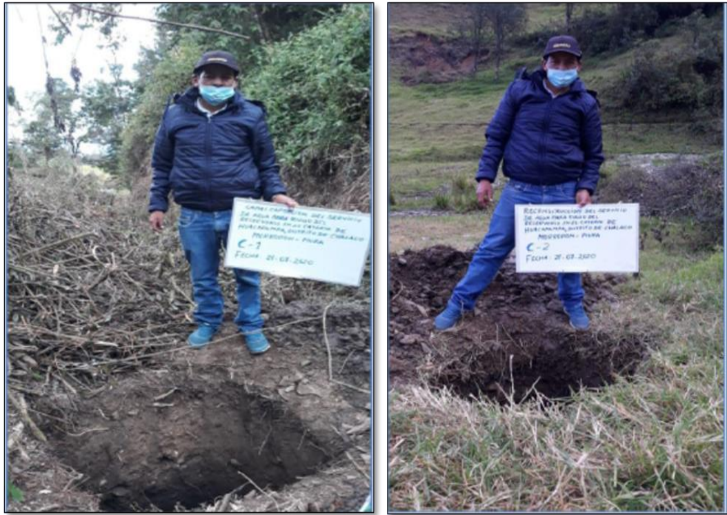
Foto N° 03: Calicatas realizadas para la investigación.
