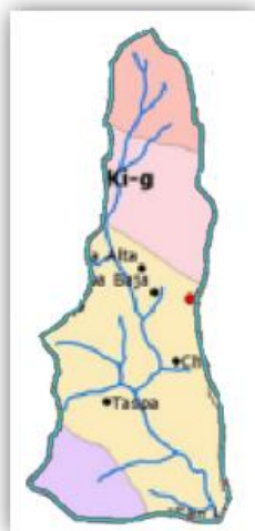
FIGURA N° 2. 5: ORDEN DE LAS CORRIENTES DE AGUA: MICROCUENCA DE APOORTE LOS POTROS: SISTEMA DE RIEGO HUACAPAMPA.
