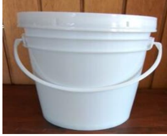
Figura 4. Balde de 4 litros usado para aforar. Tomado de (Suarez, 2018); (20)
