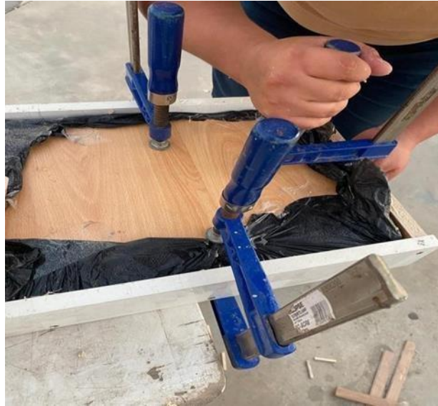
Figura N° 4 Compactación de la masa siendo compactada
