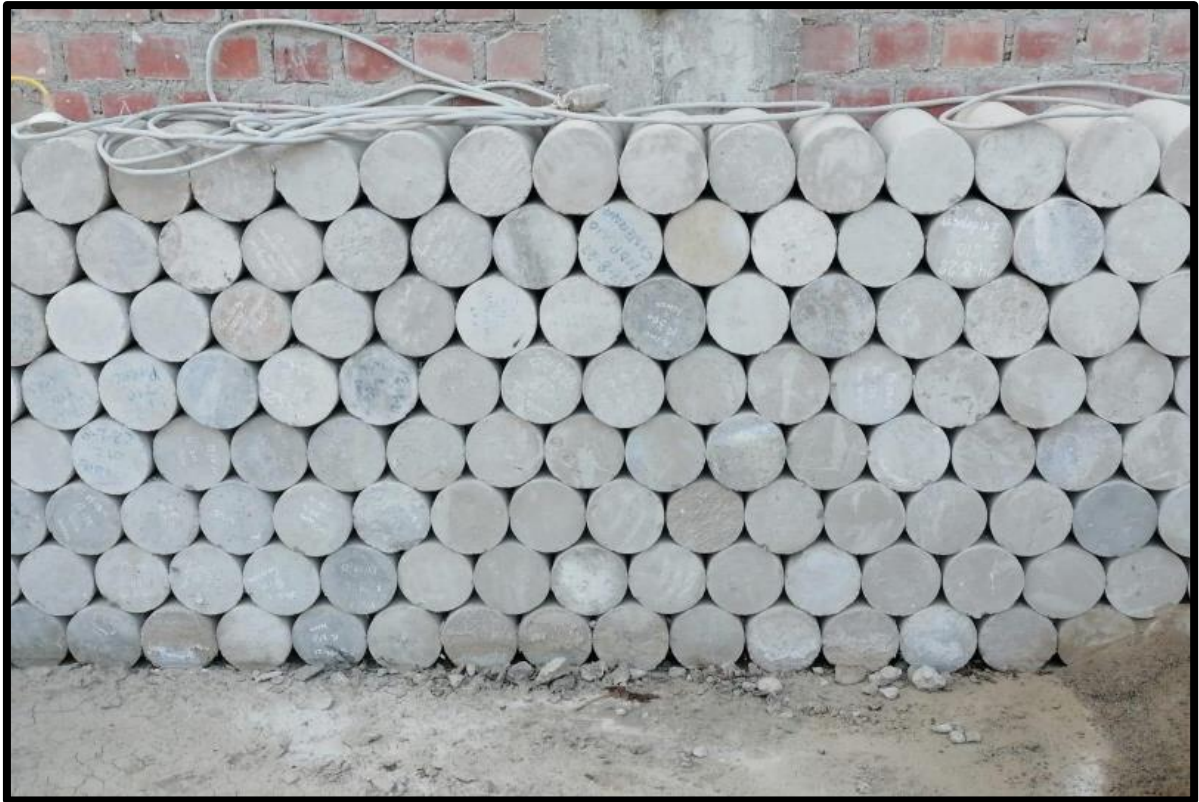
FOTOGRAFÍA 5. RECOLECCIÓN DE CONCRETO RECICLADO (PROBETAS F'_c= 210 kg/cm 2 )
