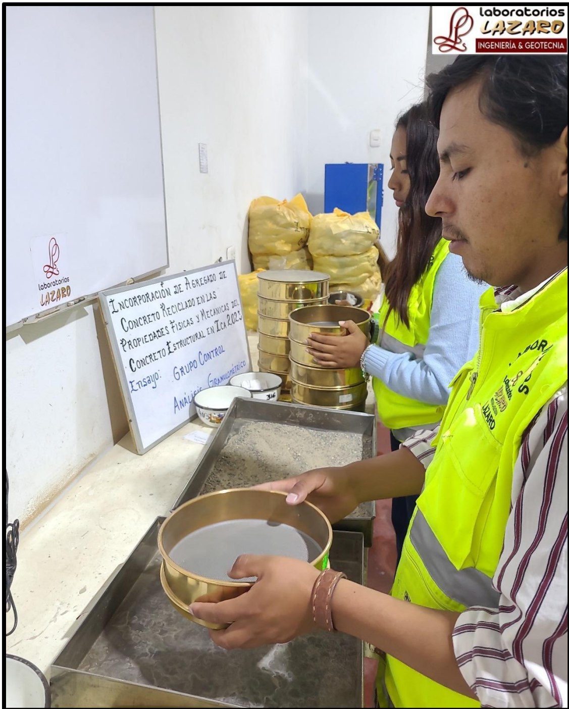
FOTOGRAFÍA 9. GRANULOMETRÍA PARA AGREGADOS
