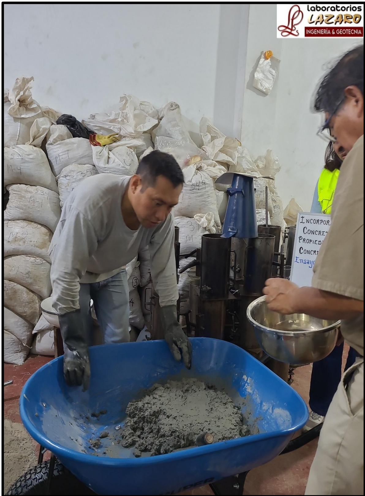
FOTOGRAFÍA 14. MEZCLA DE CONCRETO PARA ENSAYO SLUMP Y TESTIGOS CILINDRICOS.
