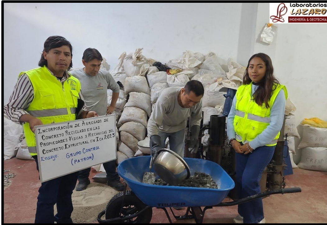
FOTOGRAFÍA 15. MEZCLA DE CONCRETO PARA ENSAYO SLUMP Y TESTIGOS CILINDRICOS.
