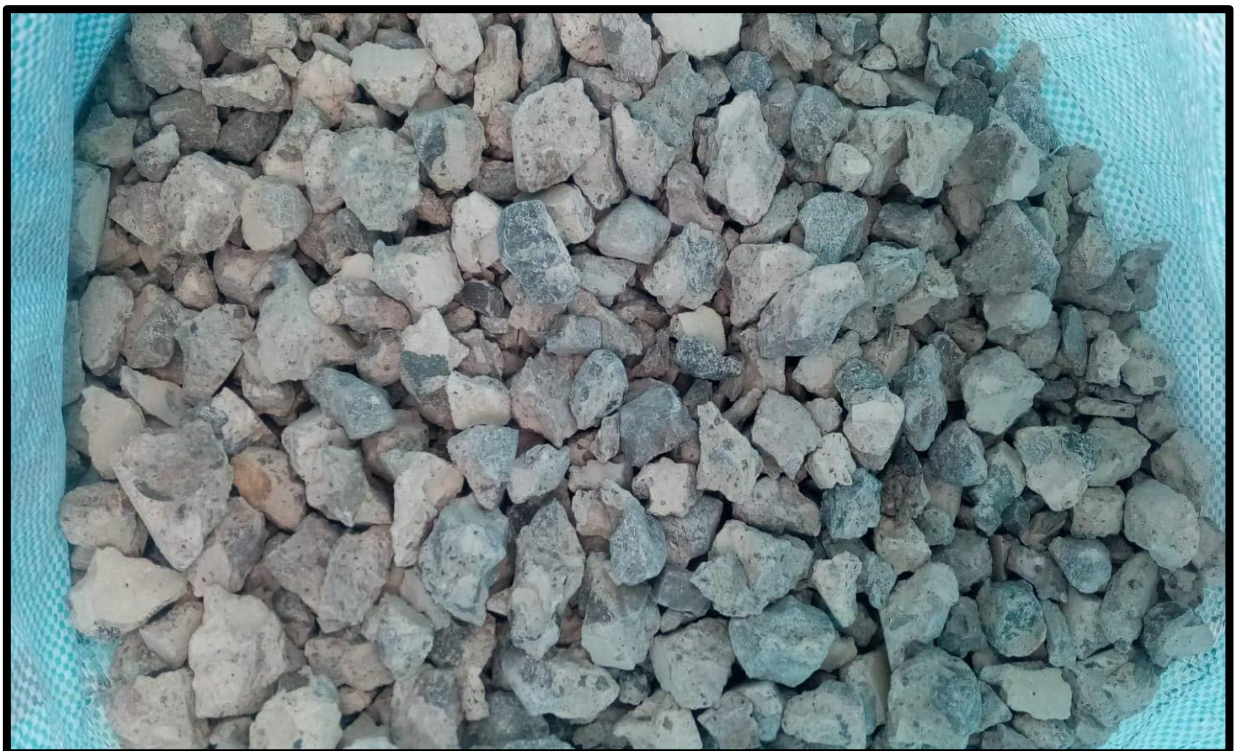
FOTOGRAFÍA 6 . CONCRETO RECICLADO (PROBETAS TRITURADAS)
