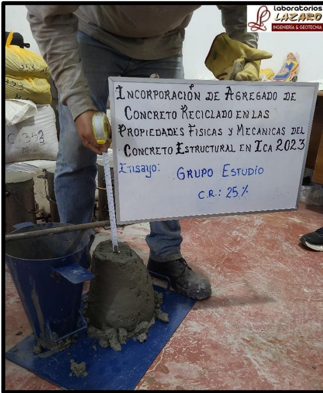
FOTOGRAFÍA 17. ENSAYO DE CONO DE ABRAMS PARA DETERMINAR EL ASENTAMIENTO.
