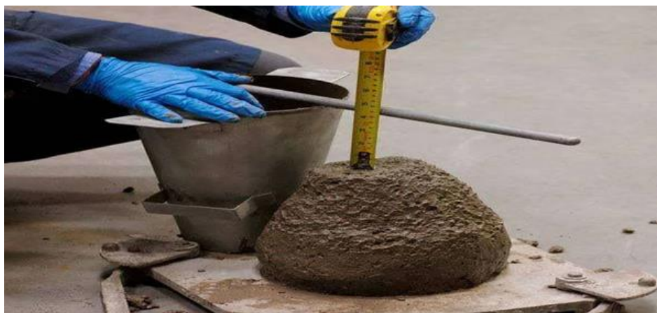
Figura 8. Medición del asentamiento del concreto mediante la prueba del slump
