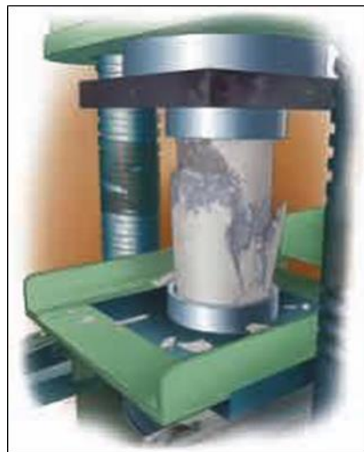
Figura 7. Briqueta sometida a carga de compresion.
