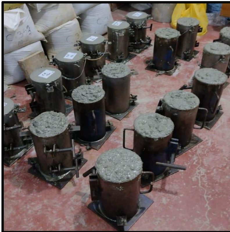
FOTOGRAFÍA 18. MOLDEO DE TESTIGOS CILINDRICOS CON PORCENTAJE DE CONCRETO RECICLADO.
