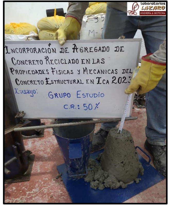
FOTOGRAFÍA 17. ENSAYO DE CONO DE ABRAMS PARA DETERMINAR EL ASENTAMIENTO.
