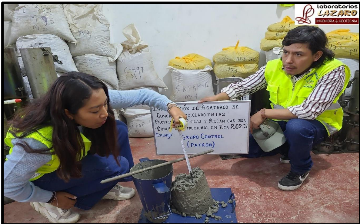
FOTOGRAFÍA 16. ENSAYO DE CONO DE ABRAMS PARA DETERMINAR EL ASENTAMIENTO.
