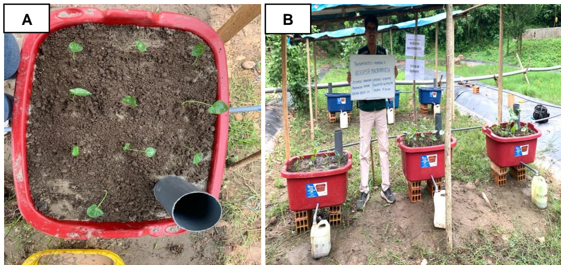
Figura 3. Instalación de tubos de oxigenación en los humedales artificiales
