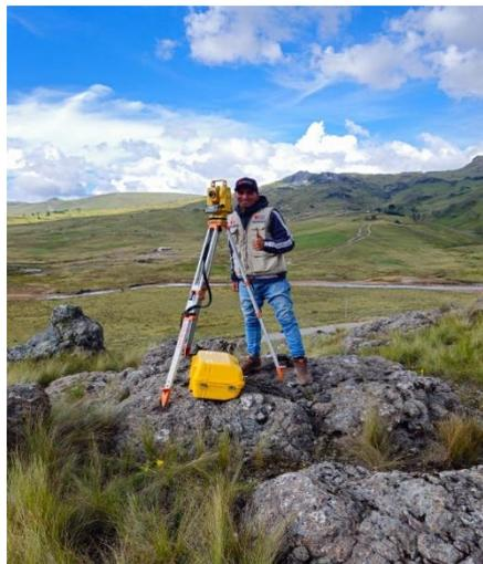
Figura 11: Punto de cambio para georreferenciar la estación total.
