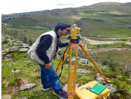
Figura 6: Georreferencia entre prisma y estación total.
