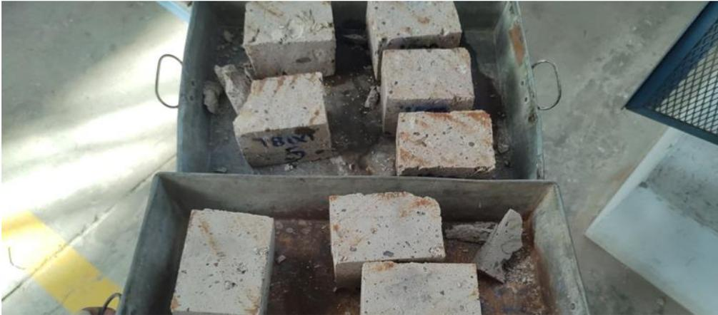
**Figura 15.** Extracción y elaboración de cubos de sillar
