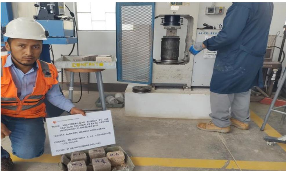
**Figura 16.** Ensayo de compresión del sillar
