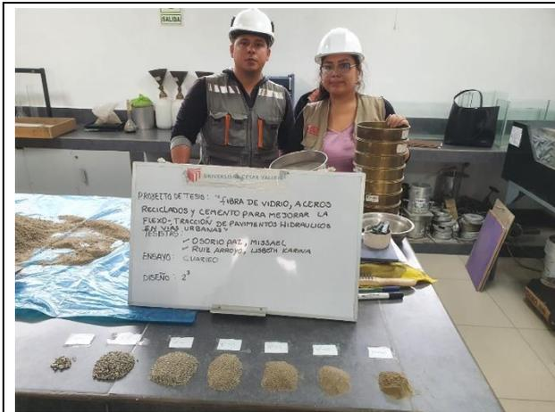
Ensayo granulométrico agregado fino.
