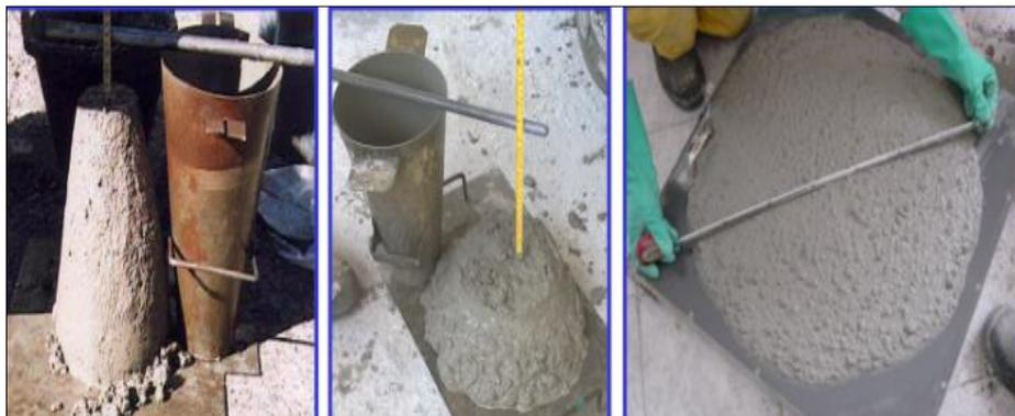
*Figura 11.* Prueba de slump
