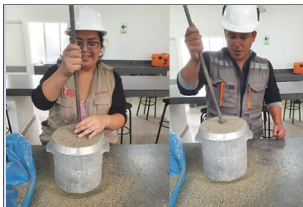
*Figura 21.* Ensayo de peso unitario para agregado fino-arena
