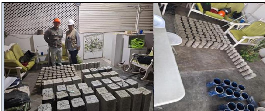
*Figura 36.* Desmoldado de briquetas.
