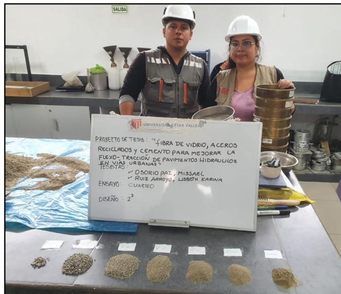
*Figura 27. Ensayo de granulometría para agregado fino-arena.*
