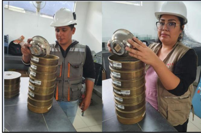
*Figura 24. Ensayo de granulometría – agregado fino.*
