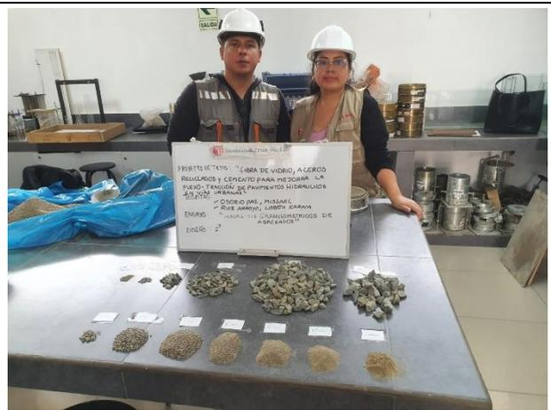
Ensayo granulométrico agregado grueso.
