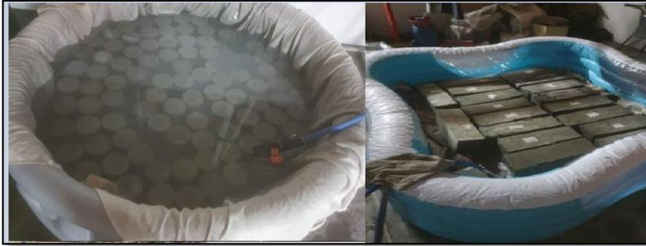
*Figura 37. Curado de briquetas.*
