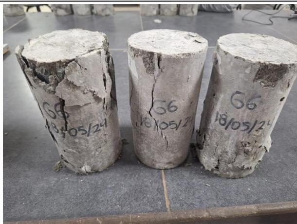
**Rotura de especímenes, ensayo a tracción indirecta**
