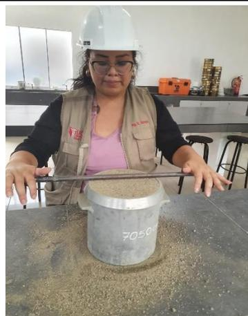
Ensayo de peso suelto del agregado fino.
