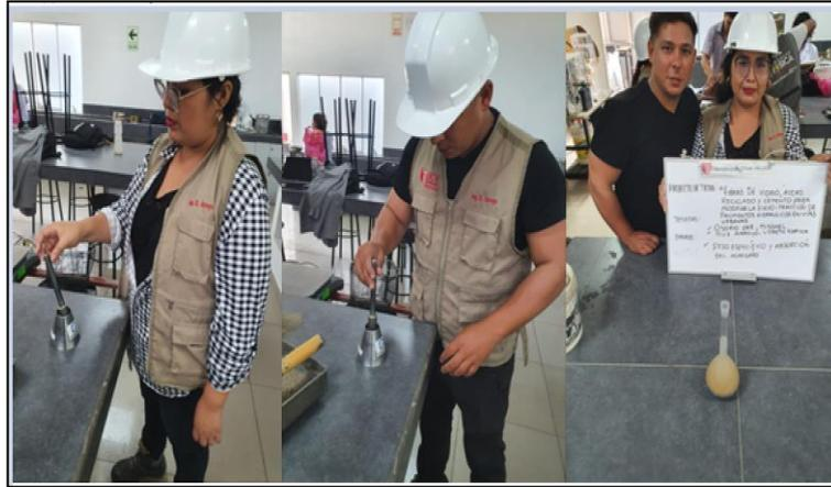
*Figura 22.* Ensayo de absorción de agregado fino
