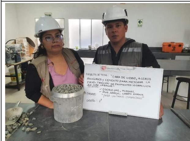
Ensayo de peso compactado del agregado grueso.
