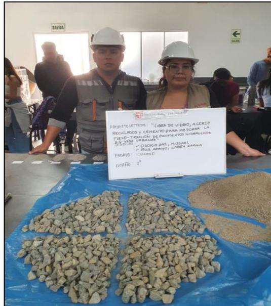
*Figura 26. Cuarteo de agregado grueso*
