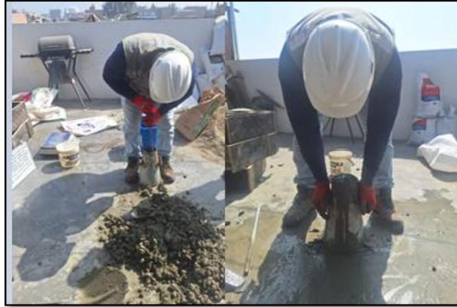
*Figura 33.* Ensayo de Slump.
