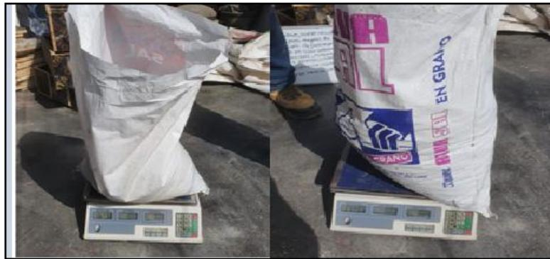
*Figura 29.* Pesado de materiales para el mezclado.
