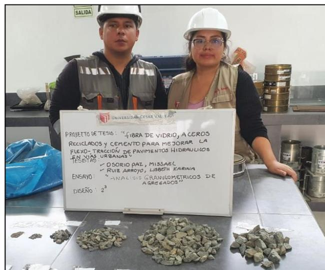
*Figura 25. Ensayo de granulometría - agregado grueso.*
