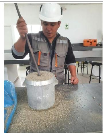
Ensayo de peso compactado del agregado fino.
