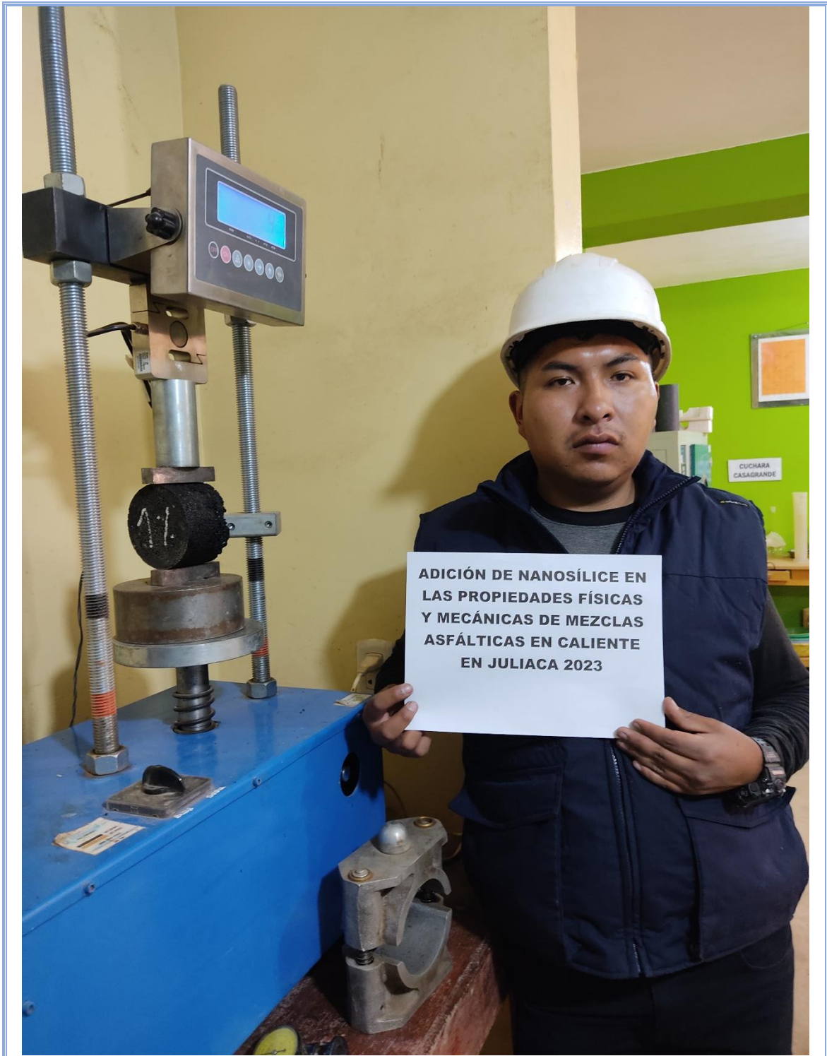
Ensayo de tracción indirecta en muestra de 0%, 0.5% y 1% de adición de nanosilice en mezclas asfálticas en caliente
