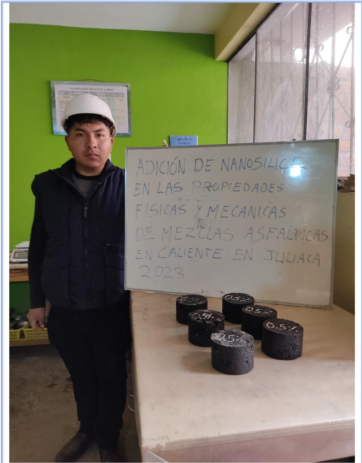
Muestras con 0.5% de adición de nanosilíce para ensayo de tracción indirecta
