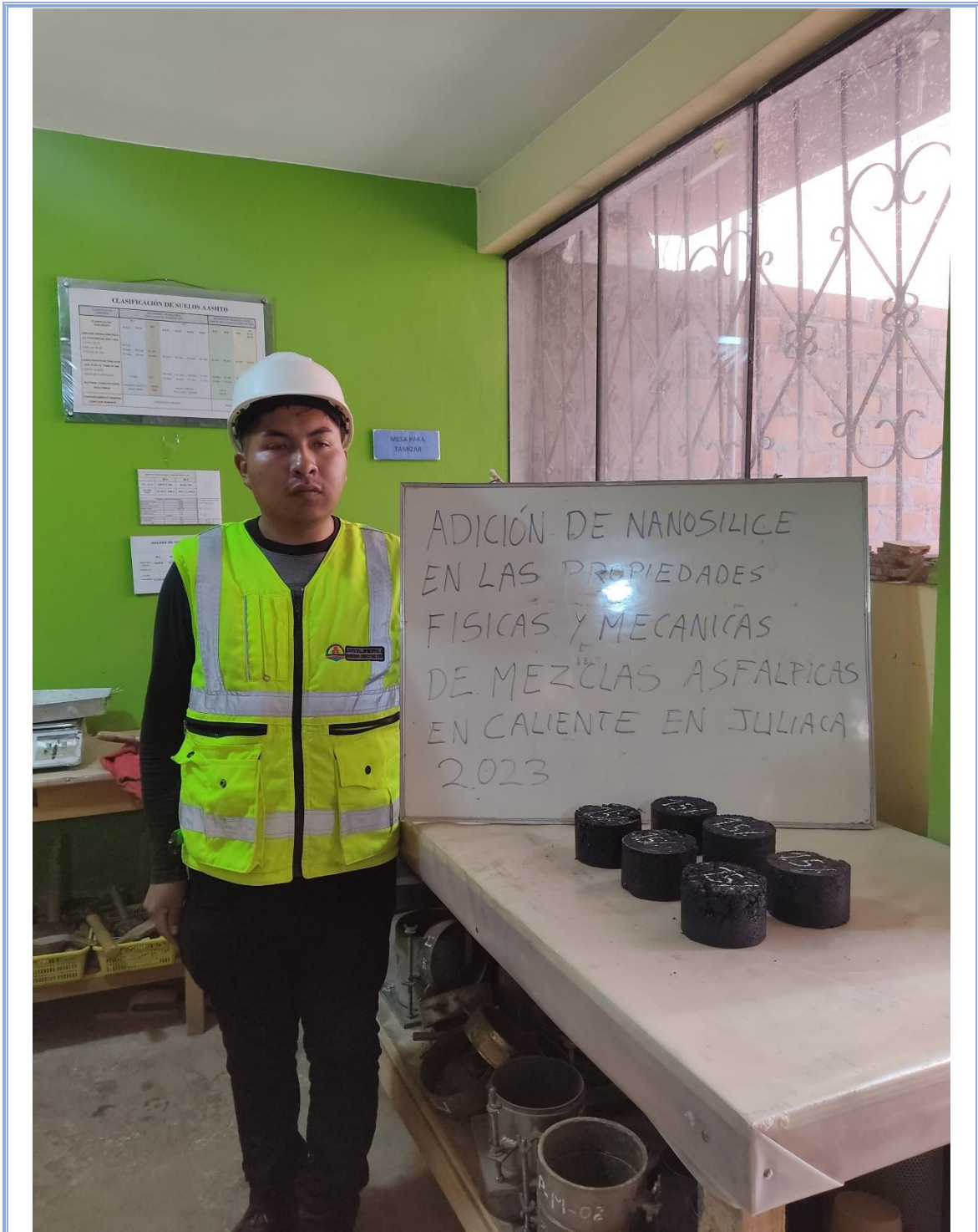
Muestras con 1.5% de adición de nanosilice para ensayo de tracción indirecta
