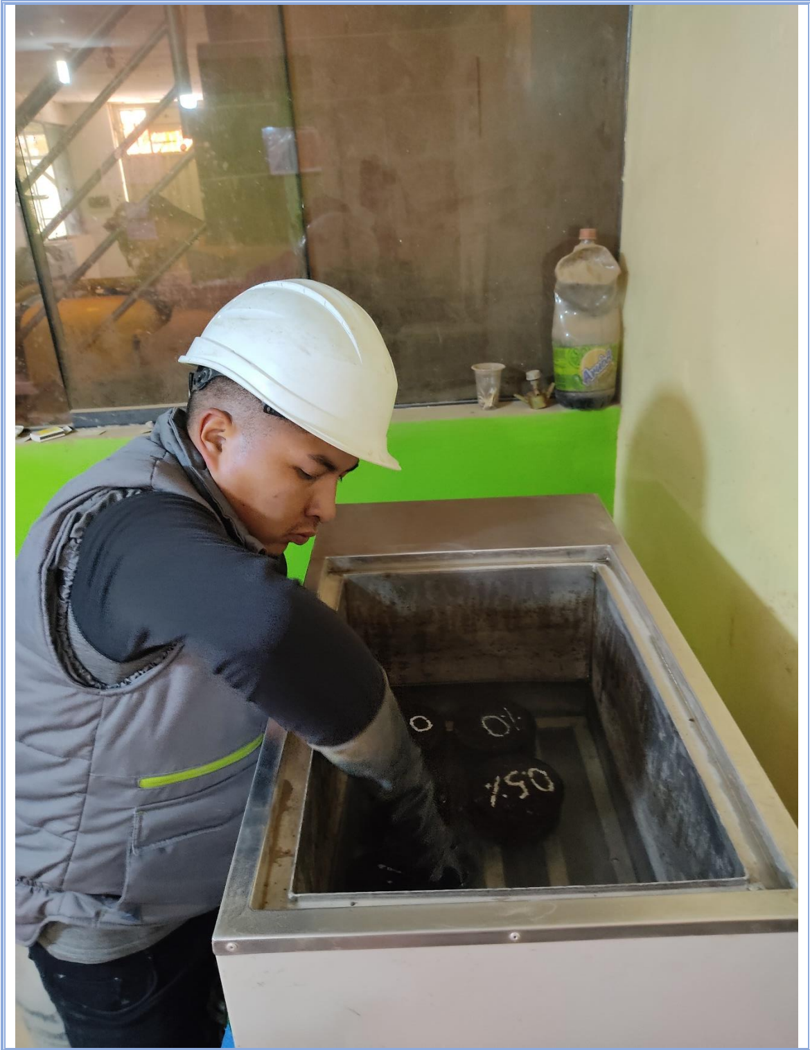
Inmersión de muestras asfálticas en caliente en baño maría para realizar ensayos de estabilidad y flujo Marshall.
