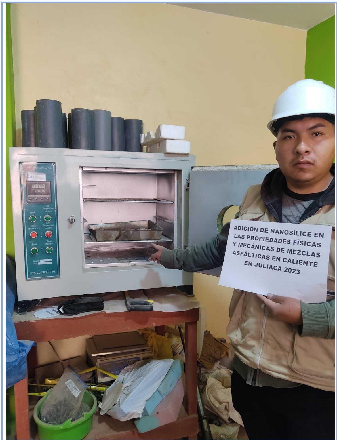
Proceso de secado de las muestras de agregados en horno
