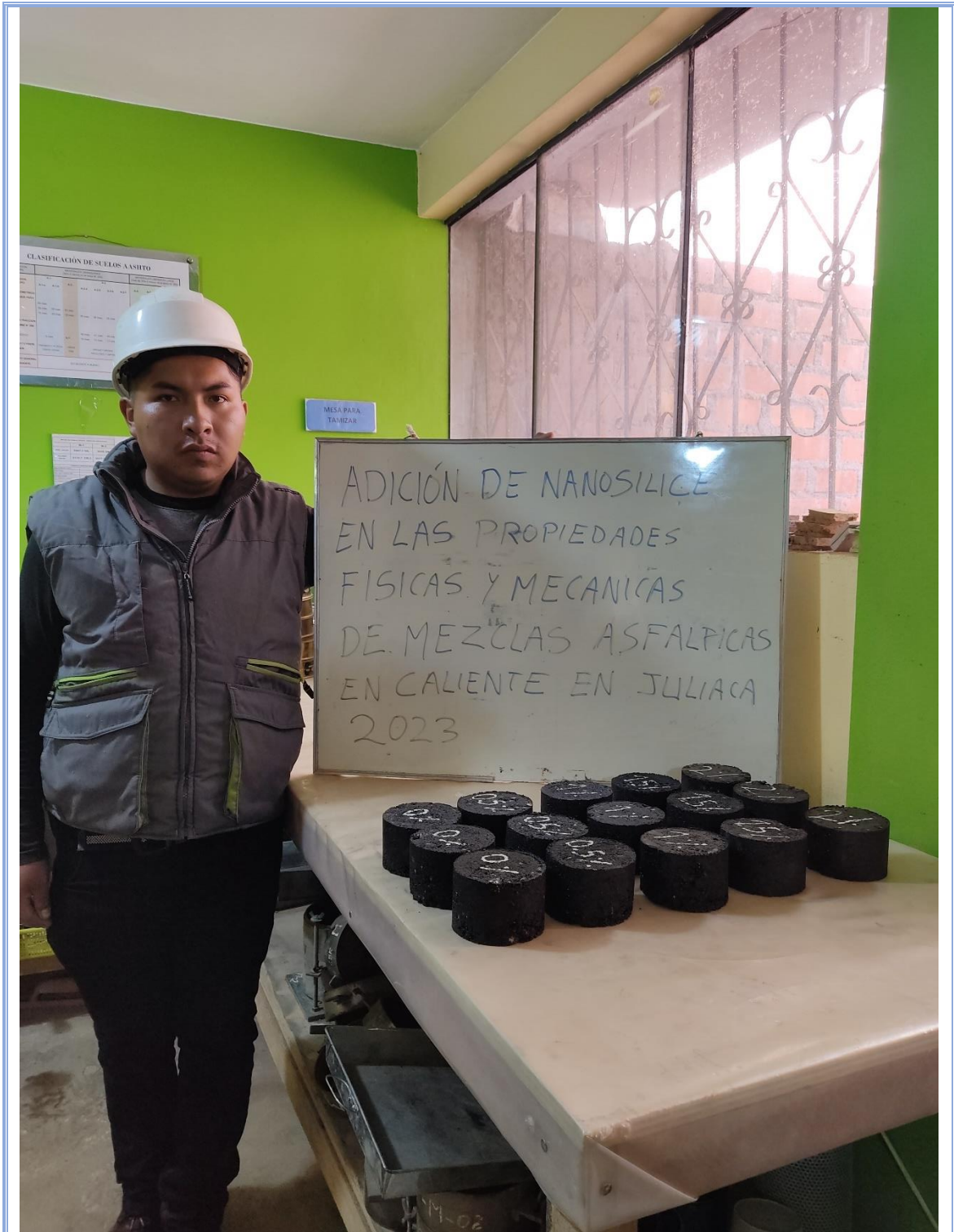
Muestras de mezcla asfáltica en caliente con adición de 0%, 0.5%, 1%, 1.5% y 2% de nanosílice para realizar el ensayo de estabilidad y flujo Marshall
