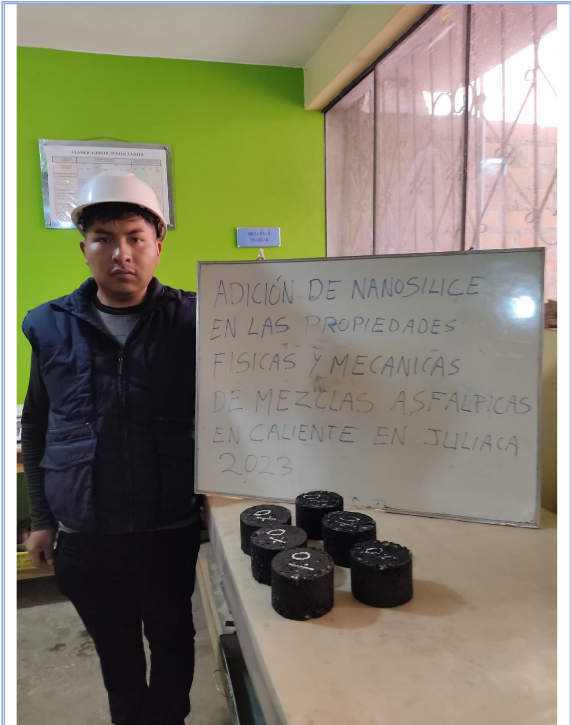
Muestras con 0% de adición de nanosilice para ensayo de tracción indirecta
