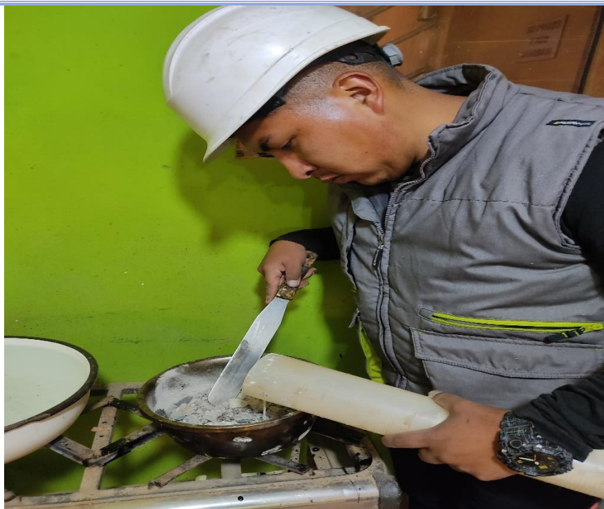
Adición de nanosilíce en el proceso de mezclado para elaborar probetas
