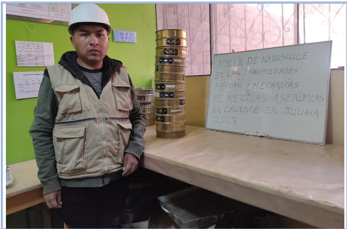
Juego de tamiz utilizado para seleccionar las muestras de los ensayos
