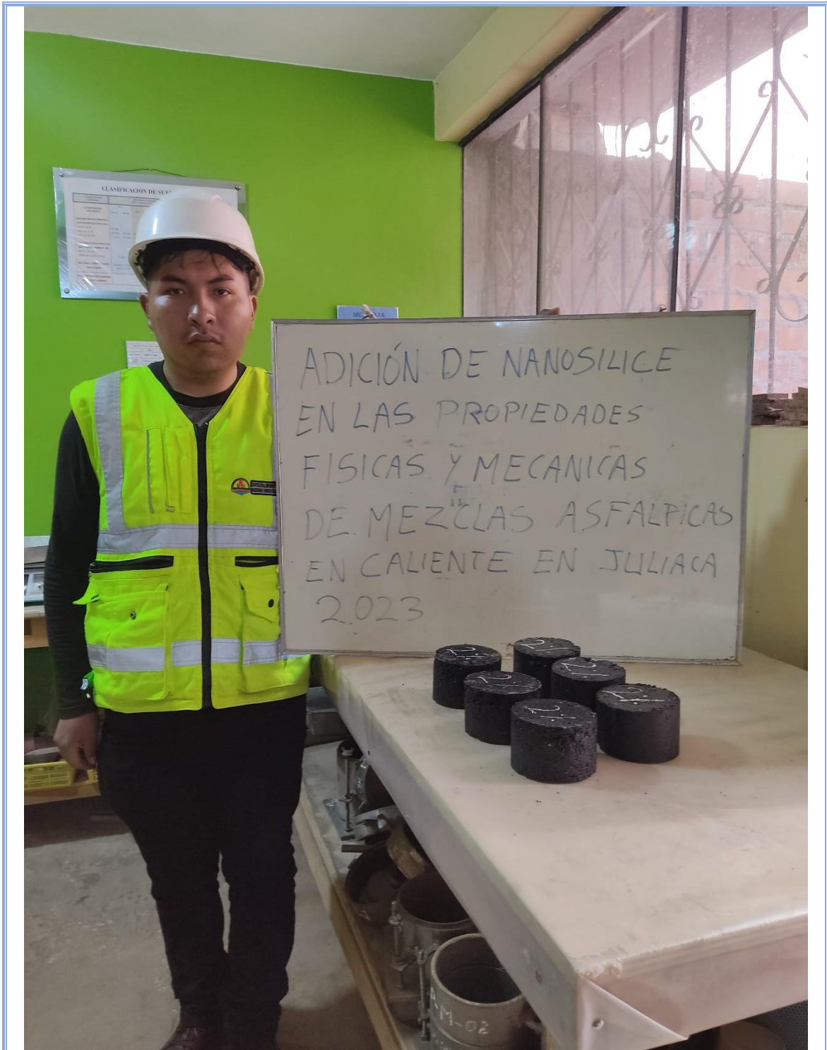
Muestras con 2% de adición de nanosilice para ensayo de tracción indirecta
