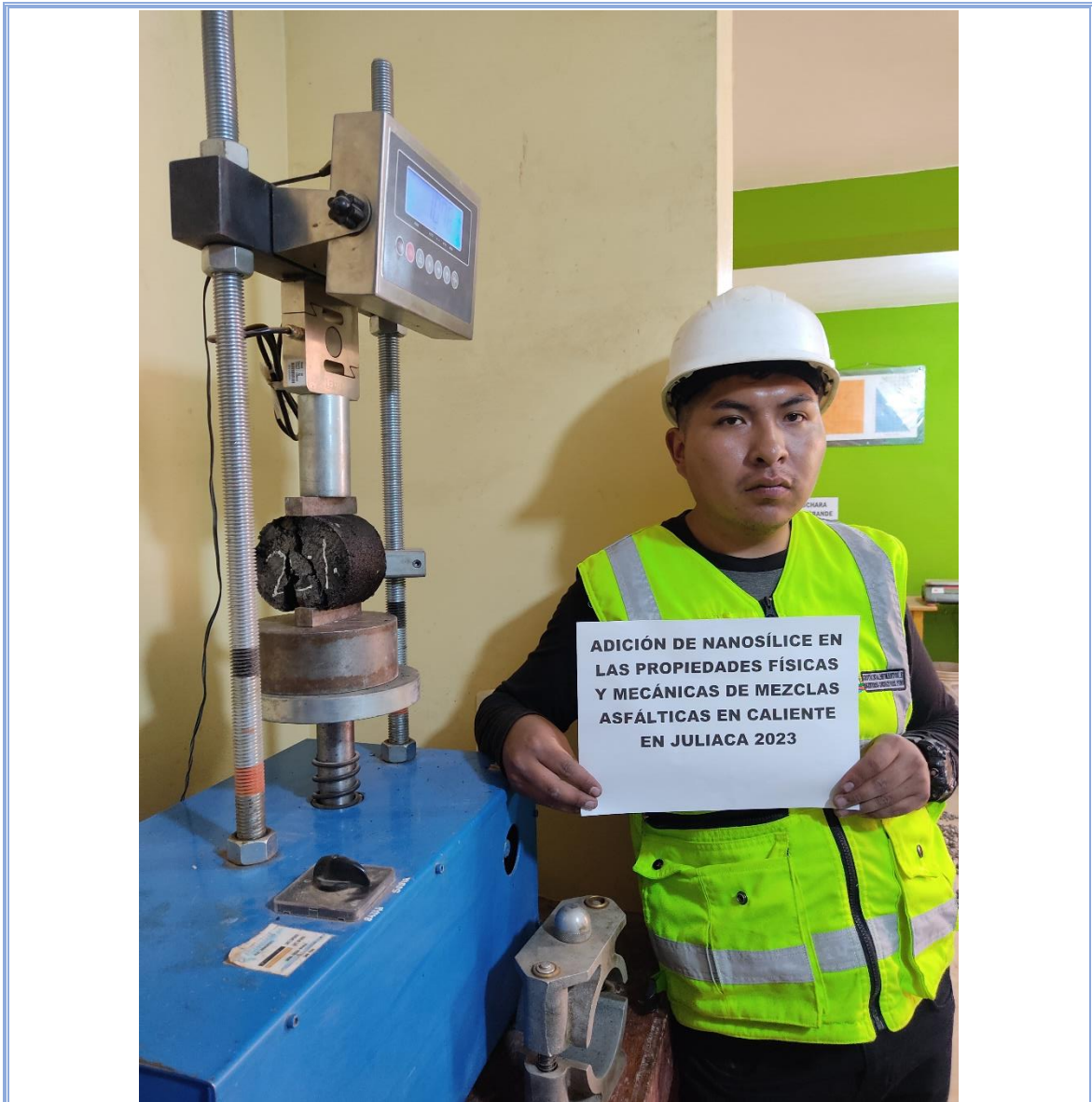
Ensayo de tracción indirecta en muestras de 1.5% y 2% de adición de nanosílice en mezclas asfálticas en caliente
