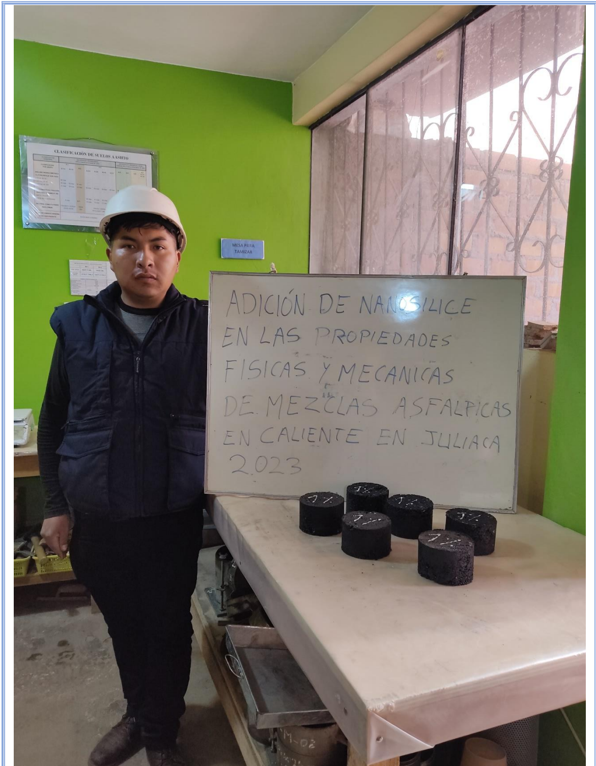
Muestras con 1% de adición de nanosilice para ensayo de tracción indirecta
