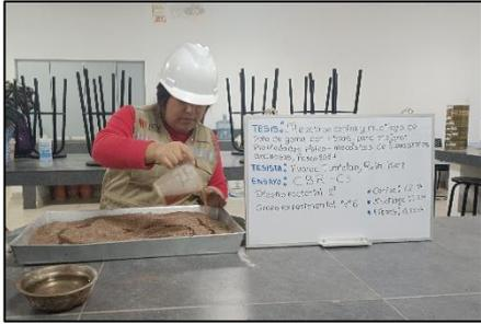
**Imagen 1.** Mezcla de los aditivos con la muestra.
