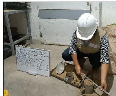
**Imagen 6.** Nivelación de la muestra compactada sin el collarín.
