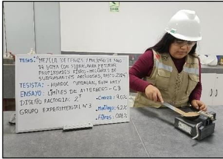
**Imagen 1.** Colocación de la muestra hacia la copa de Casagrande.
