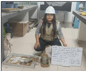
**Imagen 5.** Muestra compactada, luego se procede a retirar el collarín.
