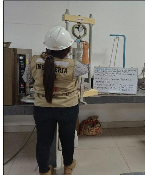
Figura 27. Ensayo CBR
