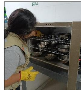
**Imagen 6.** Secado de las muestras a través del horno.
