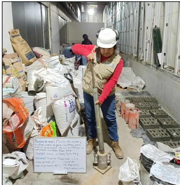
*Figura 24. Compactación del proctor modificado*
