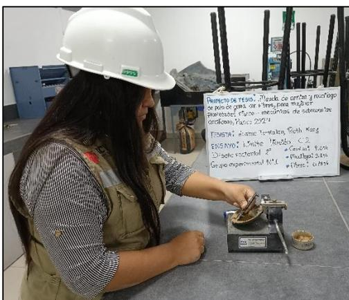
*Figura 20. Ensayo del límite líquido*
