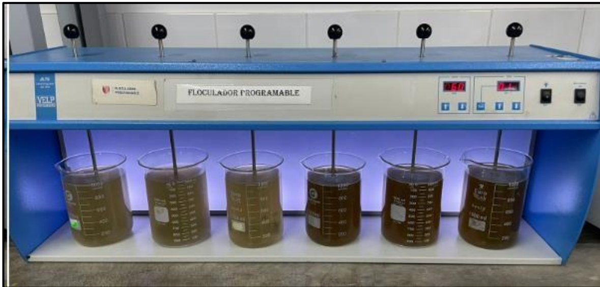
FIGURA 12. Corrida experimental haciendo uso del floculador Velp
