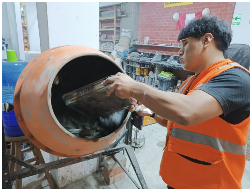
Foto 04: Adición de ceniza de cáscara de arroz al concreto.
