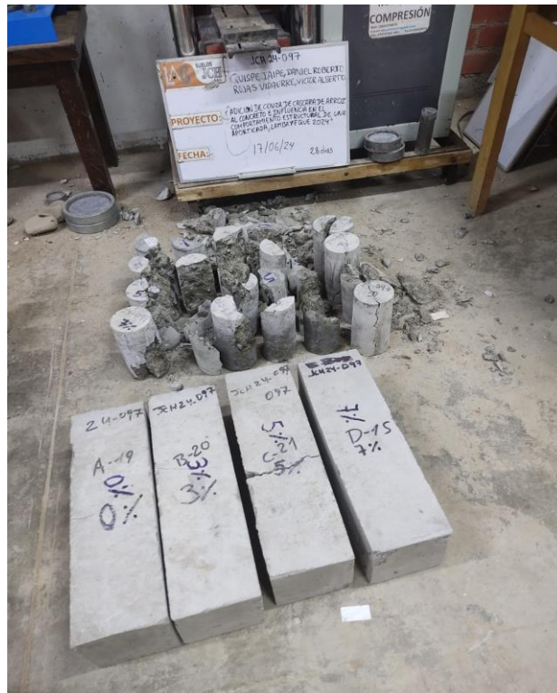
Foto 12: Rotura de especímenes de concreto a los 28 días
