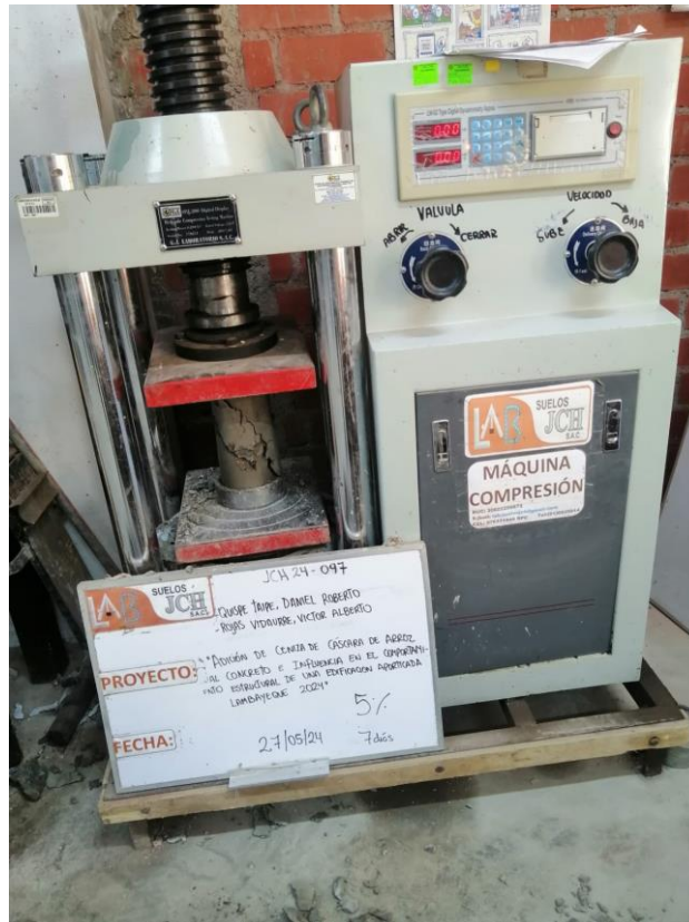
Foto 09: Rotura de probetas.
