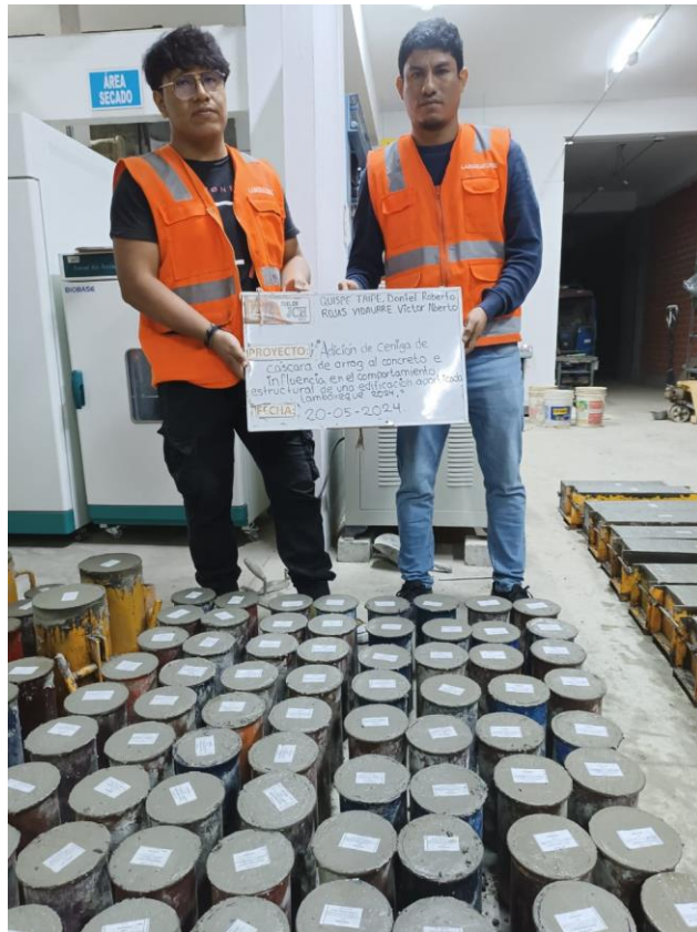
Foto 07: Vaciado de 36 probetas
