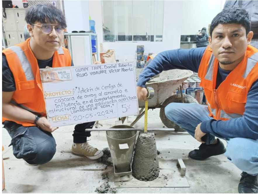
Foto 05: Ensayo de consistencia del concreto, con adición del 5% CCA.
