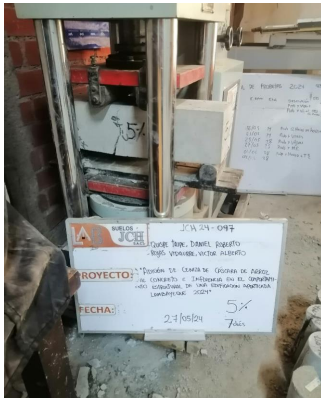
Foto 10: Rotura de viguetas.
