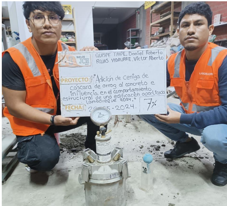
Foto 06: Determinación del contenido de aire del concreto con el 7% de adición de CCA.
