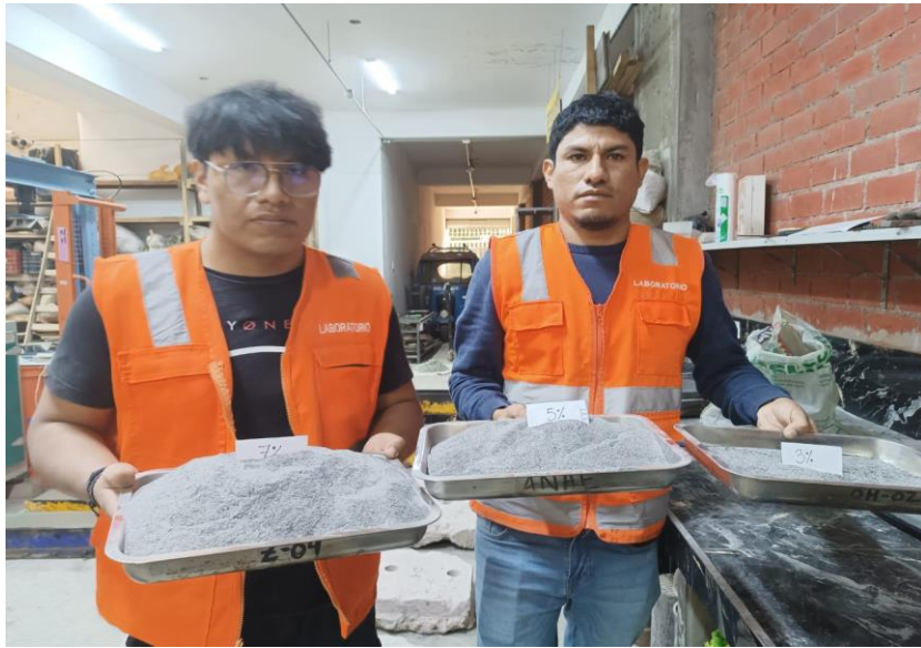
Foto 01: Se muestra las cenizas de cáscara de arroz en porcentajes de 7%, 5% y 3%.
