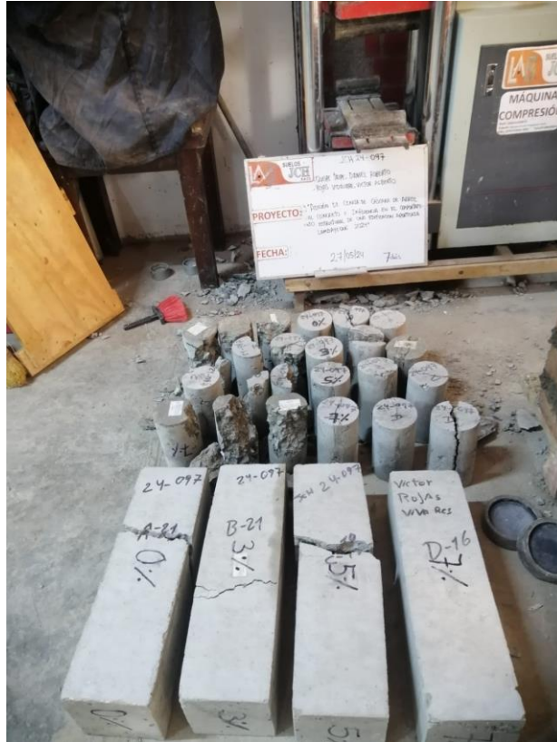
Foto 11: Rotura de especímenes de concreto a los 7 días
