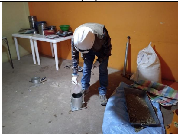
Figura 18. Se utiliza papel parafinado para realizar el ensayo de Proctor modificado. Elaboración propia.
