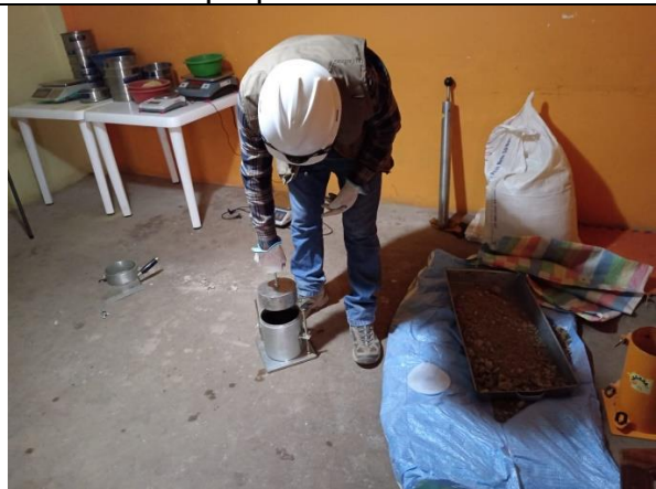
Figura 17. Se inicia con el ensayo de Proctor modificado. Elaboración propia.
