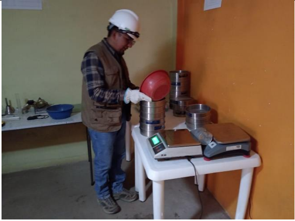
Figura 9. Tamizado para el ensayo de granulometría. Elaboración propia.
