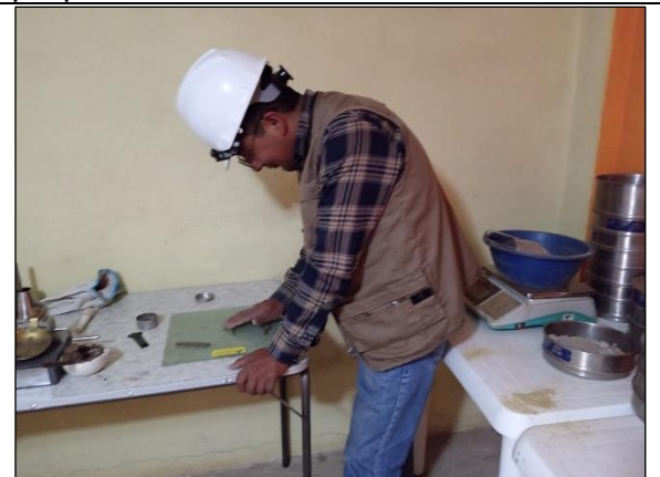
Figura 14. Se realiza la preparación de filamentos para determinar el límite
