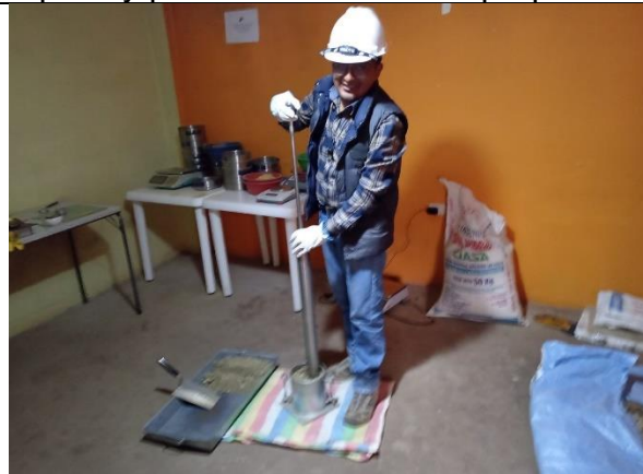
Figura 16. Se realiza la prueba de CBR con material patrón y adicionado al 5% y 10%. Elaboración propia.
