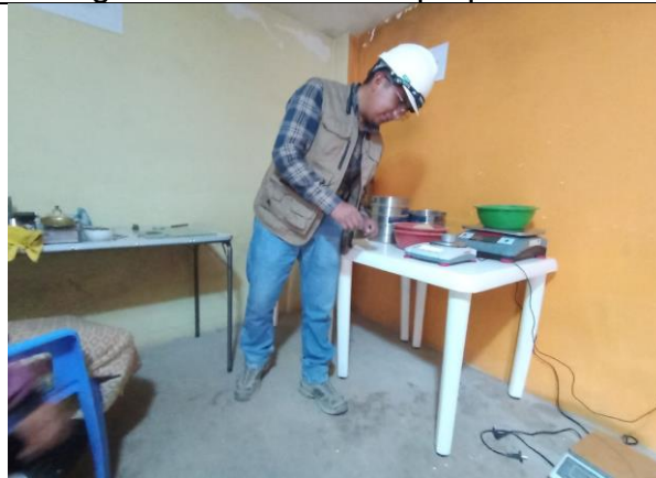
Figura 15. Pesaje de filamentos para el estudio de límite líquido y plástico. Elaboración propia.
