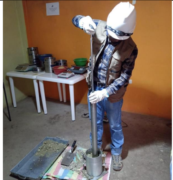
Figura 22. Se realiza el ensayo de Proctor modificado con la adición de material adicionado con un 5% y 10%. Elaboración propia.
