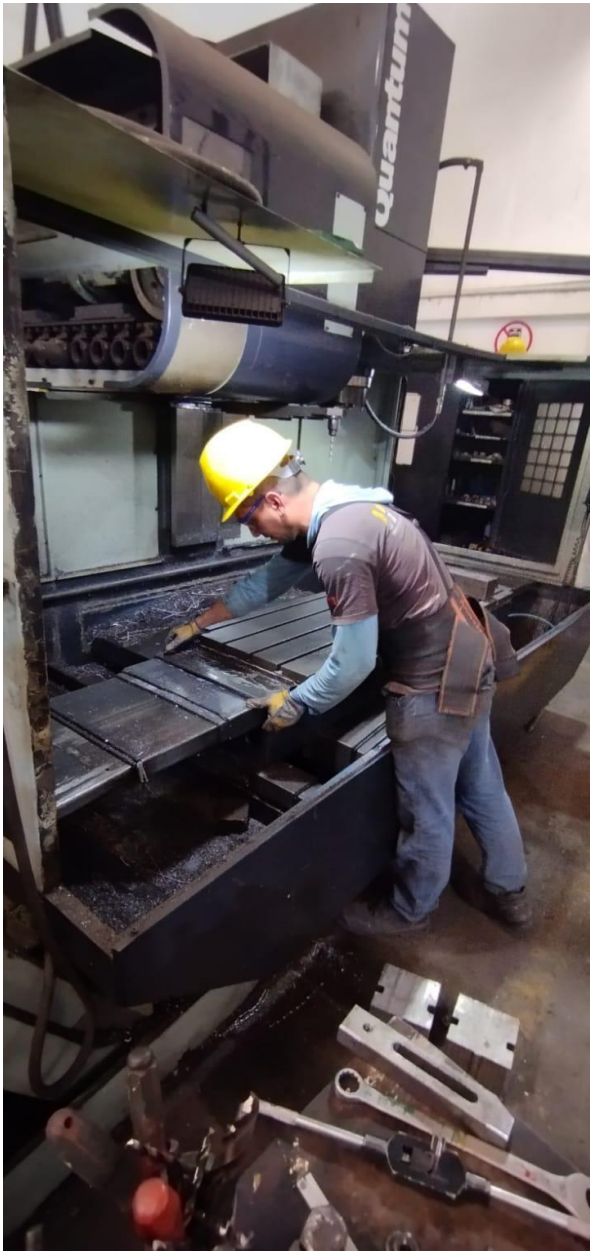
(a) Revisión de las guardas maquina Kasuga
