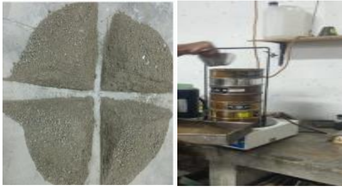
Figura 3: Cuarteo y tamizado de agregado fino
