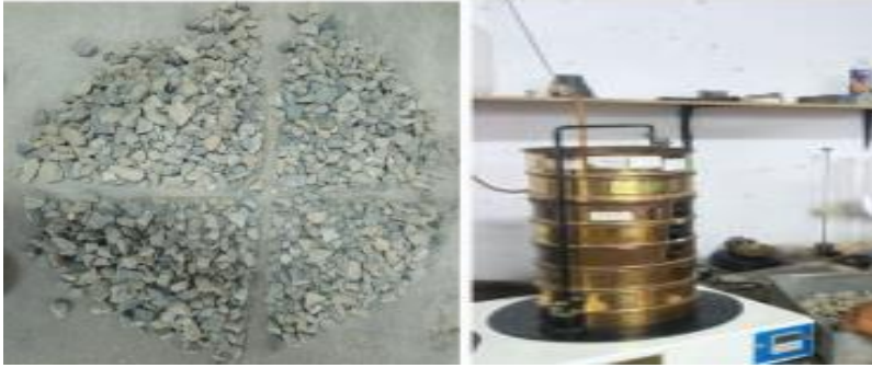
Figura 5: Cuarteo y tamizado de agregado grueso
