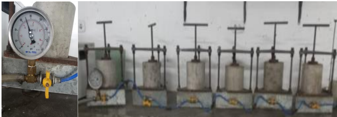
Figura 12: ensayo de profundidad de penetración de agua bajo presión
